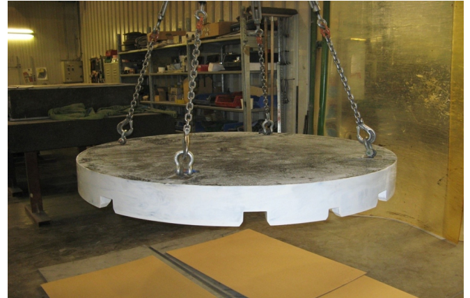
Fot. 2. Pokrywa do zbiornika na odpady radioaktywne wykonana z kompozytu Fe/epoksyda z dodatkiem boru (moderator). Materiał zbiornika skutecznie pochłania zarówno neutrony, jak i promieniowania gamma.
