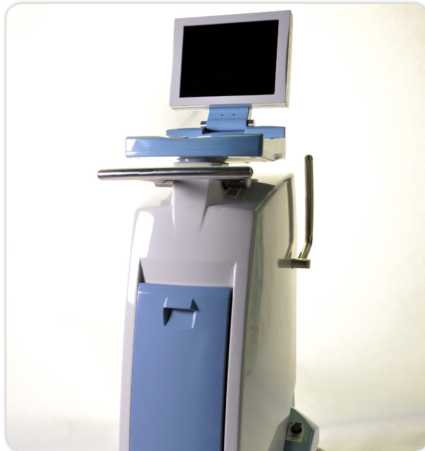
Prototyp przenośnego sterownika pulsacyjnych pomp wspomaganie serca Religa Heart PDU 402.
