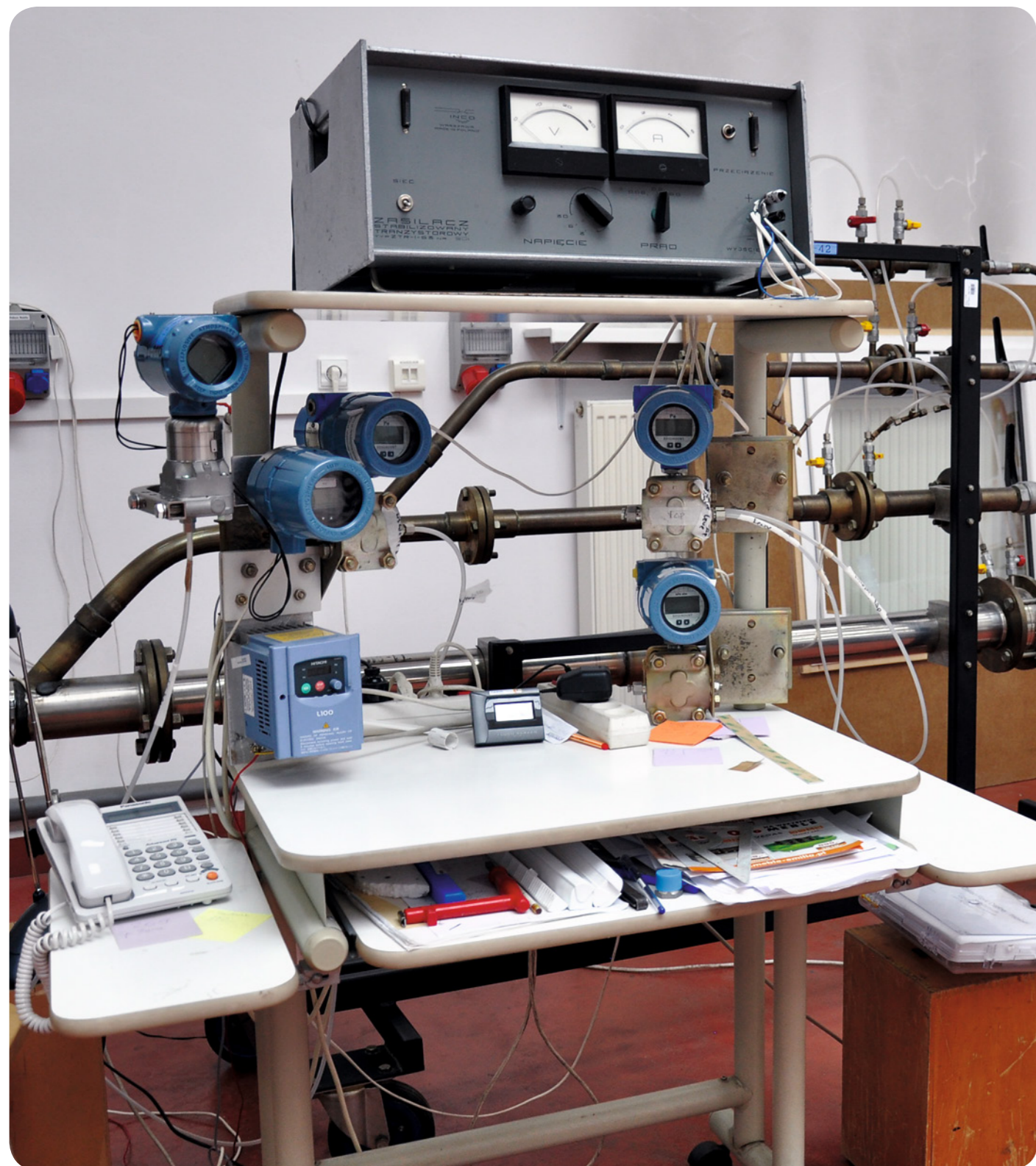
Stanowisko do badań przepływów w instalacjach wentylacyjnych.
