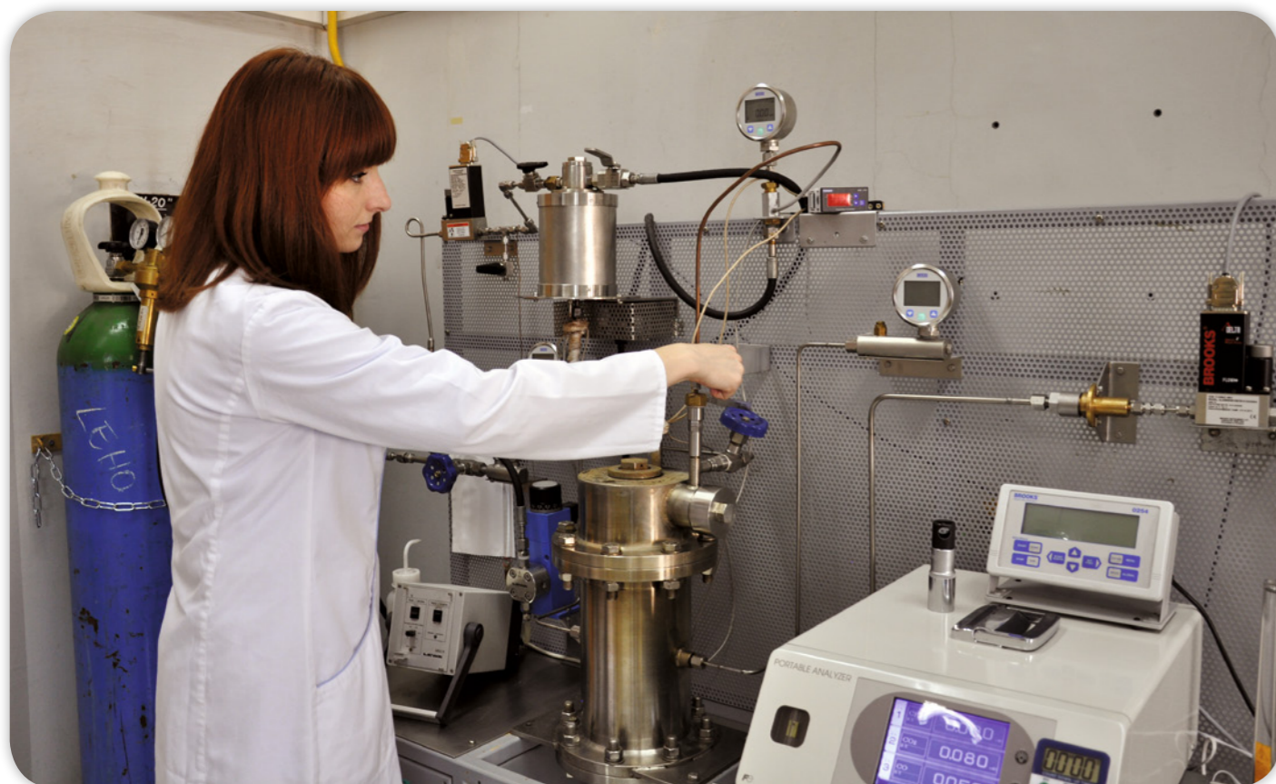
Instalacja laboratoryjna zgazowania i pirolizy węgla,
