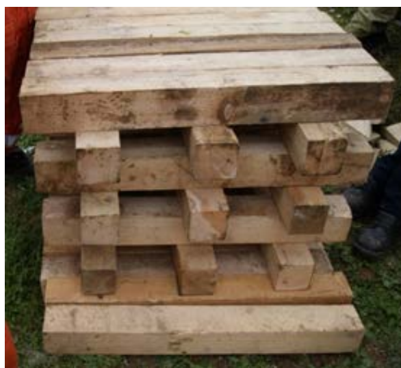
Fot. V. 5. Podpora typu „bezgwoździowego” – platforma robocza
