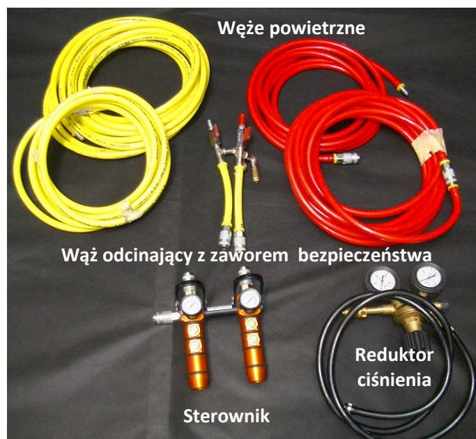
Fot. II. 16. Osprzęt do zasilania z butli sprężonego powietrza
