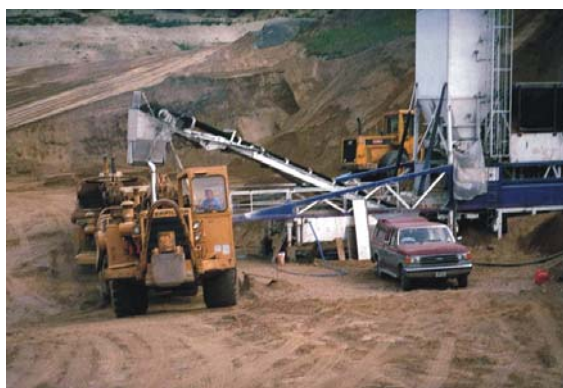
Fot. 2.15. Zestaw typowego węzła mieszalniczego
