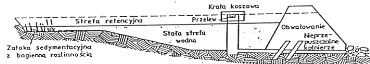
Rys. 2.7. Zbiornik retencyjny ze stałą strefą wodną wg [22]
