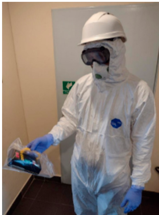
Fot. 1. Przyrządy pomiarowe używane w trudnych warunkach takie jak opady atmosferyczne, duże zapylenie w pobliżu odpadów przemysłowych, biologicznych itp. powinny być zabezpieczone workami strunowymi (fot. z archiwum SIOR)
