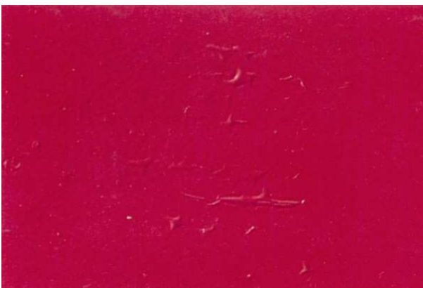
e) duże spęcherzenia powłoki powierzchniowej
