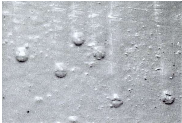
b) grube zacieki kończące się kroplami farby
