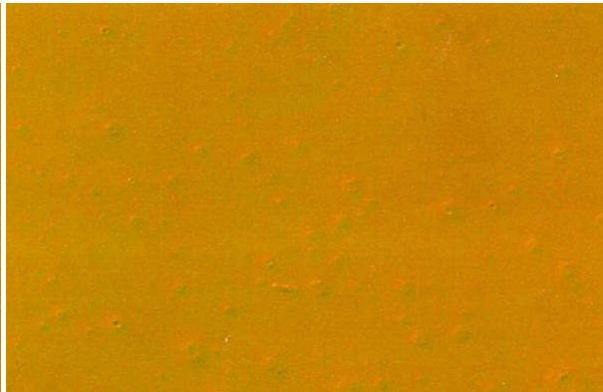
d) kratery przebijające powłokę do podłoża
