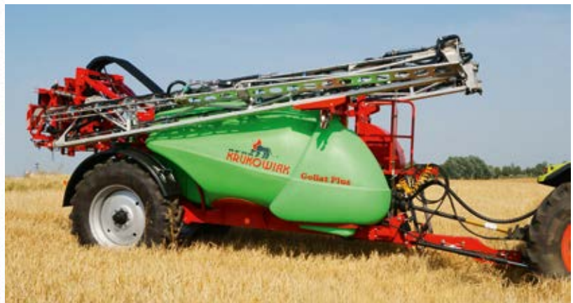
Przyczepiany opryskiwacz rolniczy GOLIAT PLUS P387 o pojemności zbiornika 2 500 l
