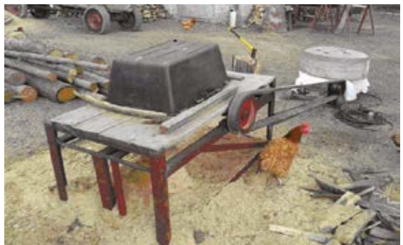
Brak osłon i zabezpieczeń pilarek tarczowych, bałagan wokół nich
