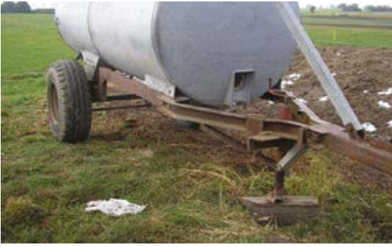
Nieprawidłowe zabezpieczenie maszyn i urządzeń podczas postoju i w ruchu
