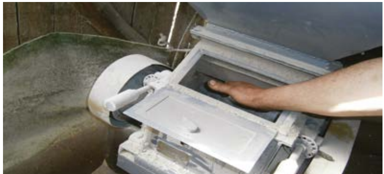
Usuwanie zapchań i regulowanie pracy maszyny przy włączonym napędzie
