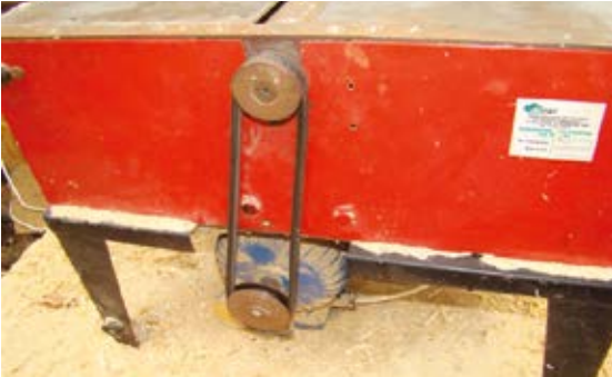
Brak osłon elementów ruchomych maszyn i urządzeń
