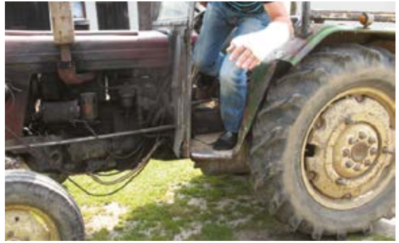
Niewłaściwy sposób schodzenia z ciągników i maszyn rolniczych, brak obuwia roboczego
