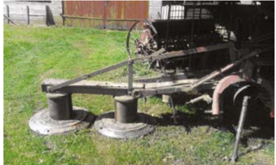
Brak osłon elementów ruchomych maszyn i urządzeń
