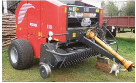
Nieprawidłowe zabezpieczenie maszyn i urządzeń podczas postoju i w ruchu
