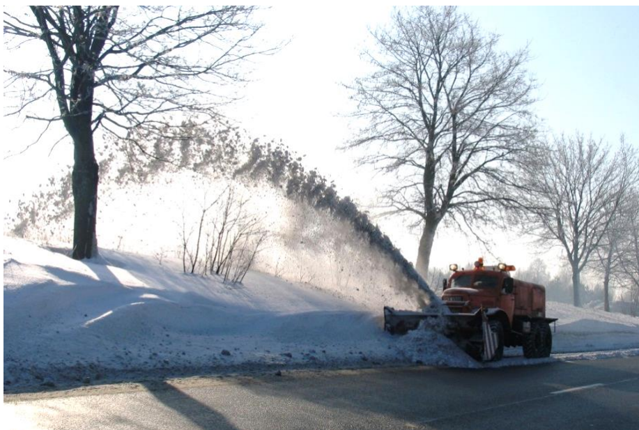
Fot. 4 Pług wirnikowy ZiŁ D470 – pojazd do zadań specjalnych, zostaje używany w sytuacjach ekstremalnych lub wówczas, gdy działania standardowego sprzętu są niewystarczające.
