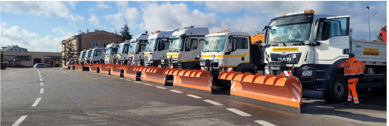
Fot. 3 Pojazdy przeznaczone do zimowego utrzymania dróg w Obwodzie Drogowym w Gdańsku Matarni uzbrojone w pługi odśnieżne i posypywarki wraz ze zbiornikami na solankę.
