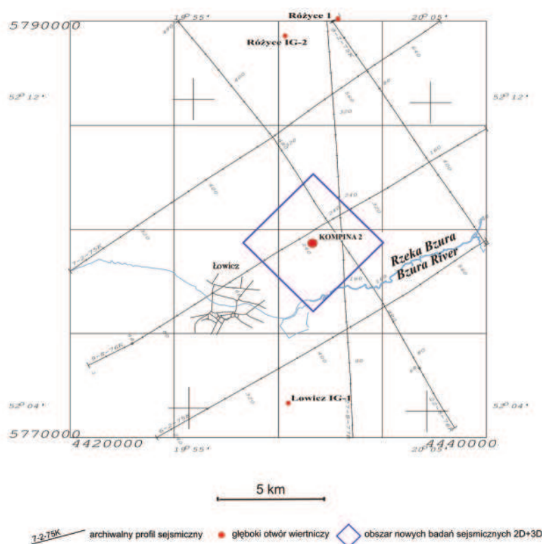
Ryc. 2.1. Szkic sytuacyjny wykonanych badań sejsmicznych 2D i 3D w rejonie odwiertu Kompina-2 i przebieg archiwalnych profili sejsmicznych
