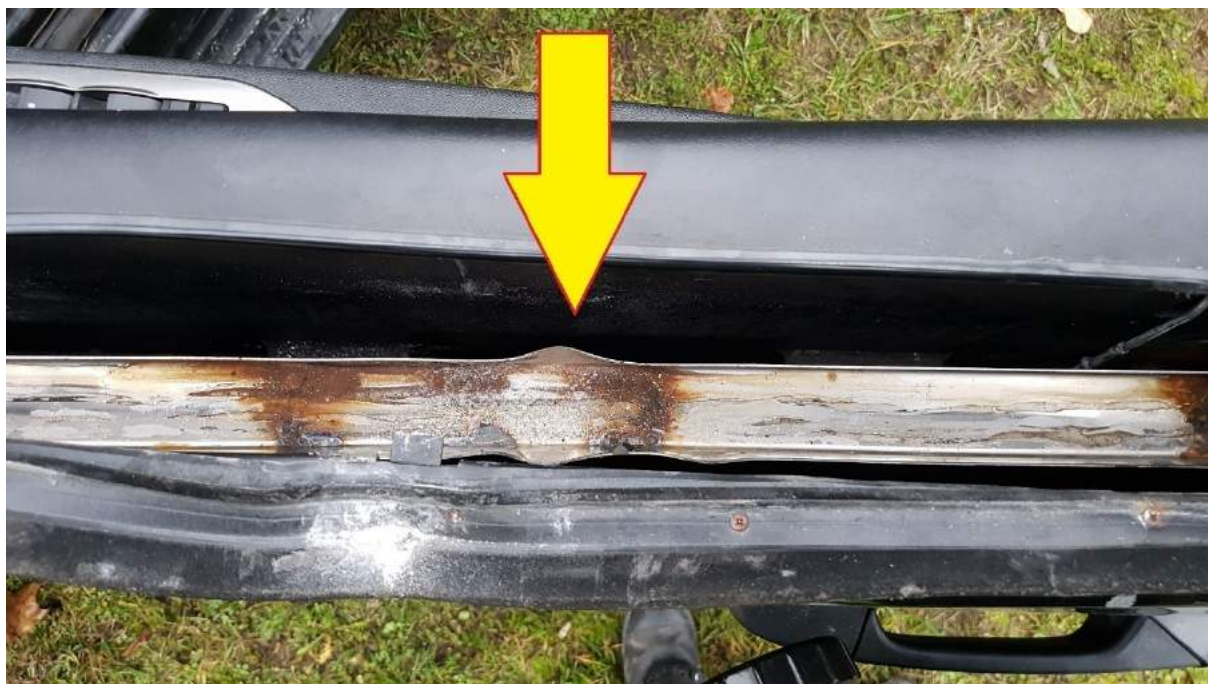
Rys. 447. Stalowe wzmocnienie w drzwiach
