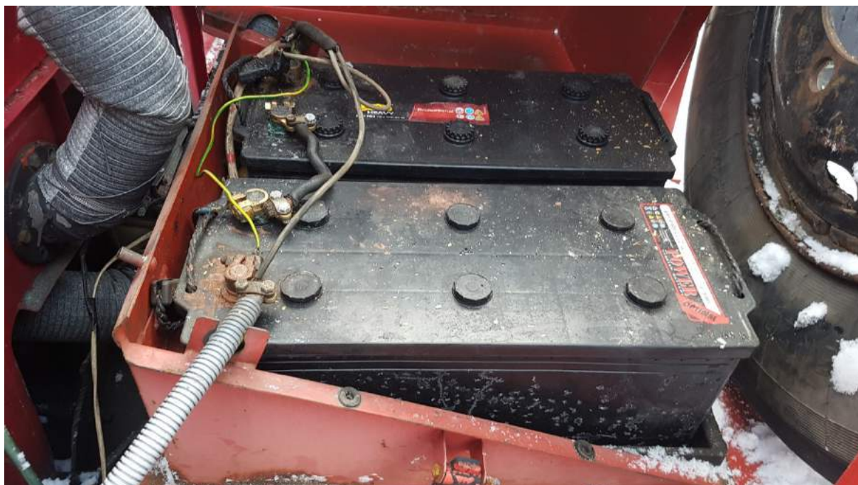
Rys. 92. Akumulatory umieszczone na ramie pojazdu, za kabiną
