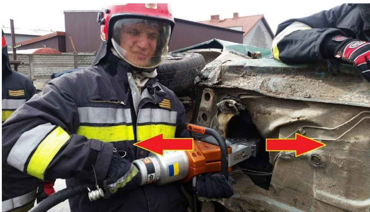
Rys. 222. Wykonanie otworu w podłodze rozpierczem. Drugi ruch jest zawsze prostopadły do pierwszego
