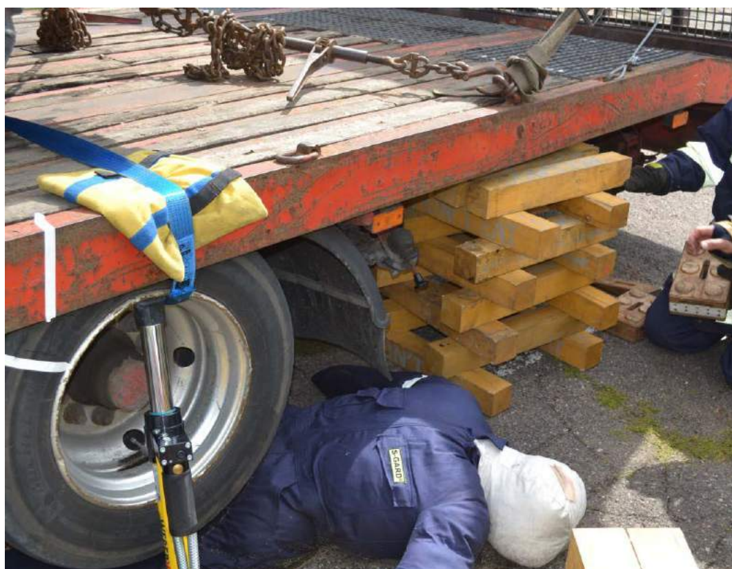
Rys. 384. Pchanie resorowania cylindrem rozpierającym wypartym o felgę z zastosowaniem odpowiedniej końcówki. Widoczna wysoka podbudowa ramy pojazdu, budowana na bieżąco
