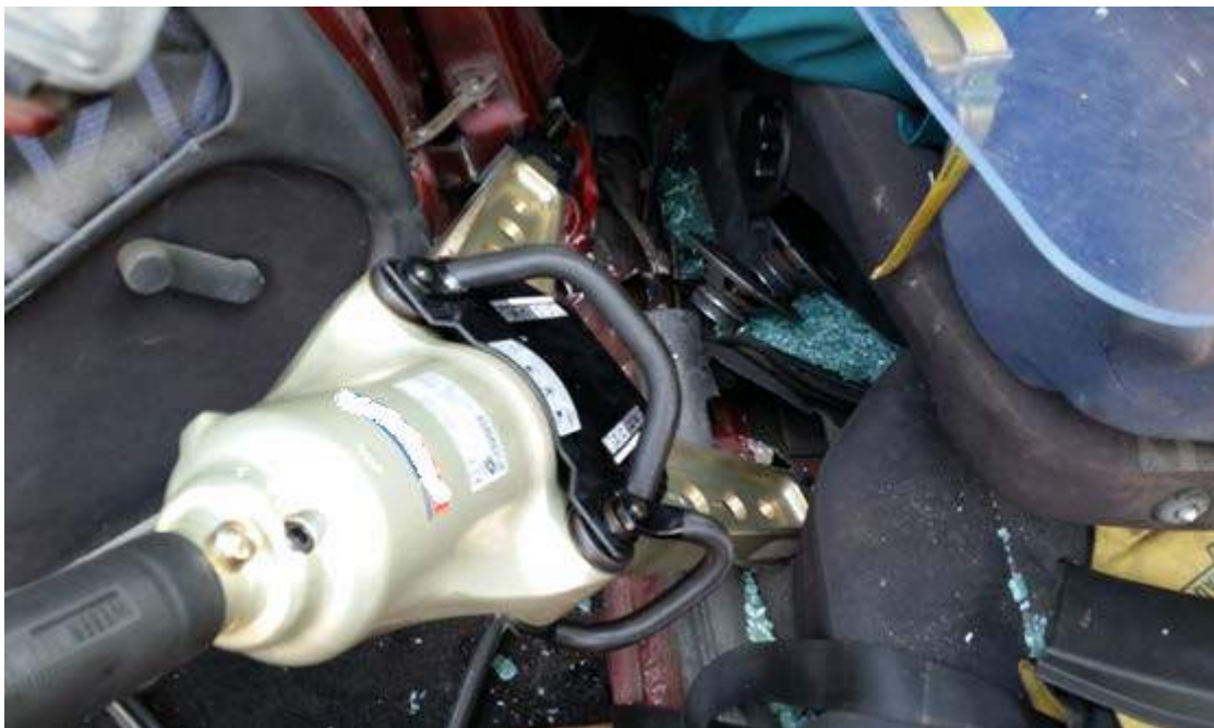
Rys. 255. Wyrwanie stópki C od progu przy pomocy rozpieracza
