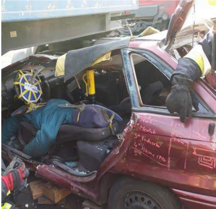
Rys. 360. Uzyskanie dostępu poprzez usunięcie całego boku pojazdu
