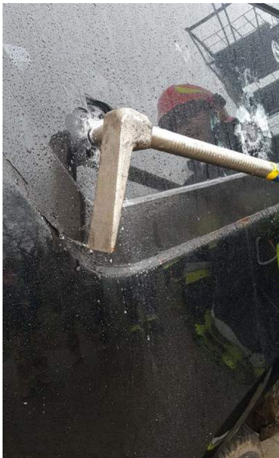
Rys. 462. Pełne przebicie szyby kolcem halligana we współpracy z młotem 5 kg
