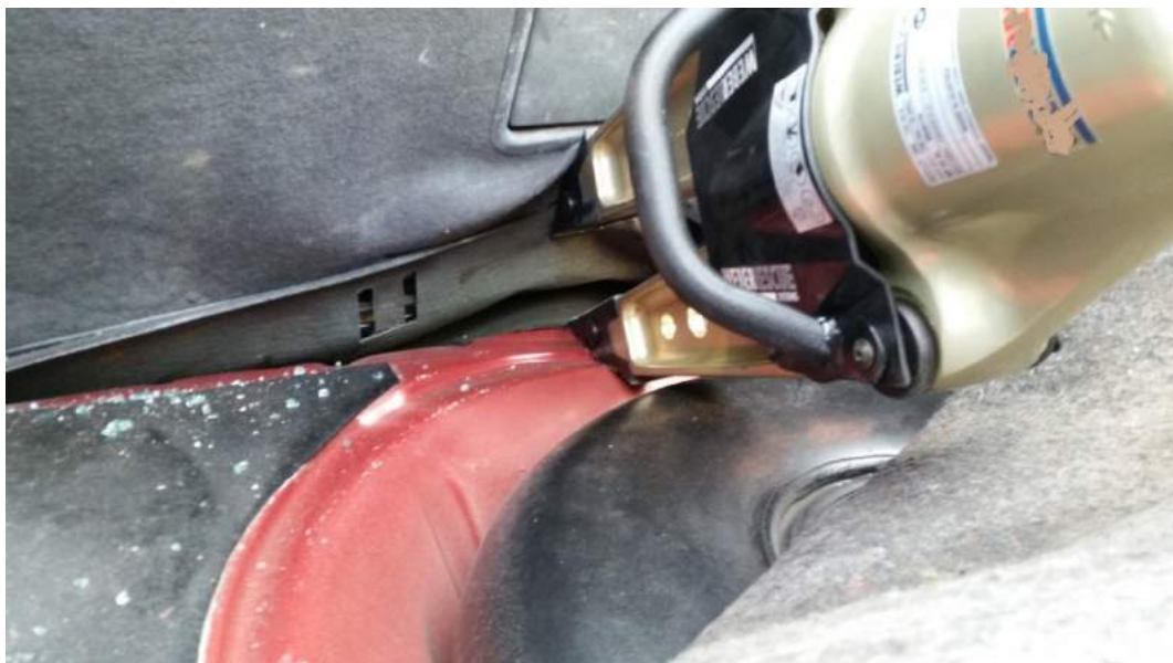
Rys. 278. Zerwanie punktów mocowania oparcia tylnej kanapy
