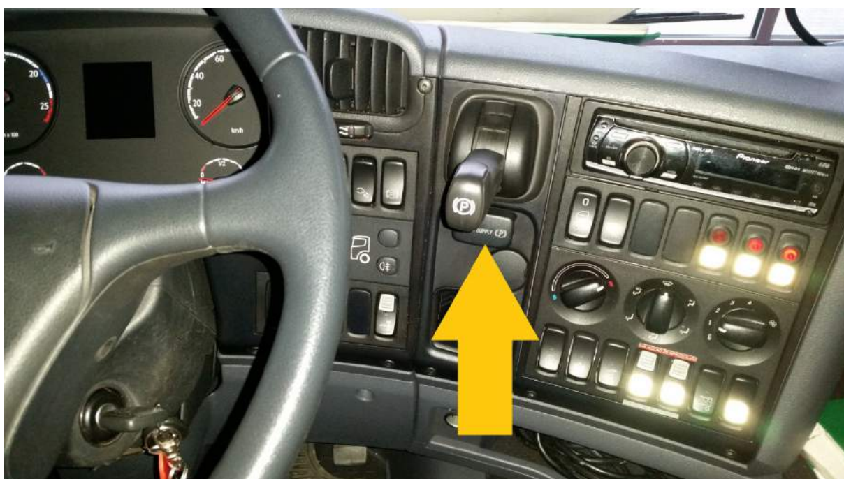
Rys. 103. Dźwignia hamulca postojowego na desce rozdzielczej
