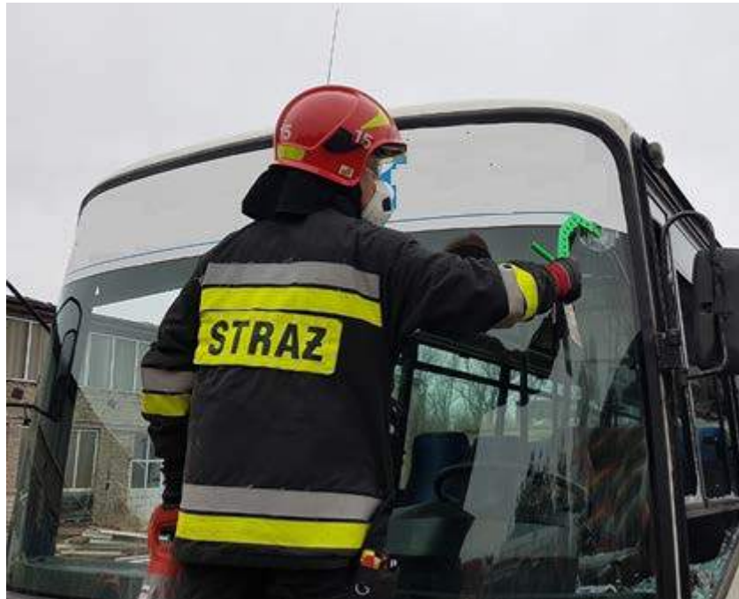
Rys. 397. Cięcie przedniej szyby klejonej przy pomocy piły do szyb
