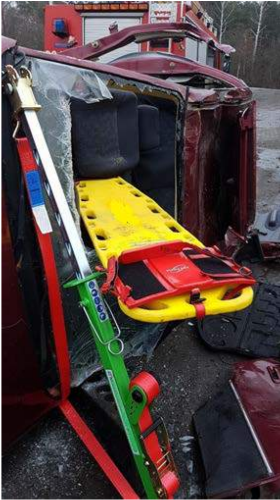
Rys. 300 A, B. Zabezpieczenie osoby poszkodowanej, wiszącej w pasach bezpieczeństwa
