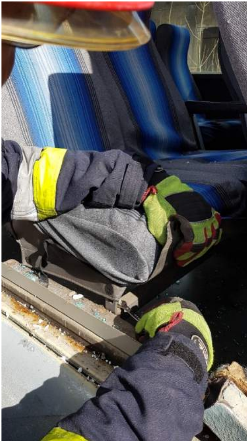
Rys. 423 A, B. Demontaż wewnętrznych elementów autobusu przy pomocy kluczy
