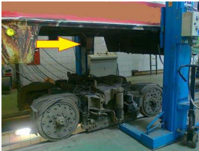
Rys. 426. Wózek jezdny i sworzeń wagonu Źródło: Jacek Gawroński, SA PSP Poznań
