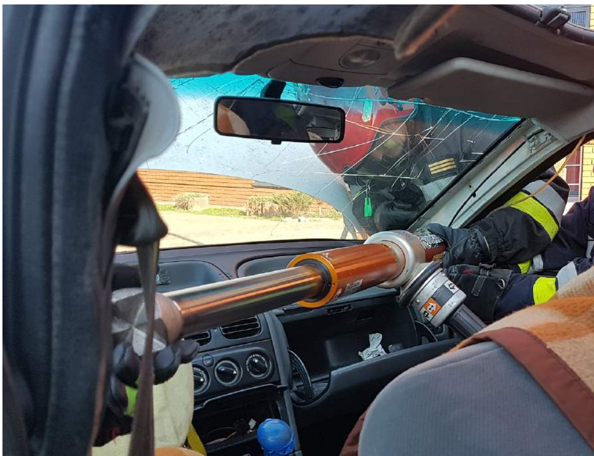
Rys. 231. Cross-ramming wykonywany między słupkami A-C. Na wybór przyłożenia narzędzia wpływa pozycja osoby poszkodowanej. Widoczna asekuracja cylindra rozpierającego przed opadnięciem na osobę poszkodowaną
