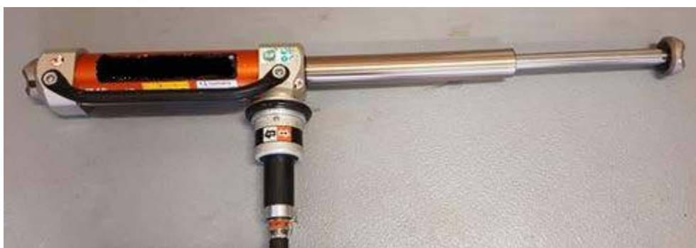
Rys. 18. Cylinder rozpierający teleskopowy dwustopniowy
