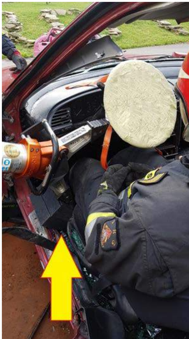
Rys. 197. Skrócenie odległości między progiem, a kolumną kierownicy przez zastosowanie podbudowy Uwaga: zdjęcie pokazuje sytuację po zakończeniu ruchu narzędzia. Podczas jego wykonywania wymagany jest pewny uchwyt narzędzia w celu asekuracji
