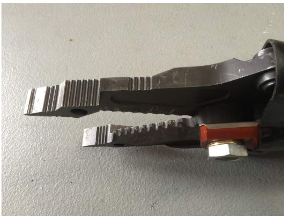
Rys. 30. Charakterystyczne szczęki narzędzia COMBI
