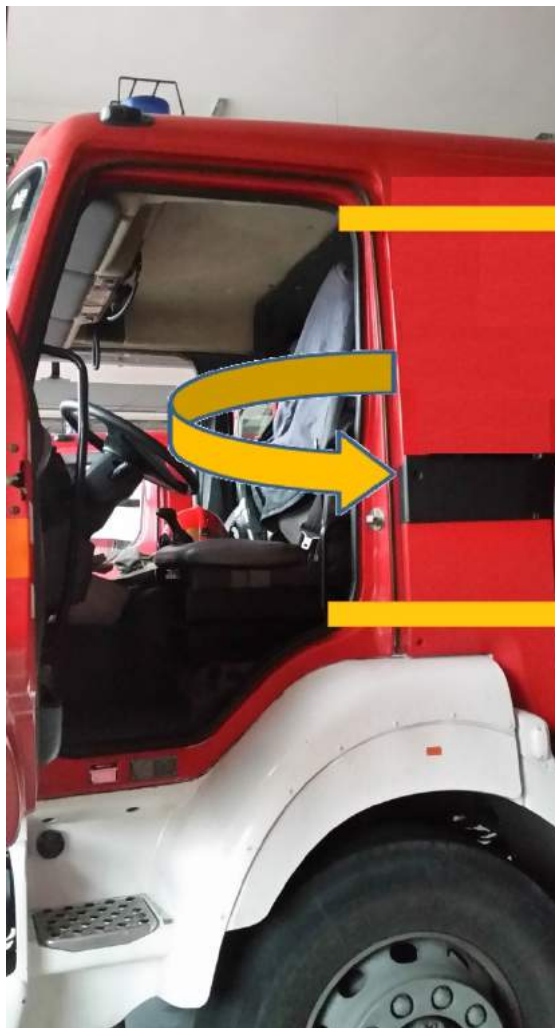
Rys. 347. Zaznaczone miejsca cięcia oraz kierunek odgięcia
