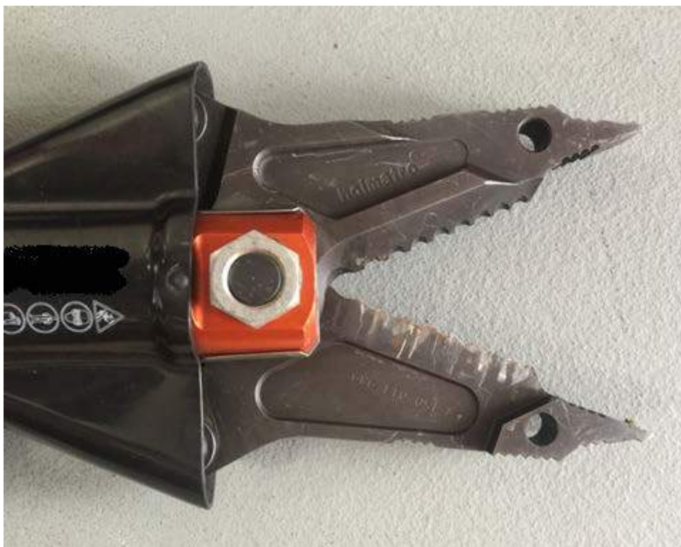
Rys. 29. Charakterystyczne szczęki narzędzia COMBI
