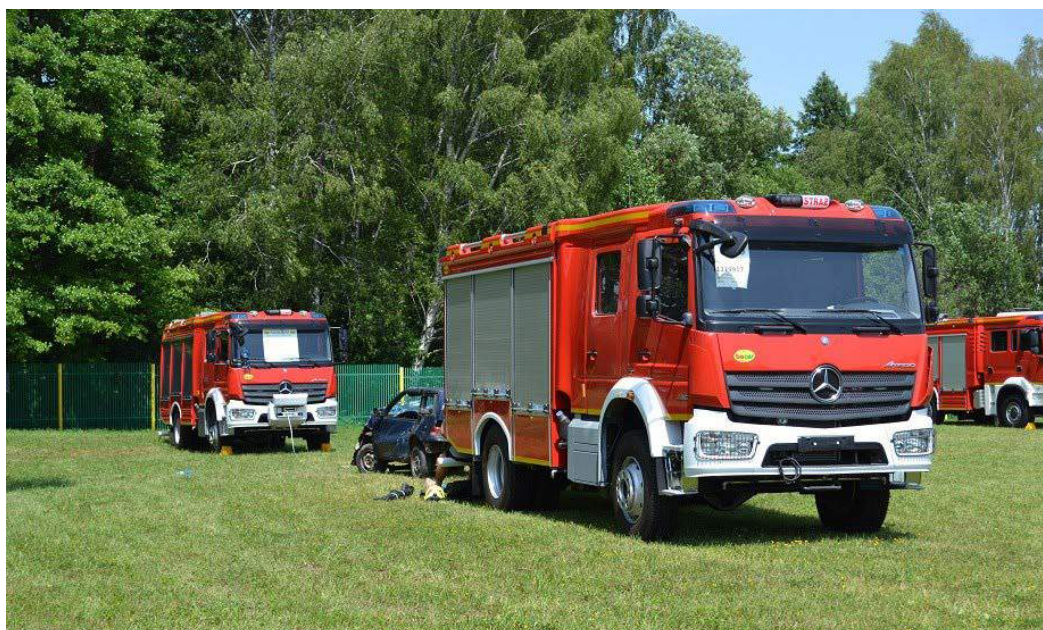
Rys. 435. Wyciągnięcie wraku w osi między dwoma pojazdami ratowniczymi
