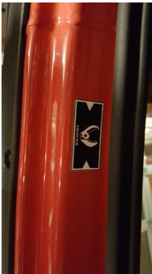
Rys. 136. Oznaczona strefa bezpiecznego cięcia słupka
