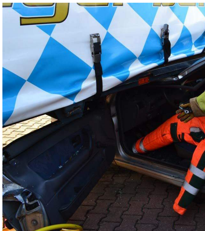
Rys. 359. Szeroki dostęp do uszkodzonego po wyważeniu drzwi i obcięciu ich ramek
