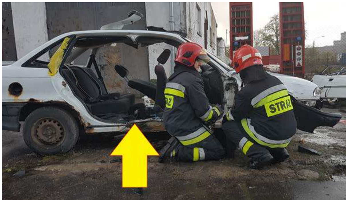
Rys. 257. Przestrzeń uzyskana po usunięciu boku pojazdu
