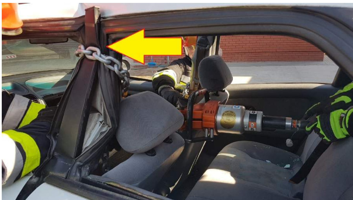
Rys. 470. Krok 2: montowanie łańcucha od zgniatanej strony, na przy dachu. Powonienie czynności
