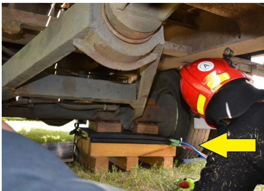
Rys. 378. Podnoszenie naczepy z małej podbudowy umieszczonej pod resorowaniem
