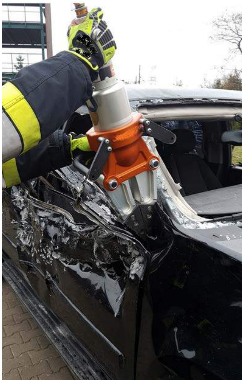
Rys. 456. Usunięcie drzwi od strony zawiasów. Szczelinę do wyrwania drzwi uzyskano poprzez odgięcie górnej ramki drzwi
