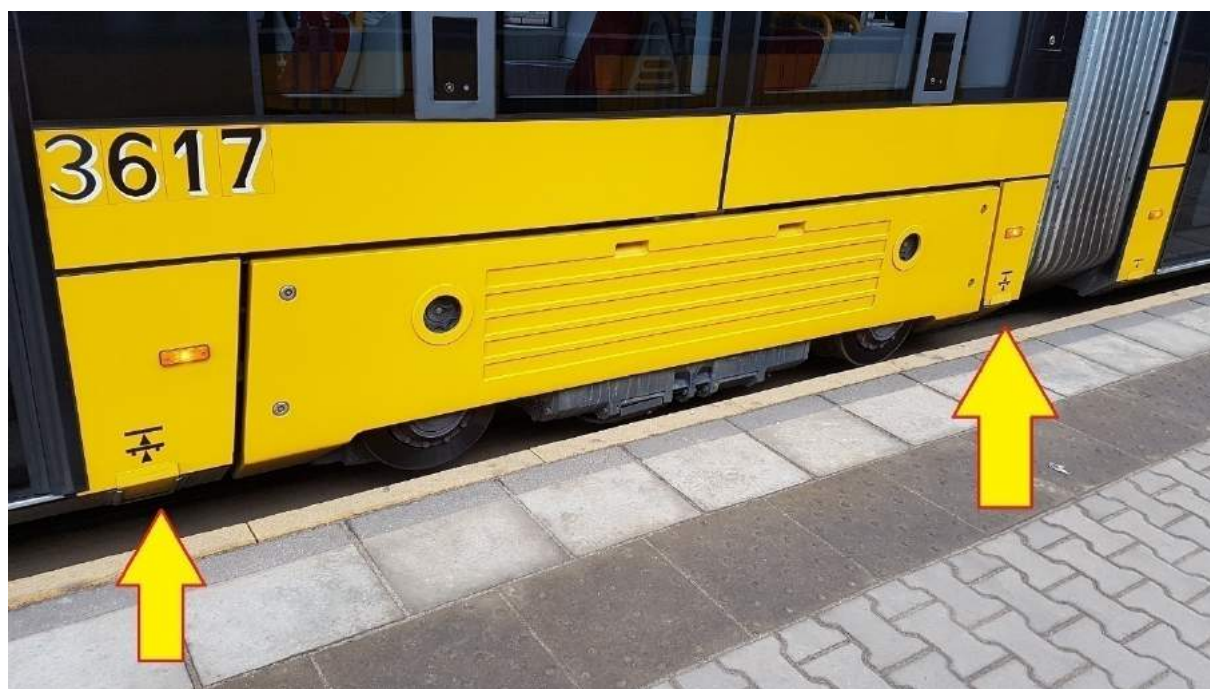
Rys. 428. Zaznaczone punkty do podnoszenia wagonu
