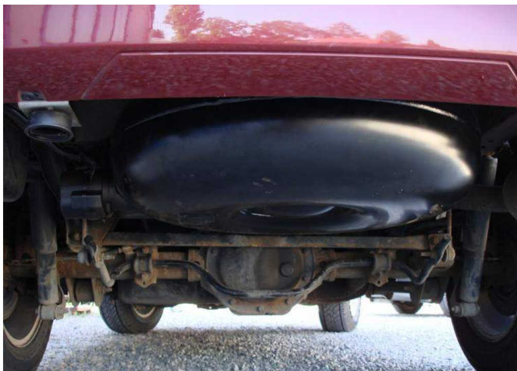
Rys. 70. Zbiornik toroidalny, umiejscowiony pod pojazdem Źródło: http://autogazaries.pl/jeep-liberty-3-7-211km,587
