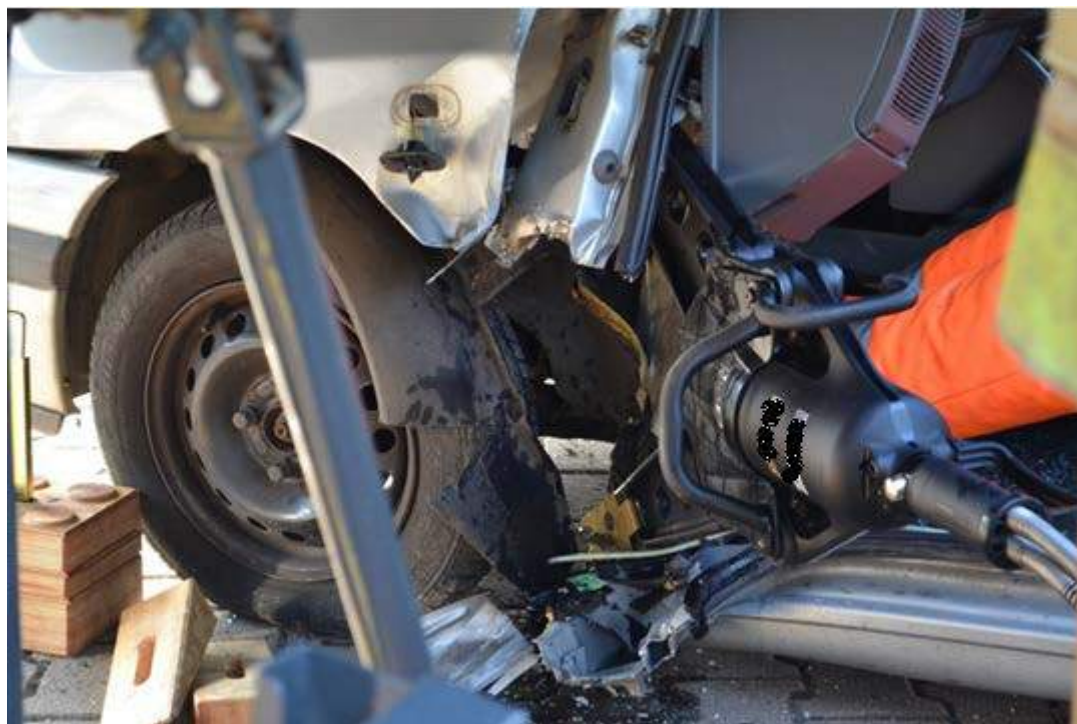
Rys. 363. Wyparcie nacięcia rozpieraczem. Podłoga opuszczona do ziemi
