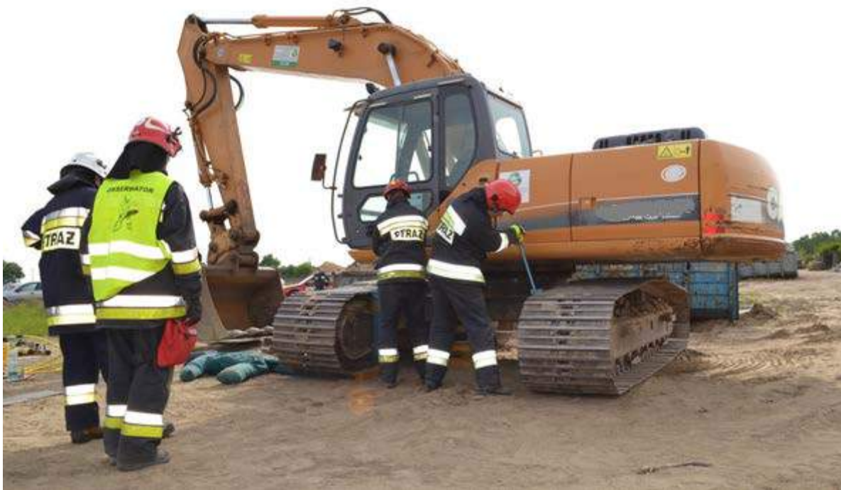
Rys. 388. Podnoszenie całości pojazdu i równolegle dwóch gąsienic
