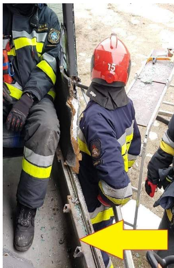
Rys. 395. Dokładne oklejenie szyb pozwala usunąć rozbite szkło na zewnątrz pojazdu
