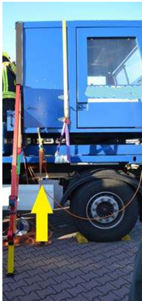
Rys. 352. Stabilizacja kabiny poprzez zamocowanie pasa z dwóch stron pojazdu. Pas mocujemy do ramy oraz w pewny punkt u dołu kabiny. Na zdjęciu widoczne trzy możliwości stabilizacji kabiny
