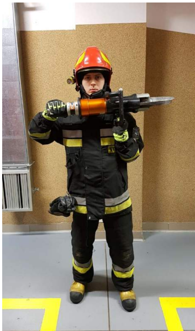
Rys. 34. Trzymanie narzędzia przy podwyższonej pracy narzędzia
