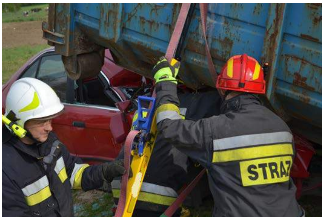
Rys. 364. Stabilizacja boczna kontenera
