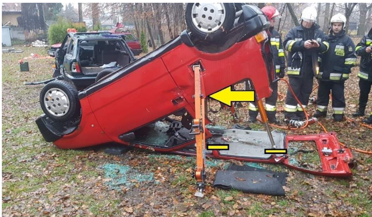
Rys. 310. Punkt mocowania pasa podpory nie może znajdować się między dachem, a miejscem cięcia. Nie będzie to powodowało rozbrojenia stabilizacji
