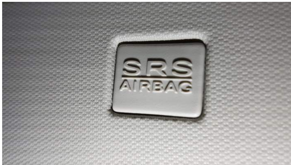
Rys. 64. Oznaczenie miejsca występowania poduszki bezpieczeństwa
