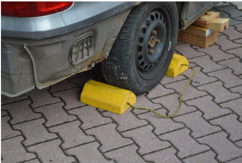
Rys. 157. Zabezpieczenie przed tocenieniem wykonane na jednym kole przy pomocy prostego urządzenia – przejrzysta kontrola prawidłowości wykonania
