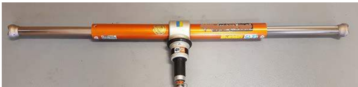
Rys. 17. Cylinder rozpierający dwutłokowy
