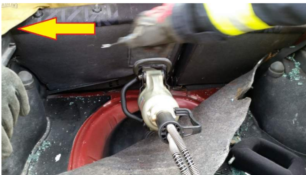
Rys. 279. Zerwanie punktów mocowania oparcia tylnej kanapy przy jednoczesnym odpięciu oparcia z górnych zamków
