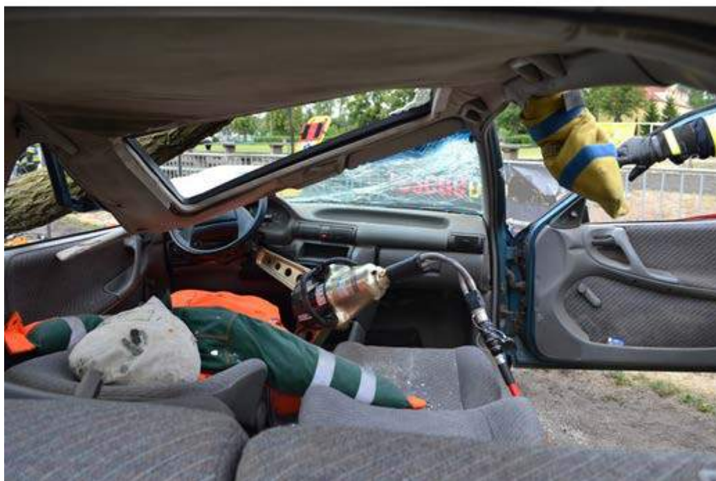
Rys.327. Wyparcie kolumny kierownicy od strony nieuszkodzonej. Całkowity brak dostępu przez drzwi od strony zgniecionej. Pełny dostęp boczny. Przygotowanie do tunelowania
