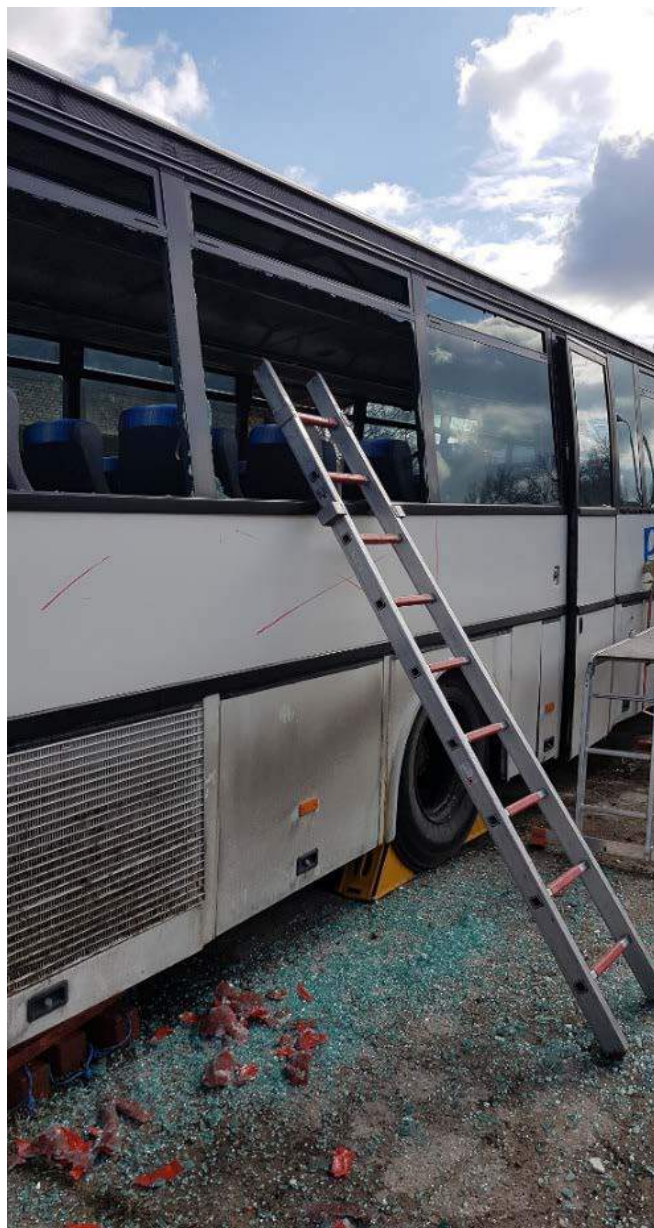
Rys. 399. Przestrzeń uzyskana po usunięciu okna
