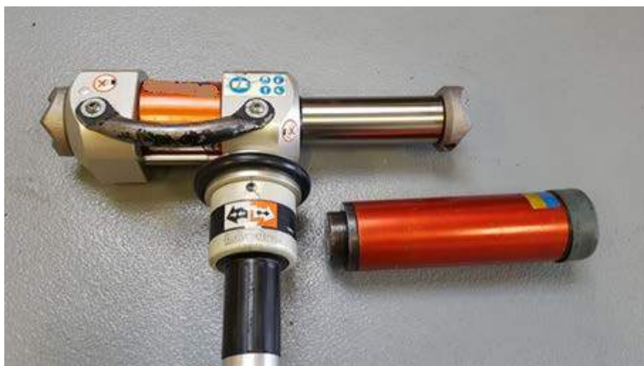
Rys. 16. Cylinder rozporający jednorodkowy z przedłużką
