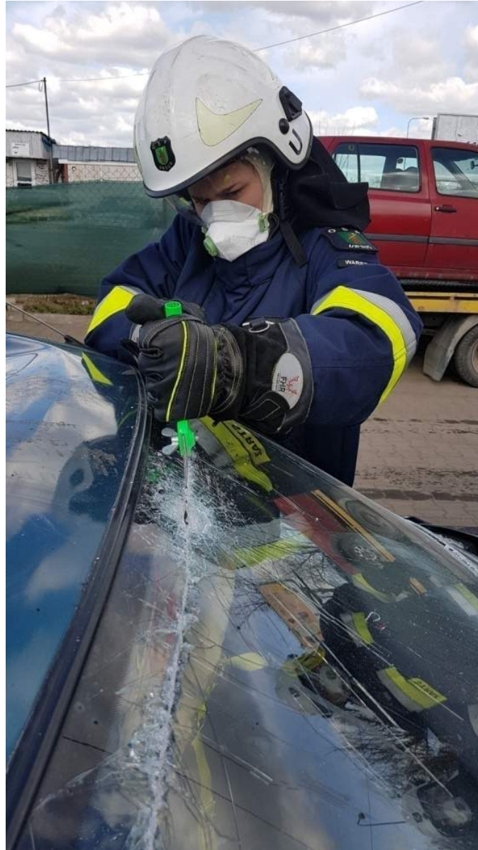
Rys. 178. Świadomy zagrożen ratownik przygotowany do działań z szybami samochodowymi: pełna ochrona oczu, maska pyłowa
