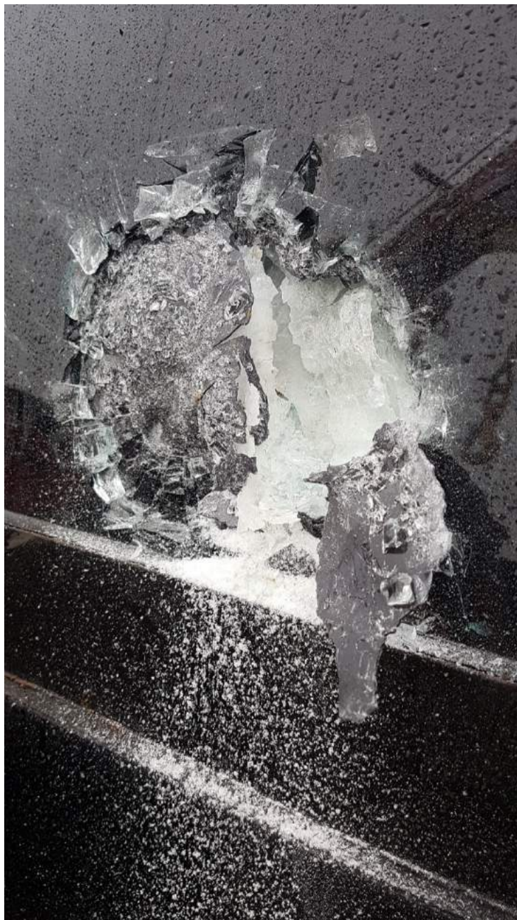
Rys. 461. Efekt kilkunastu uderzeń młotem 5 kg
