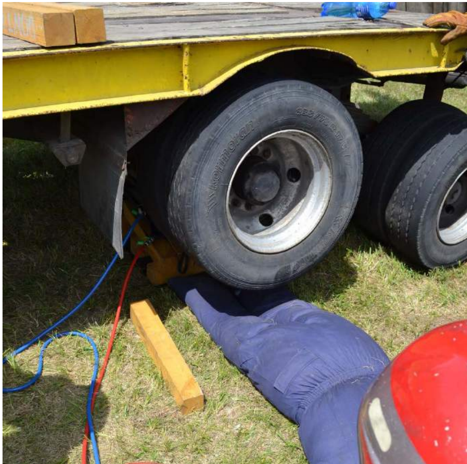
Rys. 379. Efekt podniesienia z małej podbudowy umieszczonej pod resorowaniem
