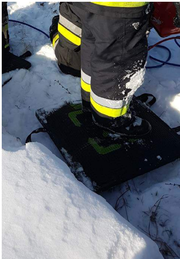
Rys. 49. Prezentacja dużej stabilności poduszki podnoszącej płaskiej
