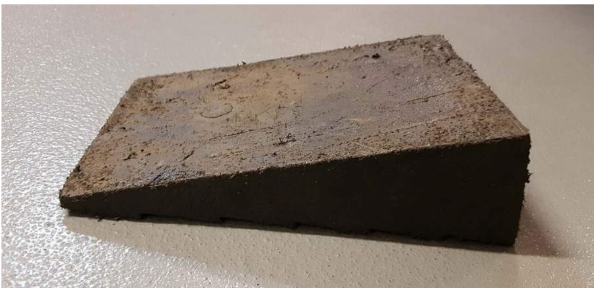
Rys. 153. Klin stroną z zębami osadzamy na gruncie lub śniegu
