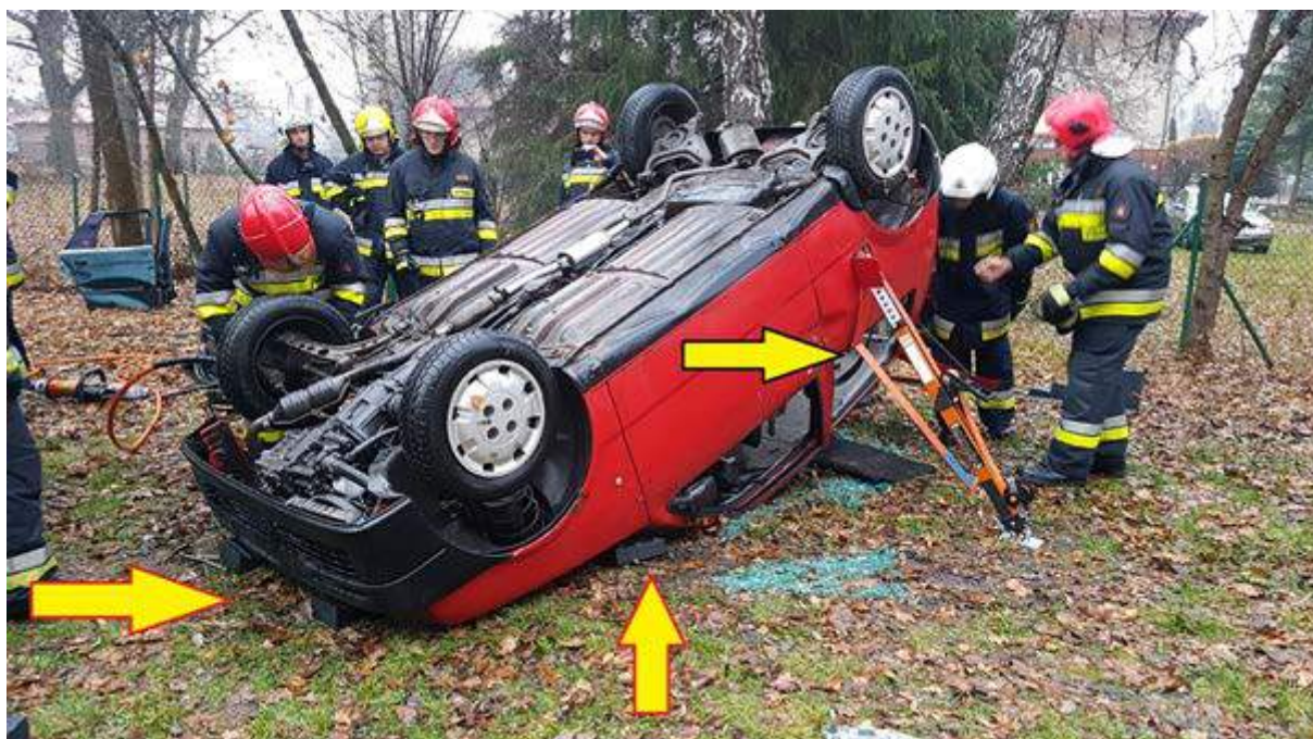
Rys. 309. Widoczna stabilizacja klinami w osi pojazdu, podbudowa w okolicach słupka A oraz wysoko umiejscowiony punkt mocowania pasa podpory szybkiej stabilizacji
