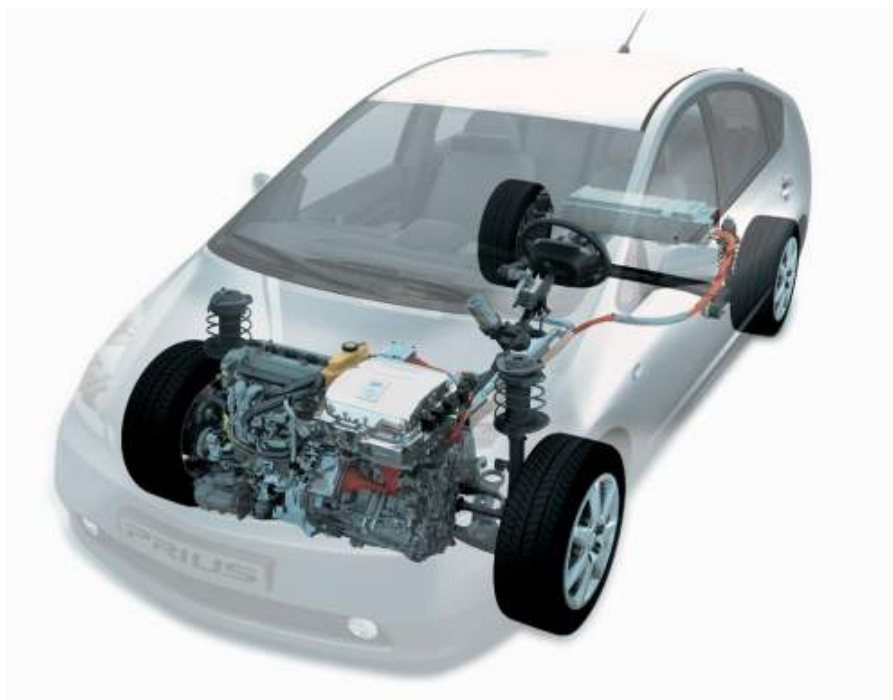
Rys. 77. Układ hybrydowy na przykładzie Toyoty Prius
