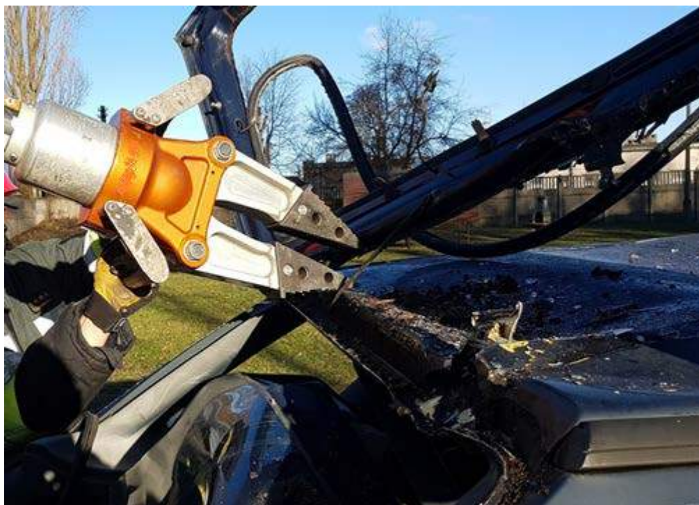
Rys. 277. Całkowite oderwanie klapy bagażnika przy pomocy rozpieracza
