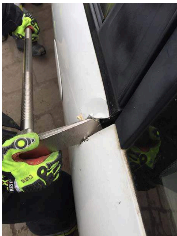
Rys. 245 A, B. Powiększanie szczeliny przez obrót narzędzia
