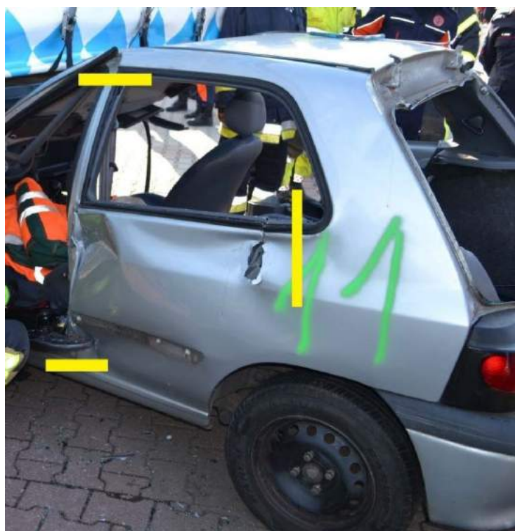
Rys. 270. Zaznaczone miejsca cięć w metodzie „trzech drzwi”. Tu cięcia wykonywane nożycami hydraulicznymi
