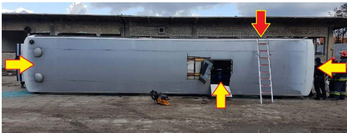
Rys. 415. Autobus na boku. Możliwe wejścia: przednią i tylną szybą, włazami dachowymi. Dokładniejsze rozpoznanie sytuacji wewnątrz od góry, z drabin przystawnych
