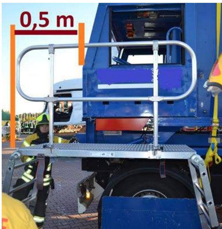
Rys. 335. Odpowiednie wysunięcie podestu poza przedni obrys kabiny
