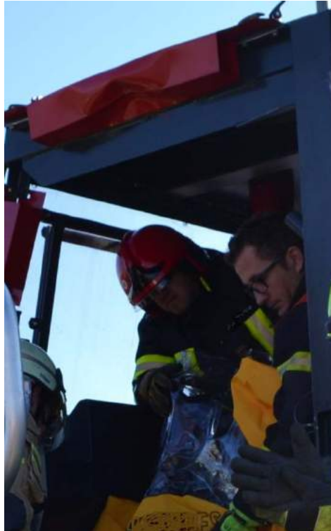
Rys. 343. Przestrzeń uzyskana po wypchnięciu przodu kabiny cylindrem rozpierającym
