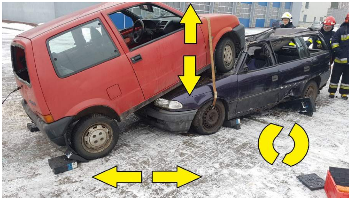
Rys. 177. Zabezpieczenie układu pojazdów
