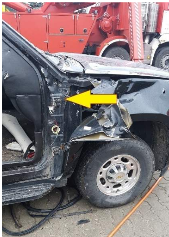
Rys. 457. Usunięcie drzwi od strony zawiasów. Szczelinę do wyrwania drzwi uzyskano również poprzez odgięcie nadkola
