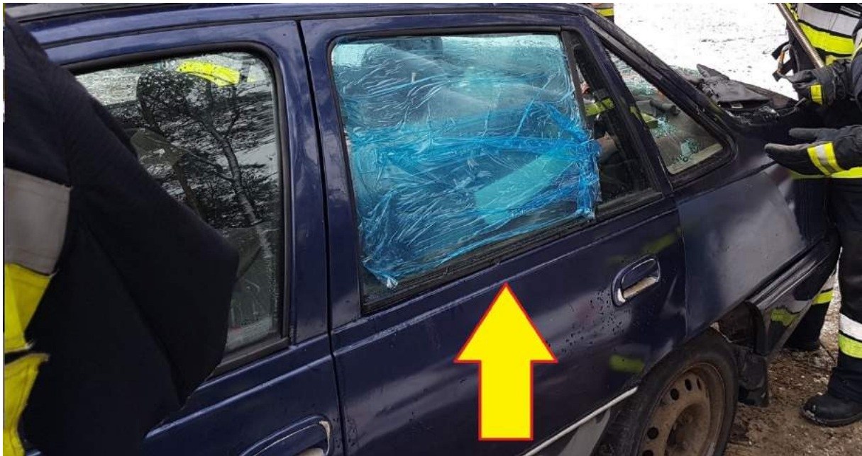
Rys. 190. Oklejenie szyby przylegającą folią
