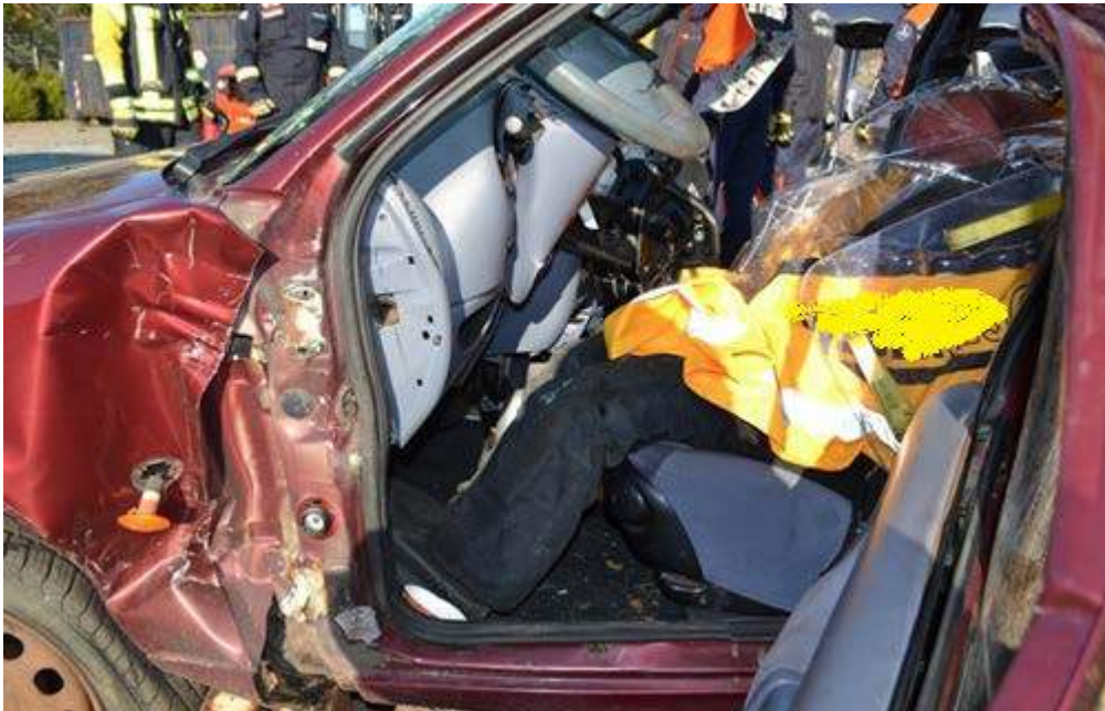
Rys. 325. Niecałkowite usunięcie drzwi ze względu na brak pełnego dostępu do nich od strony zgniecionej
