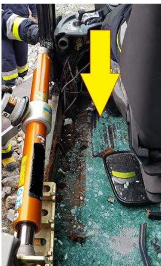
Rys. 395. Dokładne oklejenie szyb pozwala usunąć rozbite szkło na zewnątrz pojazdu
