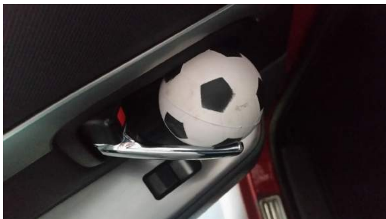
Rys. 243. Elastyczna piłka utrzymująca zamek drzwi w pozycji otwartej. Wewnętrzna część drzwi
