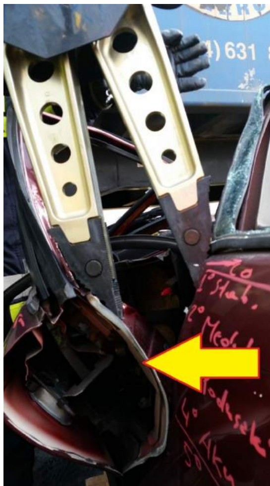
Rys. 249. Wcześniejsze złe przyłożenie narzędzia zerwało poszycie drzwi, osłabiając tym samym ogólną sztywność konstrukcji. Zerwane poszycie niezwykle utrudnia i spowalnia wyrwanie drzwi
