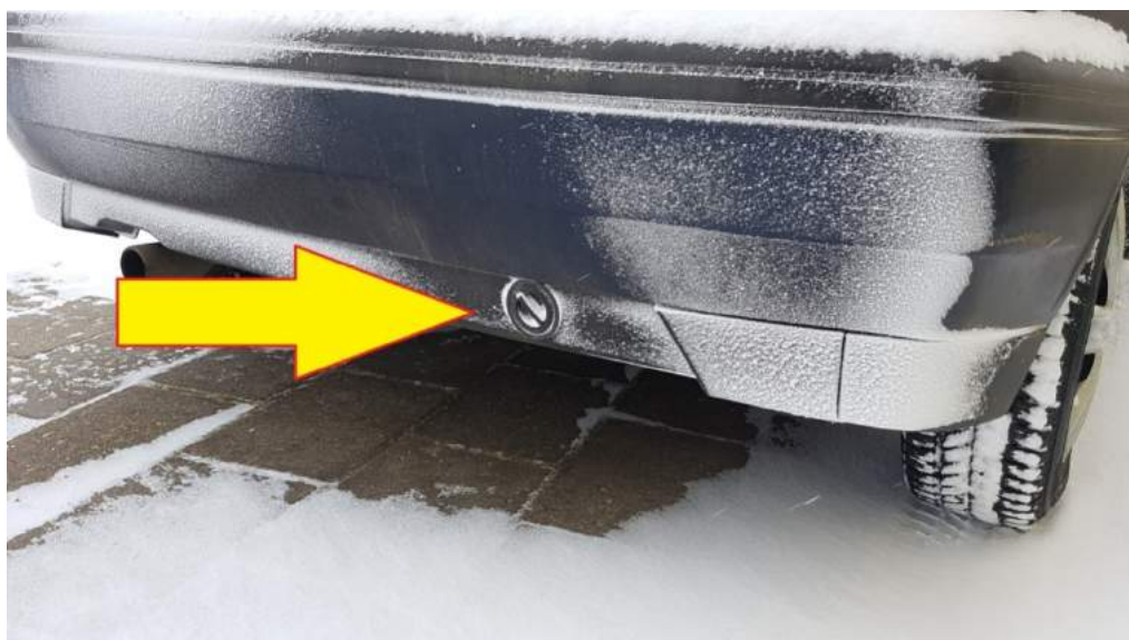
Rys. 72. Umiejscowienie króćca wlewowego gazu z tyłu pojazdu
