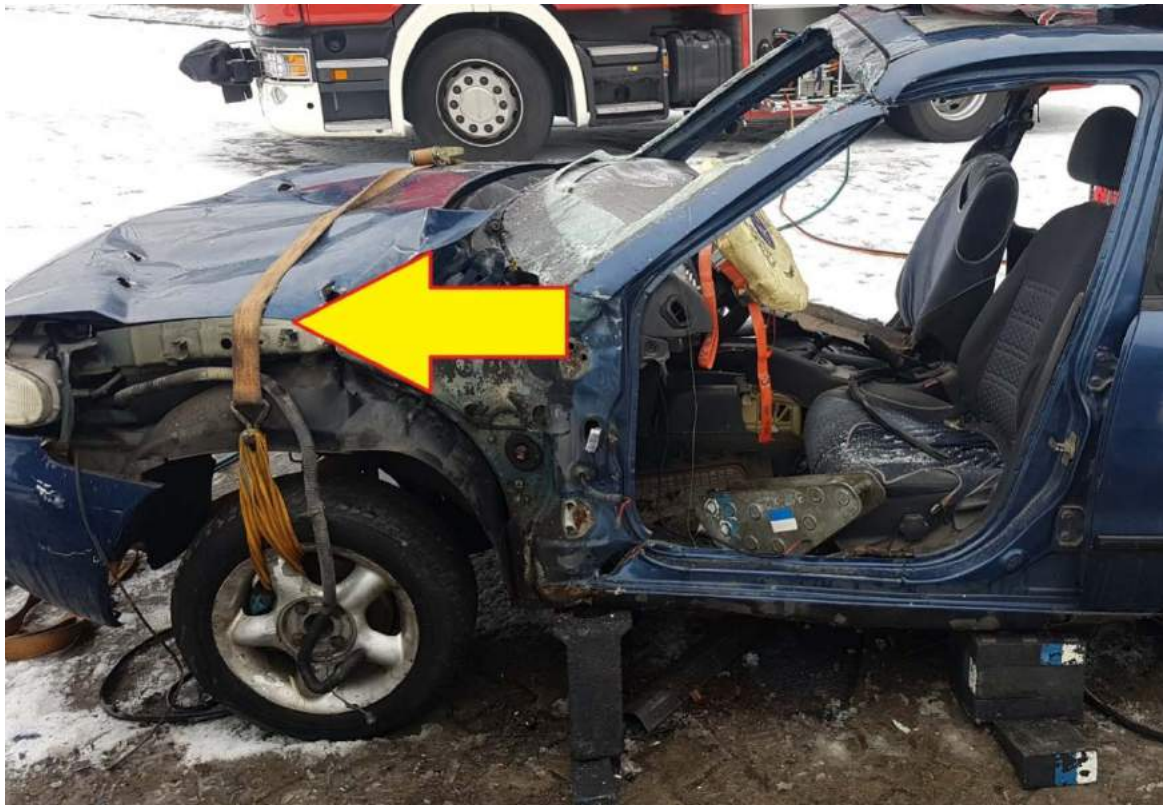
Rys. 147. Eliminacja efektu luzowania punktów stabilizacji przy pomocy pasa z naciągiem
