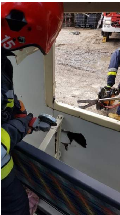
Rys. 422 A, B. Demontaż wewnętrznych elementów autobusu przy pomocy akumulatorowej szlifierki kątowej i nożyc hydraulicznych
