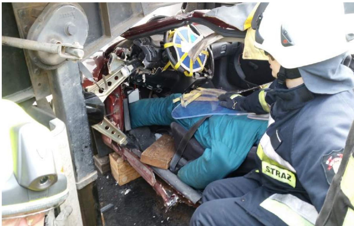
Rys. 361. Uzyskanie dostępu do nóg poprzez wykonanie jednej z technik. Tu: uniesienie całej deski rozdzielczej przy pomocy rozpieracza
