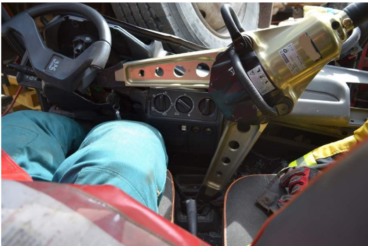
Rys. 198. Podniesienie kolumny kierownicy od strony pasażera poprzez wyparcie o wzmocnioną obudowę skrzyni biegów Uwaga: zdjęcie pokazuje sytuację po zakończeniu ruchu narzędzia. Podczas jego wykonywania wymagany jest pewny uchwyt narzędzia w celu asekuracji
