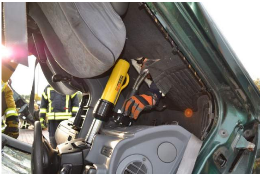
Rys. 200. Wyparcie kolumny kierowniczej przy pomocy cylindra rozpierającego wypartego o podłogę. Tu pojazd w pozycji „kołami do góry”
