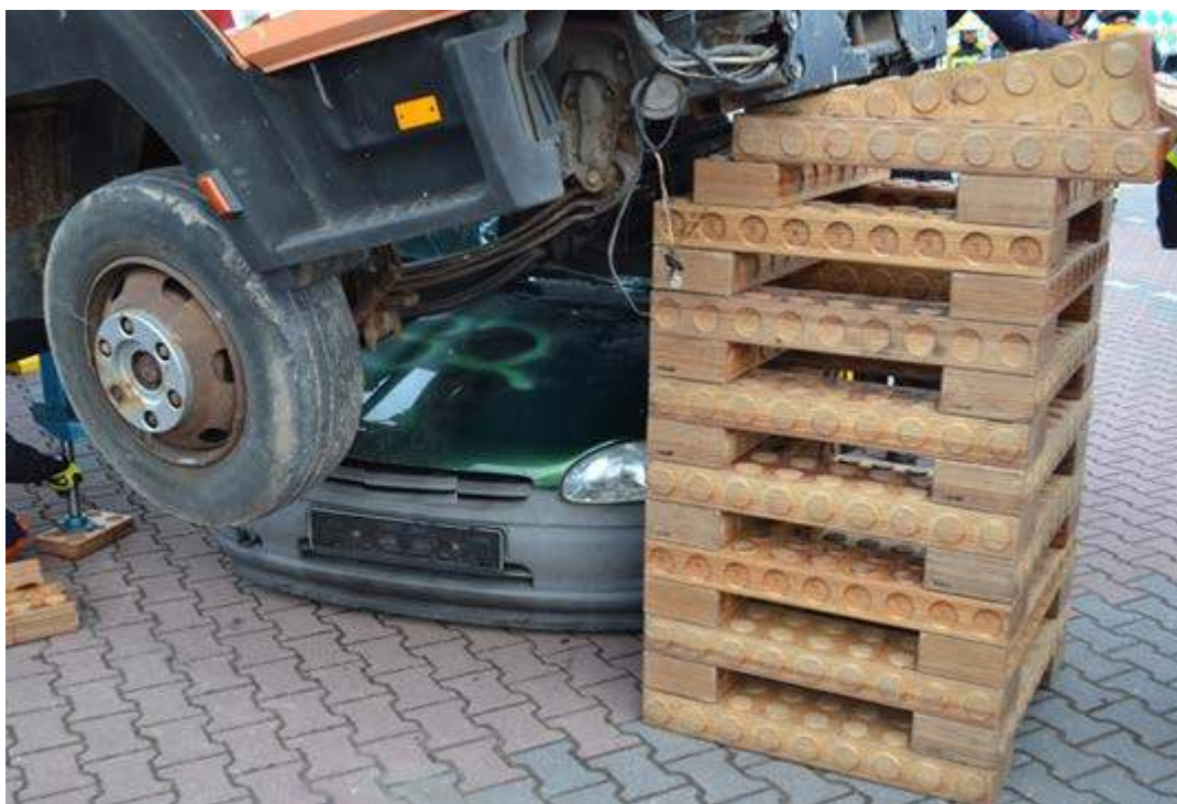
Rys.369. Wysoka podbudowa drewnem
