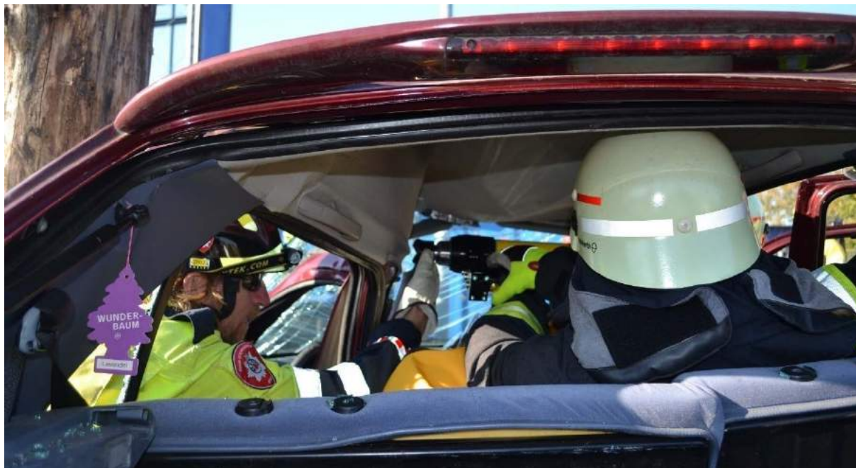
Rys. 226. Uderzenie boczne z drzewem. Rozpoczęcie cross-ramming
