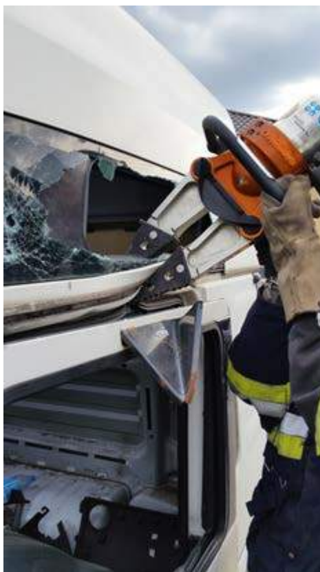
Rys. 338. Wykonanie szczeliny nad drzwiami przy pomocy rozpieracza do zamontowania liny asekuracyjnej
