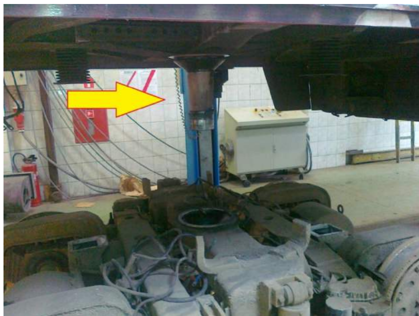
Rys. 427. Gniazdo wózka jezdniego i sworzeń wagonu Źródło: Jacek Gawroński, SA PSP Poznań
