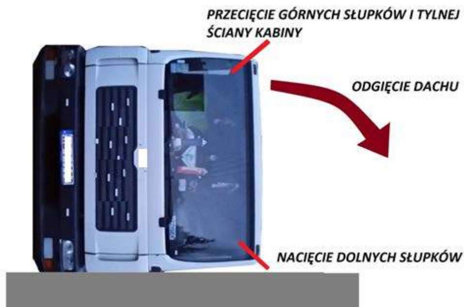
Rys. 353. Miejsca wykonywania cięć w technice odgięcia dachu
