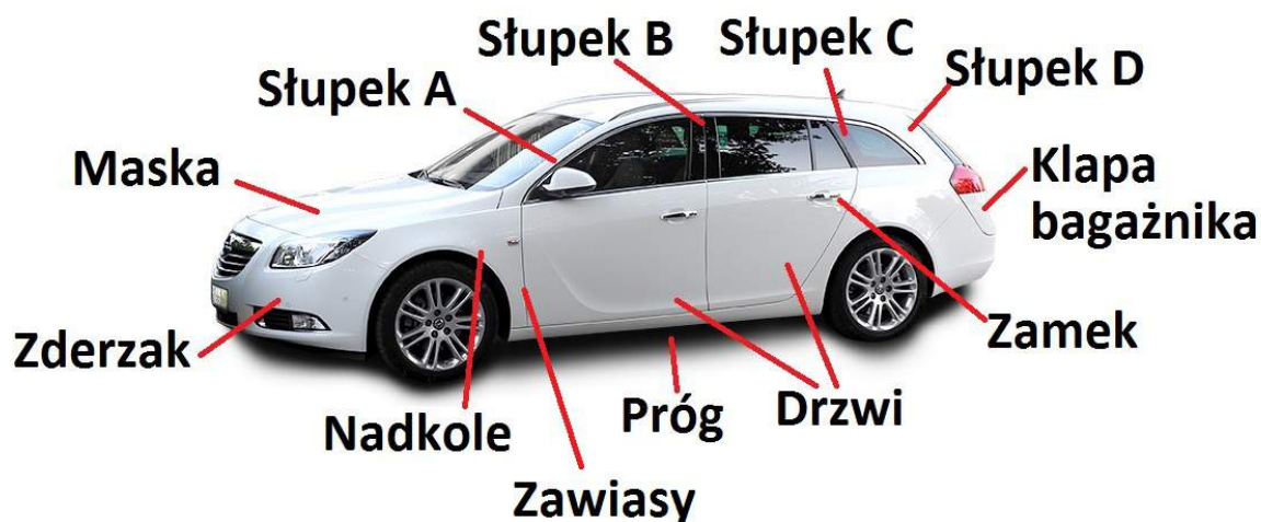
Rys. 80. Elementy samochodu osobowego oraz inne nazewnictwo słupków, które nie jest traktowane jako standard w Polsce
