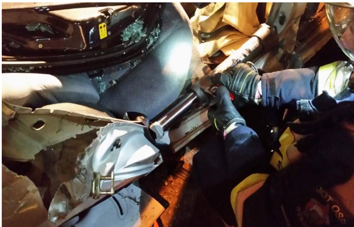
Rys. 240. Dalsze rozpieranie cylindrem rozpierającym
