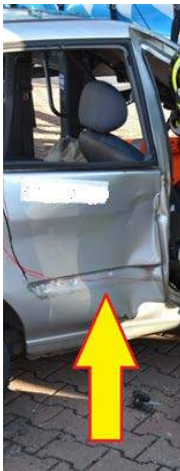
Rys. 271. Metoda „trzecich drzwi”. Cięcie wykonywane piłą szablą
