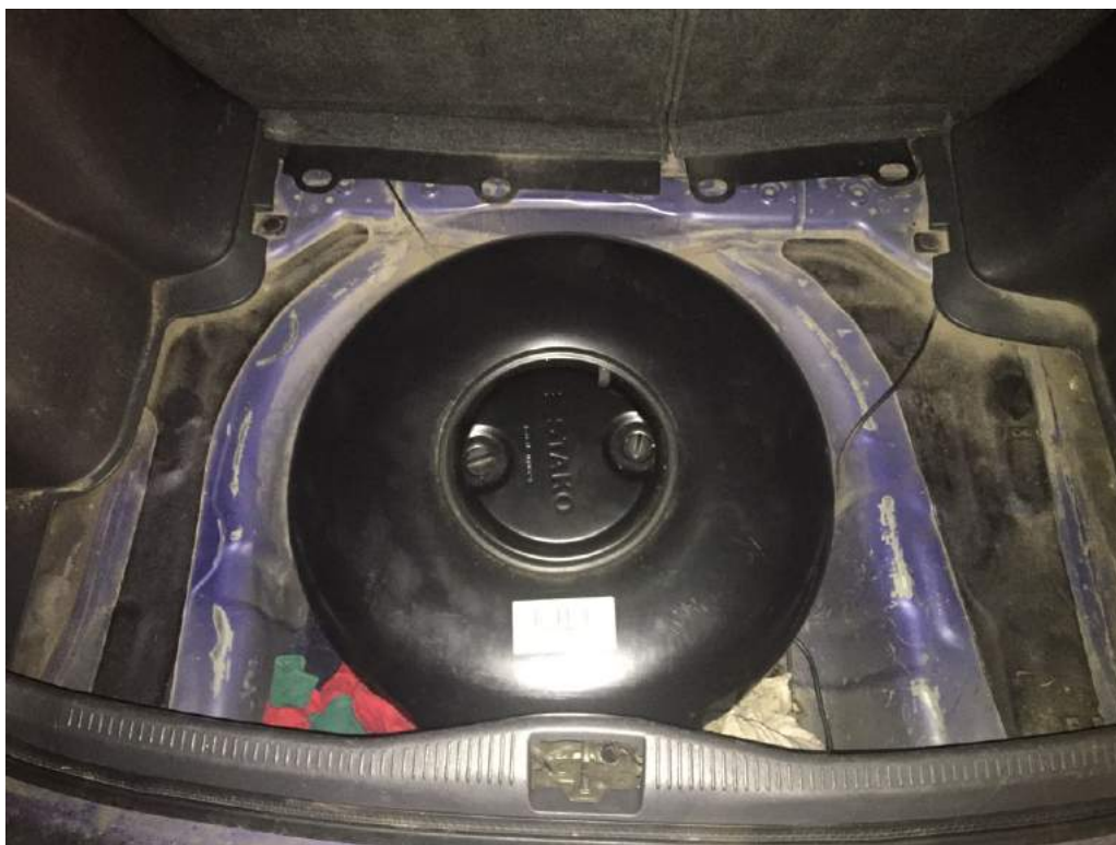
Rys. 69. Zbiornik toroidalny, umiejscowiony w przestrzeni na koło zapasowe
