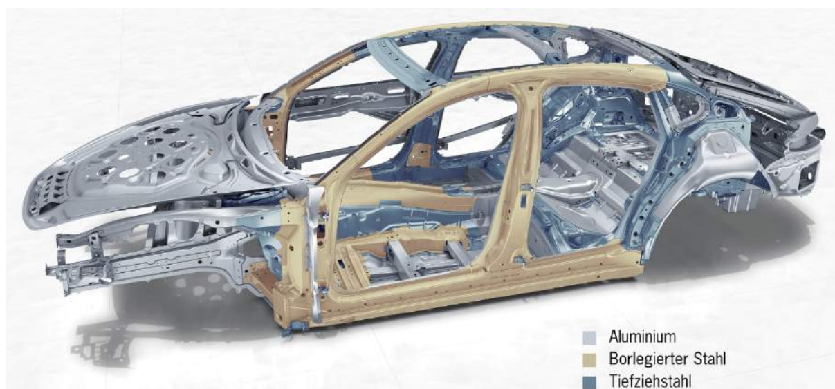
Rys. 53. Struktura Porsche Panamera z 2017 r. To połączenie aluminium i niezwykle wytrzymałej stali borowej (która dodatkowo utwardza się podczas zgniatania)
