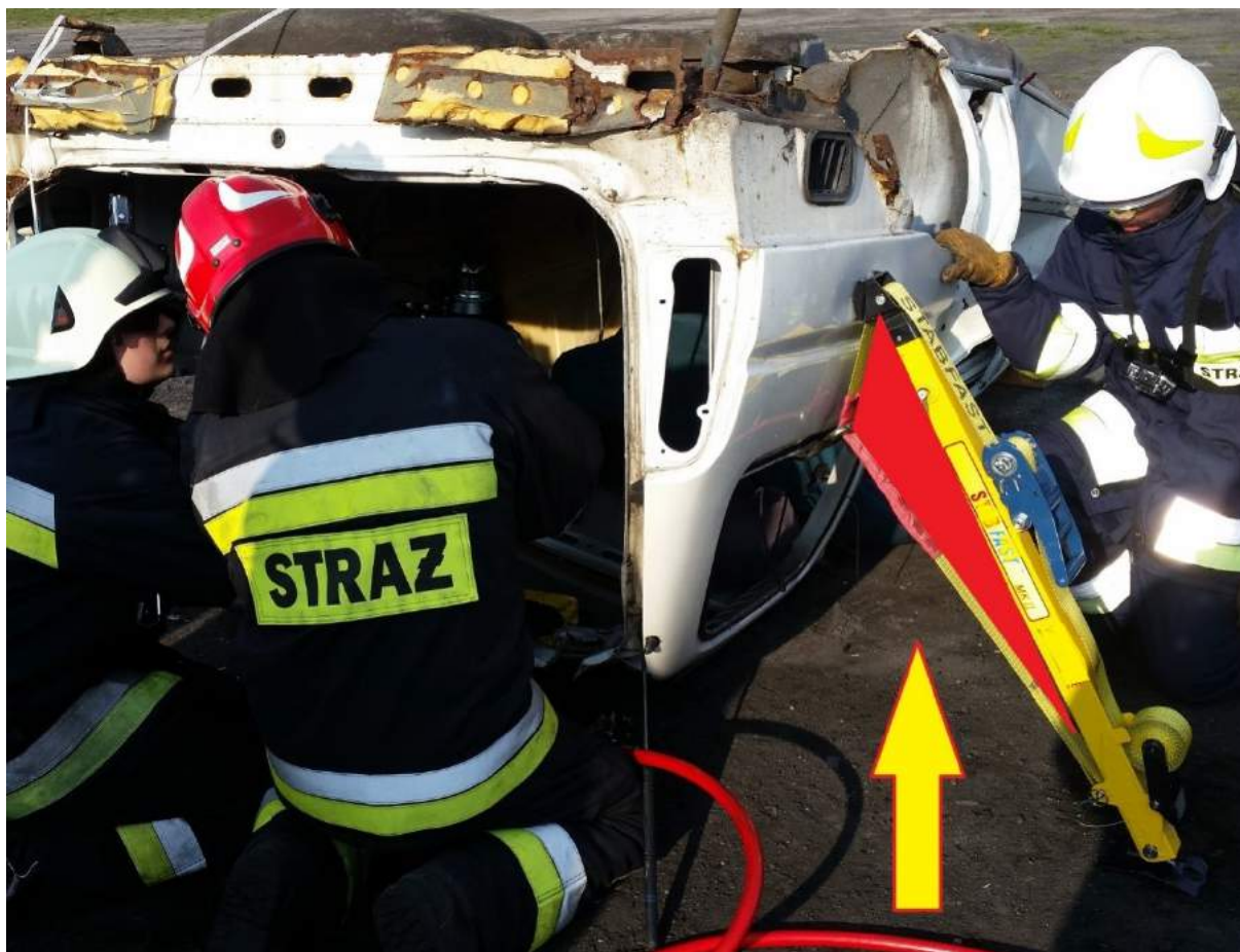
Rys. 166. Małe pole trójkąta zawartego między pasem, a kolumną, ze względu na wysoko osadzony punkt zaczepienia pasa
