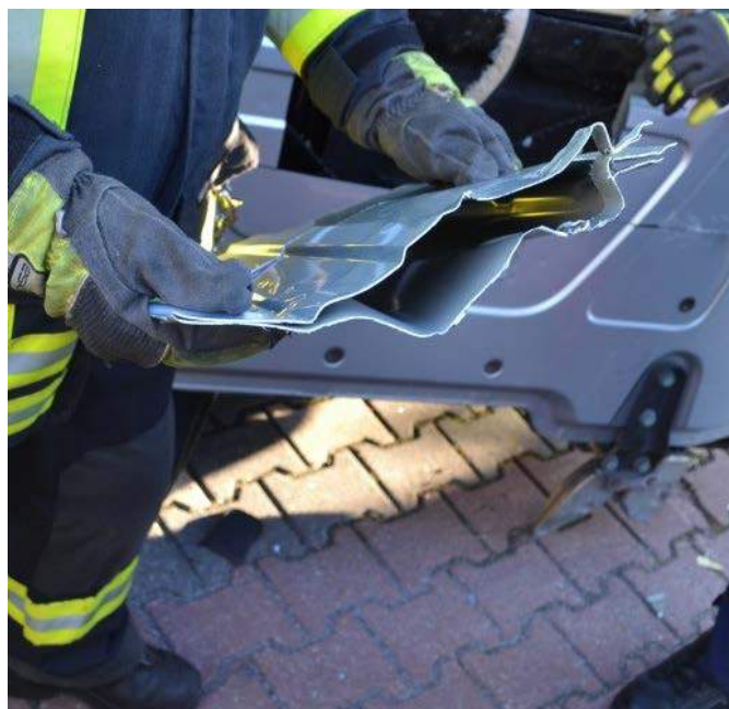
Rys. 350. Przekrój przez wypukłe elementy ściany kabiny
