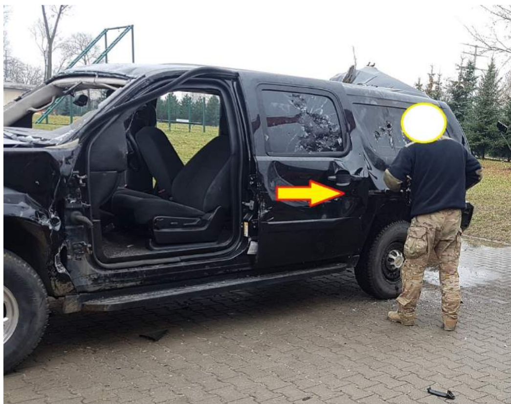
Rys. 458. Wyważenie drzwi od strony zamka
