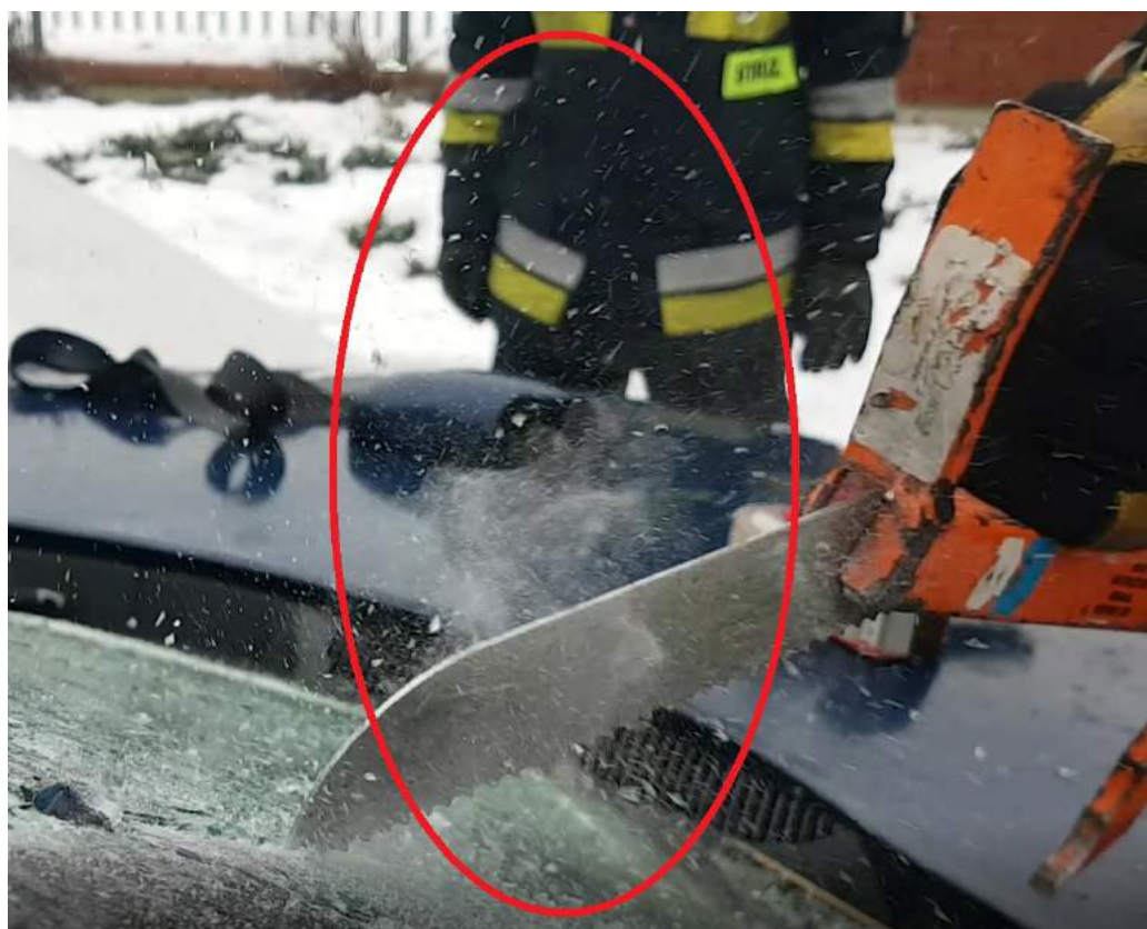
Rys. 180. Różne frakcje pyłu szklanego podczas cięcia szyby klejonej
