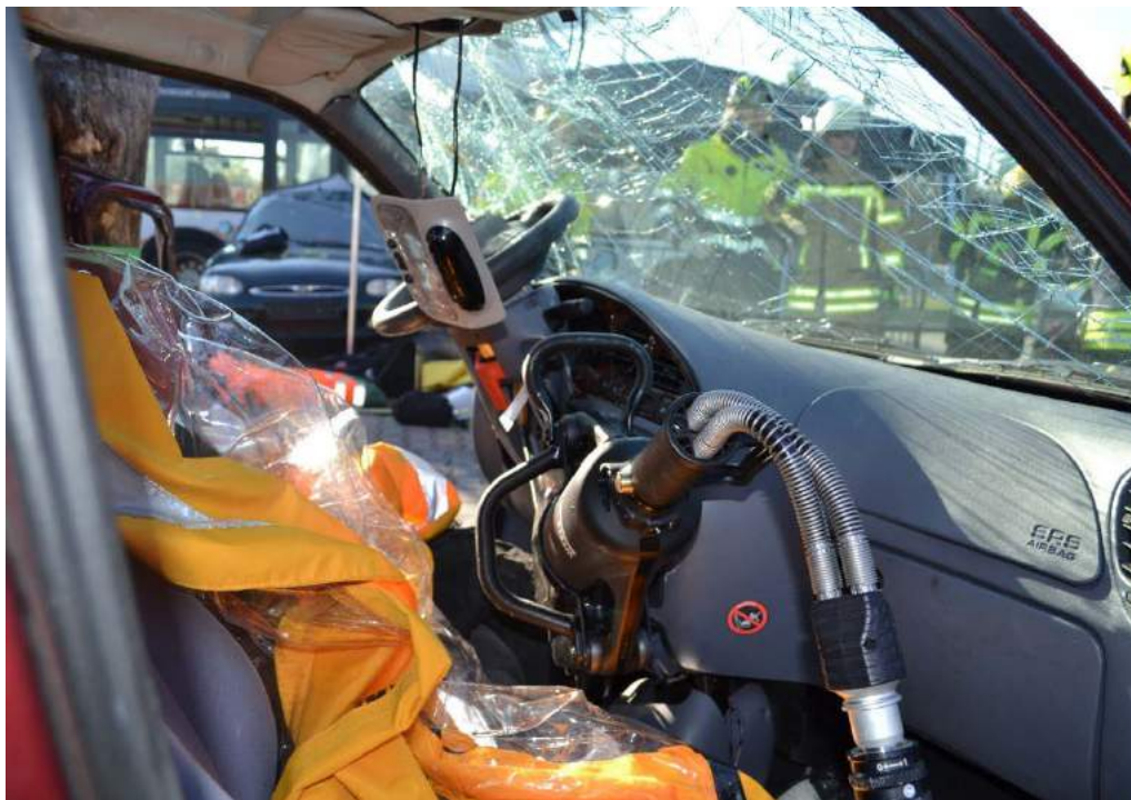
Rys. 326. Uniesienie kolumny kierownicy od strony nieuszkodzonej
