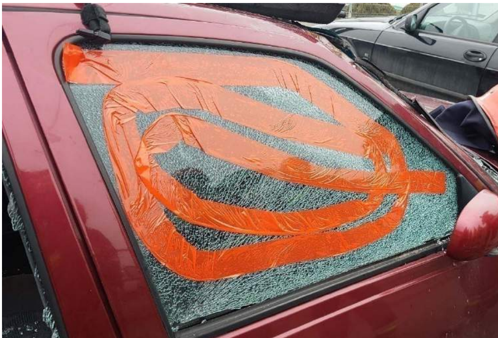
Rys. 187. Oklejenie szyby w tzw. „ślimak” nie powoduje strat czasowych, tak jak oklejenie w kratkę. Nie występuje tu trudność w późniejszym wypychaniu rozbitego szkła na zewnątrz pojazdu – odpada ono całą taflą
