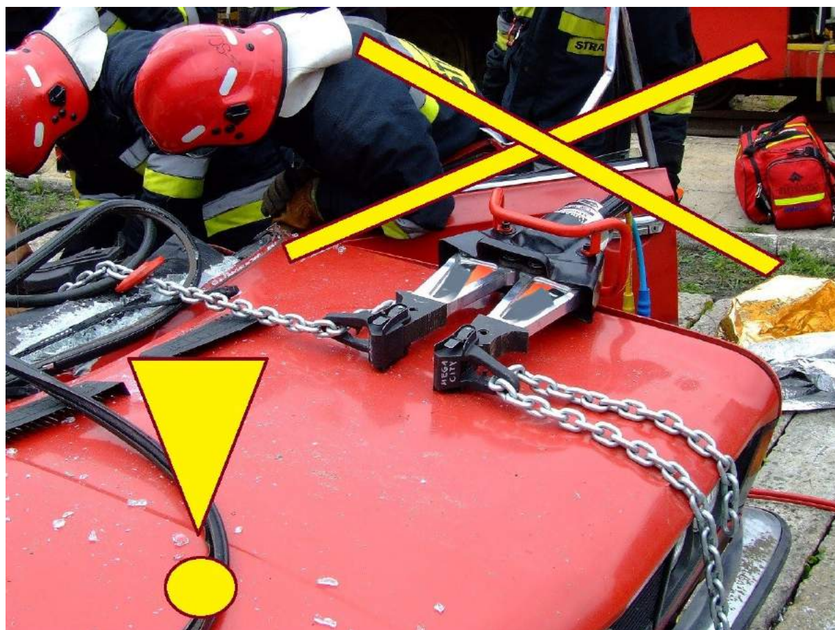
Rys. 212. Niebezpieczna technika wykorzystująca rozpieracz i łańcuchy
