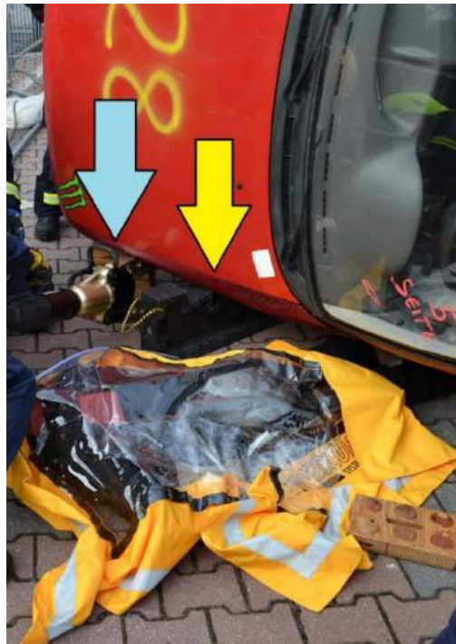
Rys. 174. Stabilizacja wspomagająca z wykorzystaniem klina schodkowego (żółta strzałka). Podnoszenie realizowane przez rozpierzacz (niebieska strzałka)
