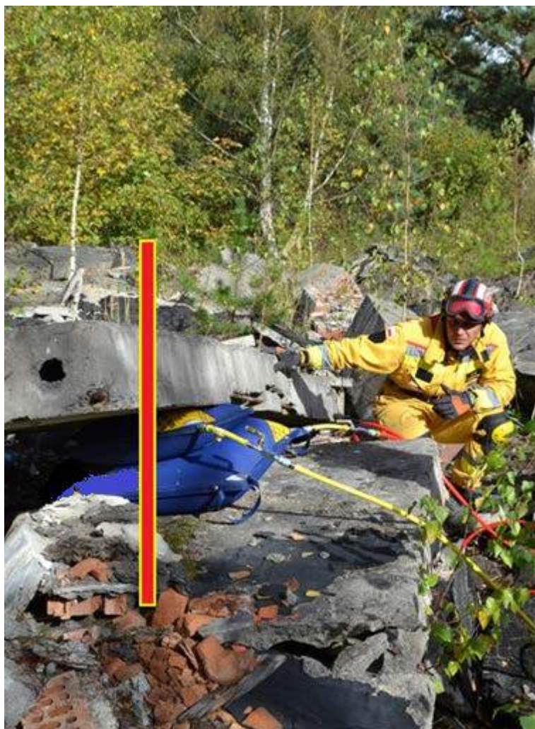
Rys. 46. Stos z dwóch poduszek podnoszących. Poduszki umieszczono osiowo. Większa poduszka podnosząca tworzy podstawę stosu
