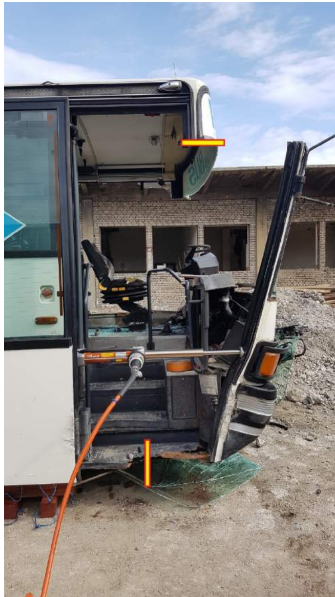
Rys. 412. Odepchnięcie przodu pojazdu przy pomocy cylindra rozpierającego
