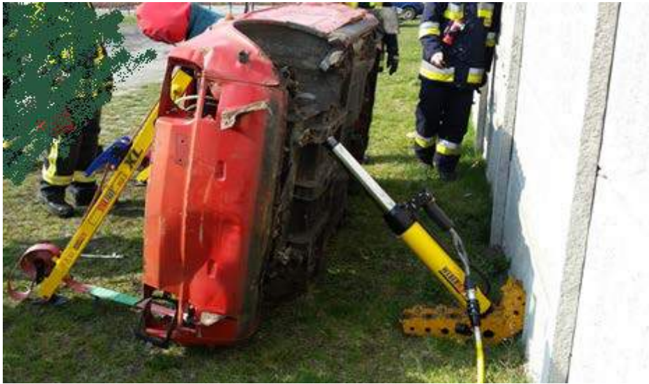
Rys. 295. Wykorzystanie cylindra rozpierającego, jako elementu stabilizacji. Tu wspornik nieumocowany pasem do podwozia, ze względu na jego zakotwienie o pewny, betonowy płot
