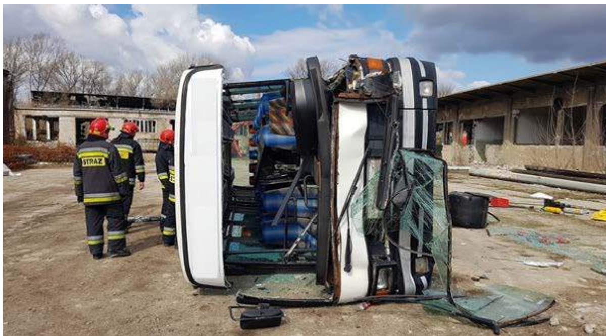
Rys. 417. Dostęp do wnętrza przez przednią szybę
