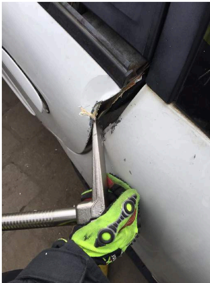
Rys. 246. Dalsze powiększanie szczeliny przez obrót halligana
