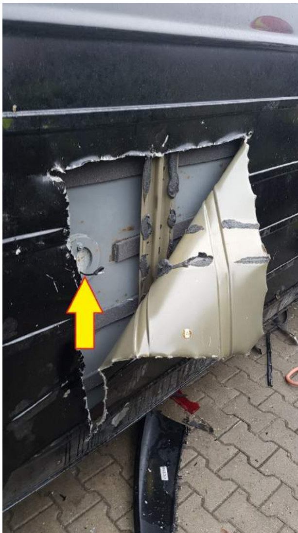
Rys. 455. Stalowe wzmocnienie dachu pod blaszanym poszyciem
