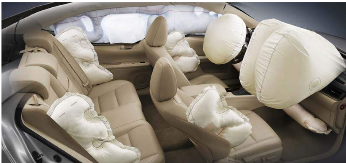
Rys. 62. Przykładowe umiejscowienie poduszek bezpieczeństwa.
