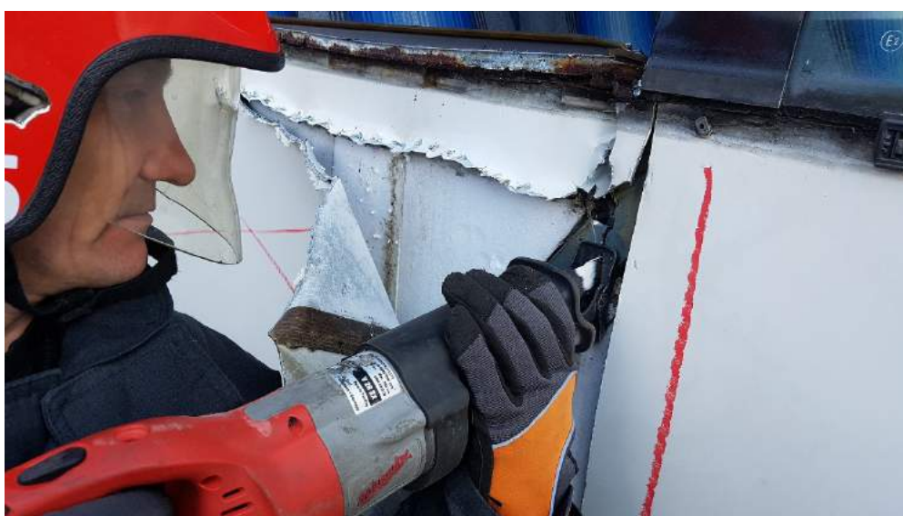
Rys. 406. Cięcie całego boku autobusu piłą szablstą
