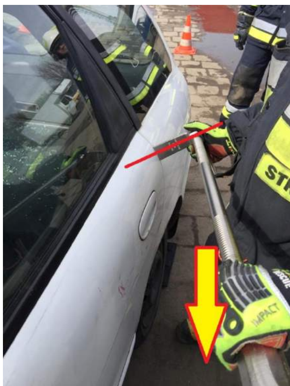
Rys. 245 A, B. Powiększanie szczeliny przez obrót narzędzia
