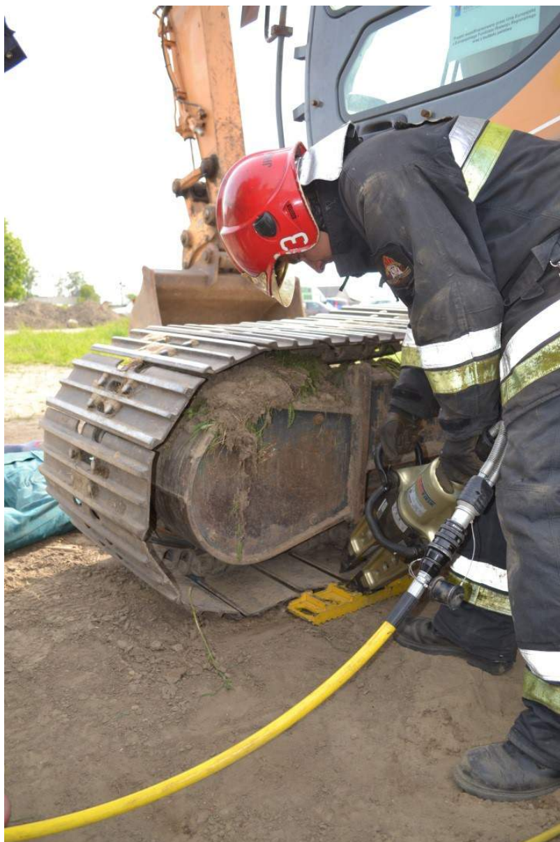
Rys. 387. Rozpieranie samej gąsienicy
