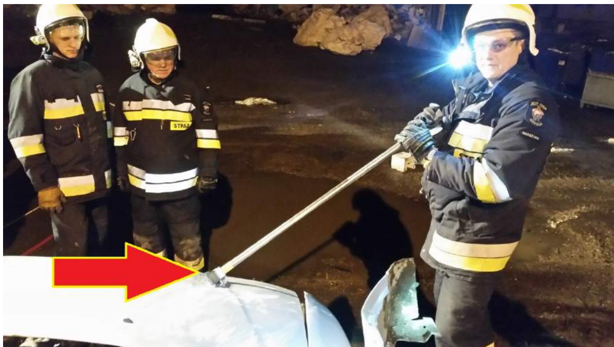
Rys. 330. Wbicie kolca halligana w okolice krawędzi maski
