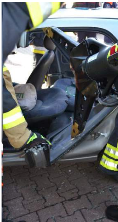
Rys. 272. Metoda „trzecich drzwi”. Odgięcie poszycia przy pomocy rozpieracza
