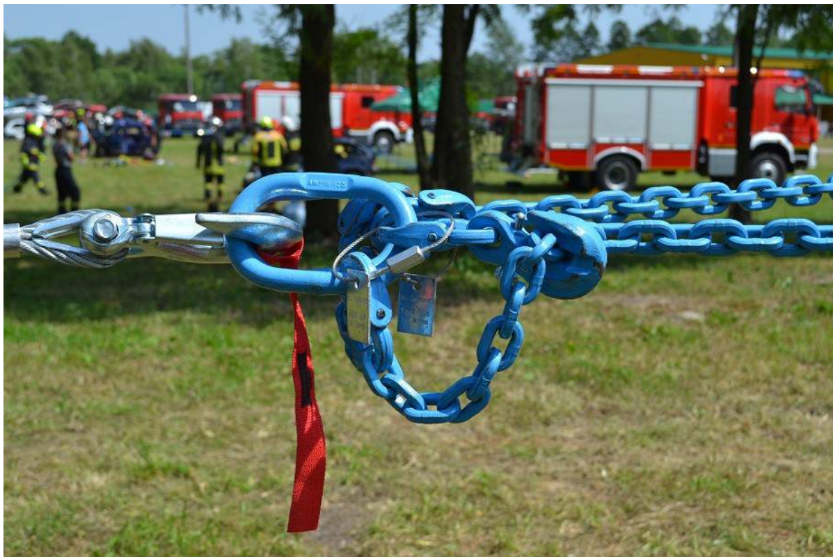
Rys. 437. Zastosowanie łańcuchów, które umożliwiają regulację ich długości
