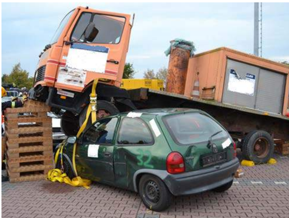
Rys. 371. Trzy pasy: jeden stabilizuje kabinę, drugi resorowanie ciężarówky, a trzeci resorowanie osobówki
