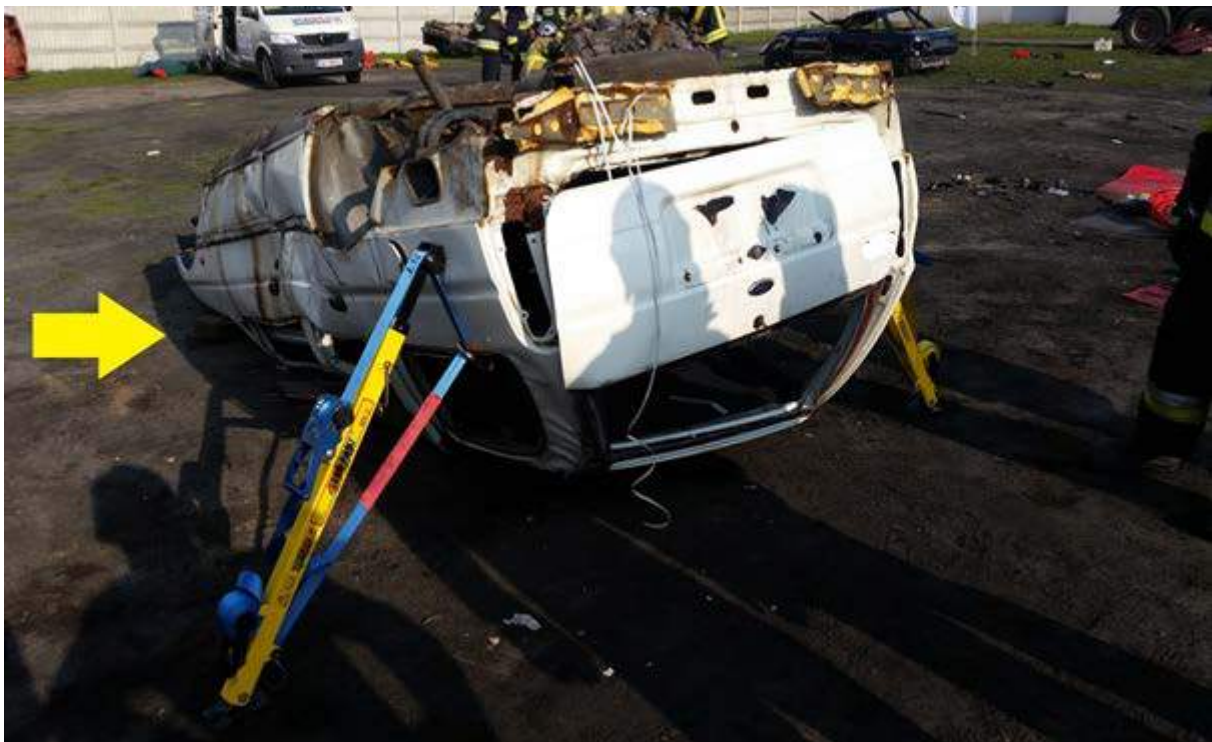
Rys. 304. Prawidłowe wyparcie głowicy o płaski, metalowy element. Podpory po obu stronach auta. Wysoko osadzony punkt mocowania pasa
