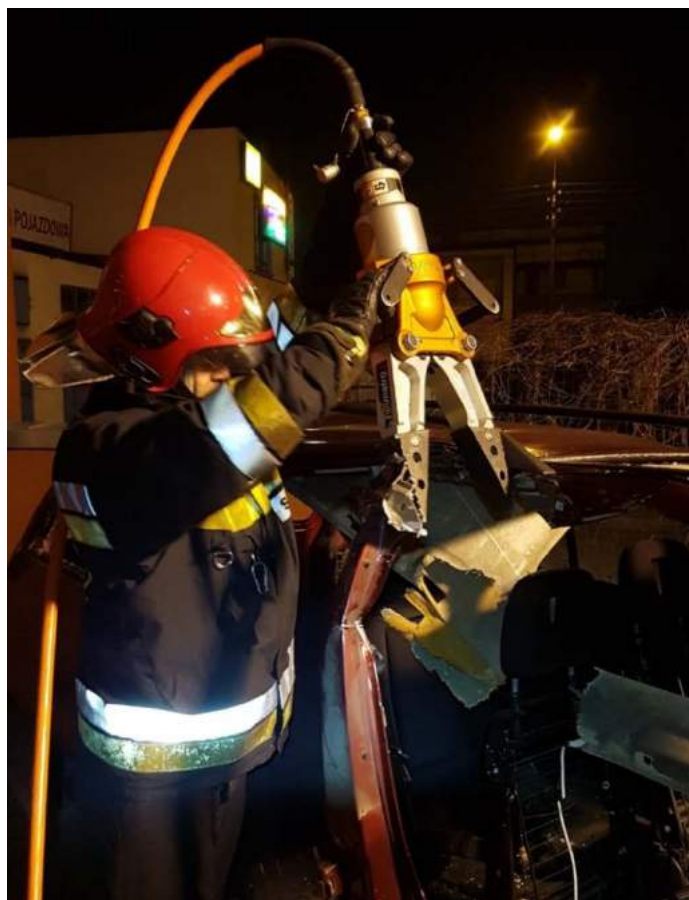
Rys. 268. Odginanie słupka C od konstrukcji pojazdu przy pomocy rozpierzacza
