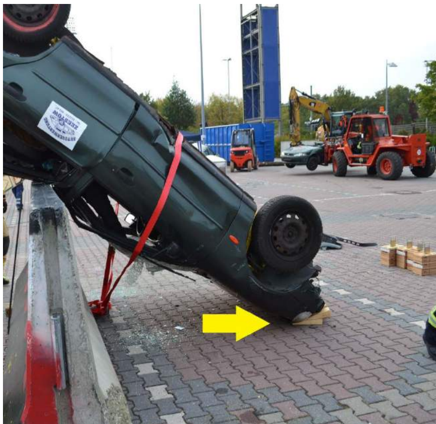
Rys. 314. Stabilizacja pojazdu przy pomocy halligana i pasa transportowego z naciągiem. Tu widoczne również klinowanie, które zabezpiecza przed ruchem w osi
