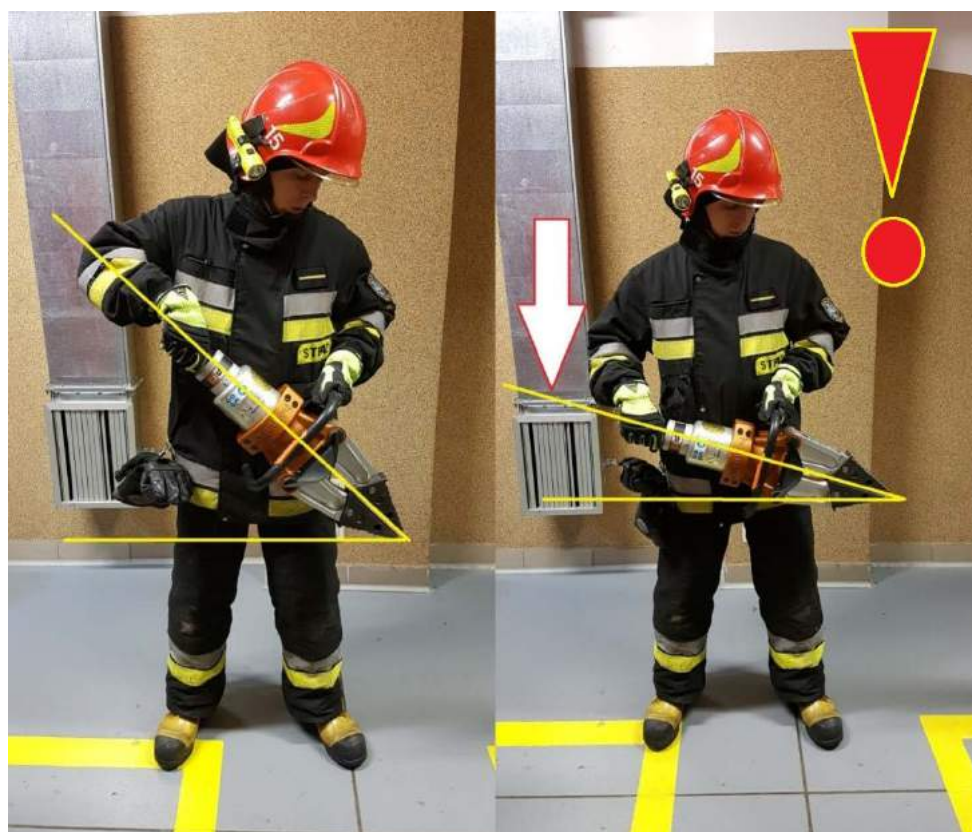
Rys. 35. Trzymanie manetki rozpieracza podchwytem, które utrzymuje prawidłowy kąt pracy narzędzia
