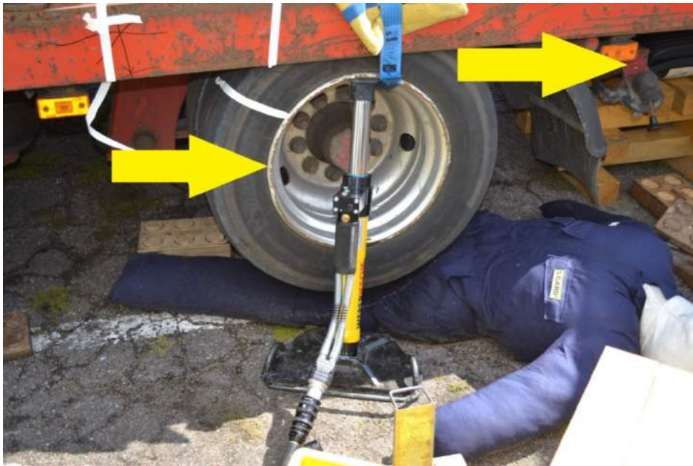
Rys. 385. Wspomaganie pchania poduszkami podnoszącymi osadzonymi na głównej podbudowie pojazdu
