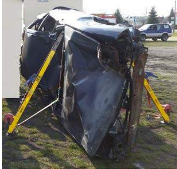
Rys. 292. Podpory mechaniczne szybkiej stabilizacji umieszczone po obu stronach pojazdu, na tej samej wysokości
