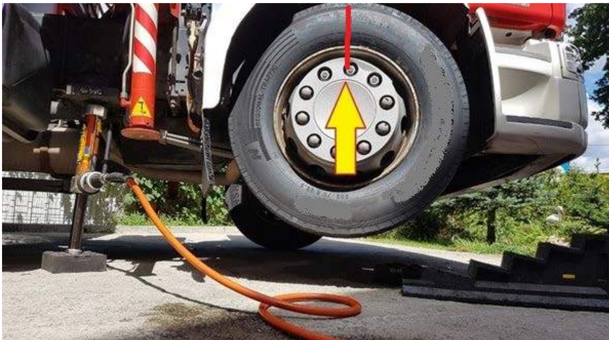
Rys. 377. Podnoszenie ciężarówki cylindrem rozpierającym pod ramą pojazdu. Nie założono tu pasa z naciąganiem na koło, które dało by dodatkowe kilkanaście centymetrów przestrzeni pod kołem (ograniczenie obiektu, na którym ćwiczą)
