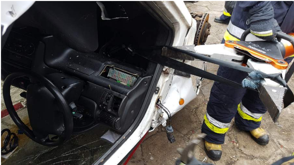
Rys. 218. Odgięcie pedałów przy pomocy taśmy wykonanej z pasa bezpieczeństwa i rozpieracza opartego o podstawę słupka B (widok z zewnątrz)
