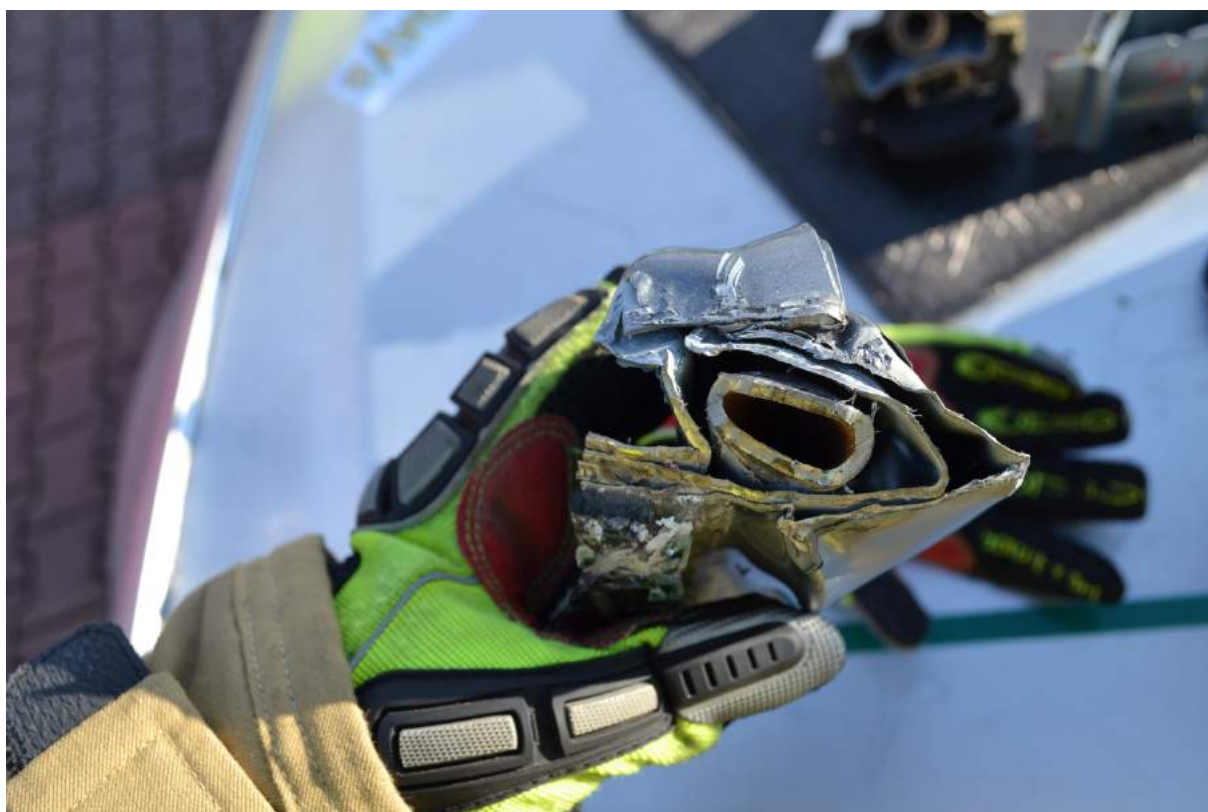
Rys. 59. Wynik nieskutecznej próby przecięcia wzmocnionego słupka C przy pomocy nożyc hydraulicznych (do celów poglądowych element docięto piłą do stali)
