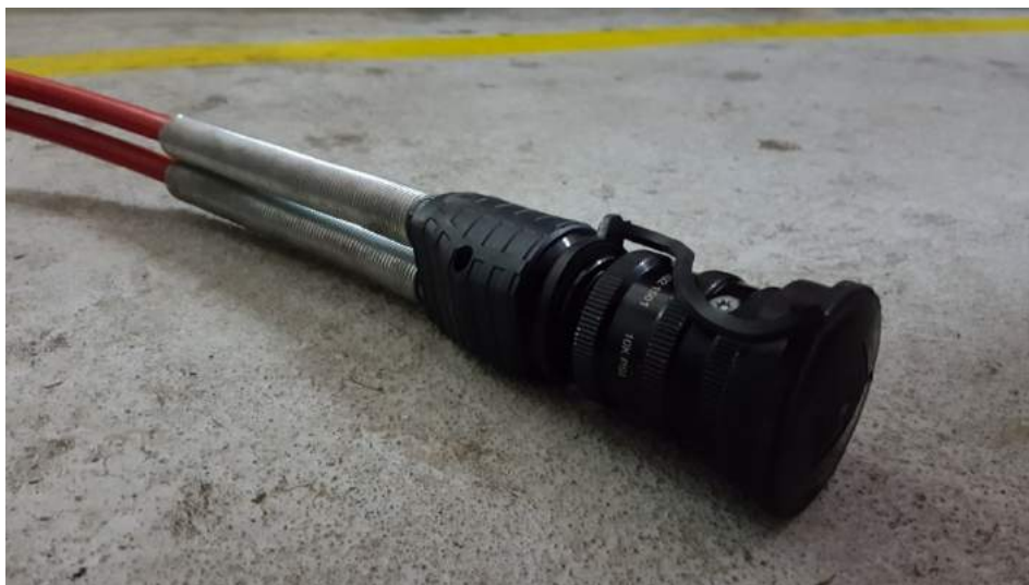
Rys. 25. Zestaw węża z szybkozłączem – jedno z rozwiązań
