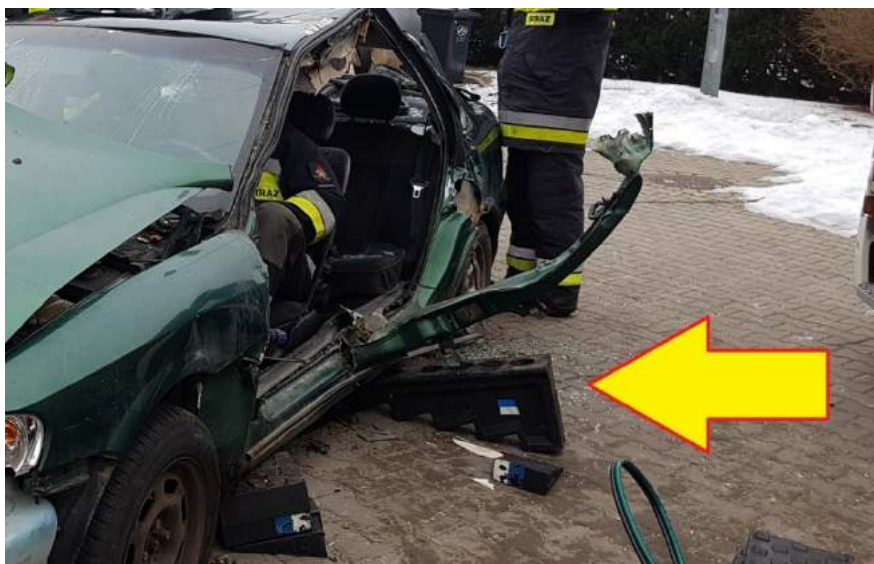
Rys. 156. Wstawienie klina schodkowego uniemożliwiającego całkowite położenie słupka C. W tym miejscu lepiej sprawdza się podbudowa klockami
