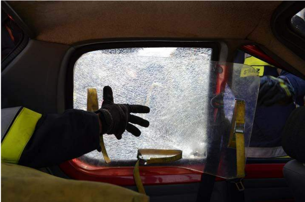
Rys. 182. Wypchnięcie rozbitej szyby za pomocą tarczy z tworzywa sztucznego
