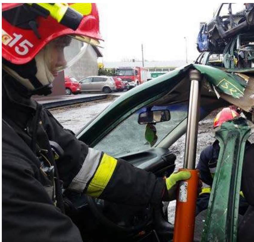
Rys. 263. Całkowite oderwanie słupka po pęknięciu zgrzewu
