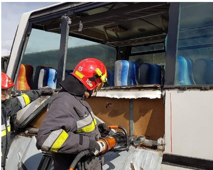
Rys. 404. Cięcie odsoniętych profili nożycami hydraulicznymi
