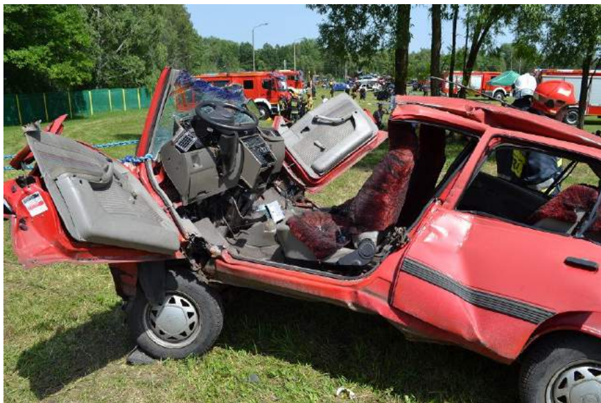
Rys. 443. Duża przestrzeń wokół osoby poszkodowanej po wykonaniu odciążenia
