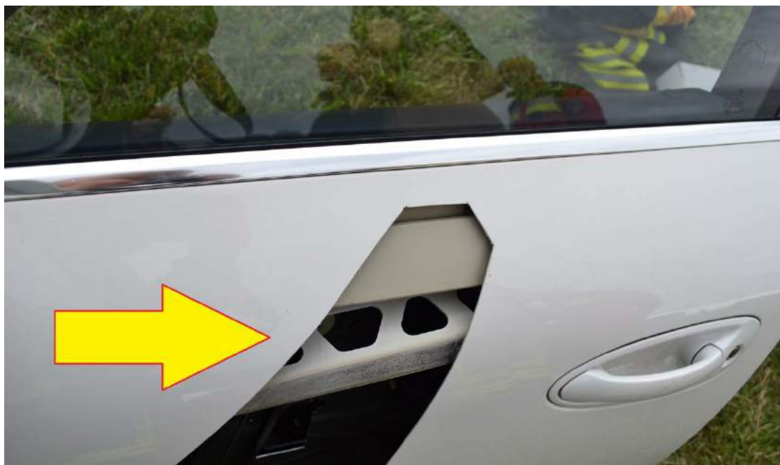
Rys. 135. Widoczne wzmocnienie drzwi
