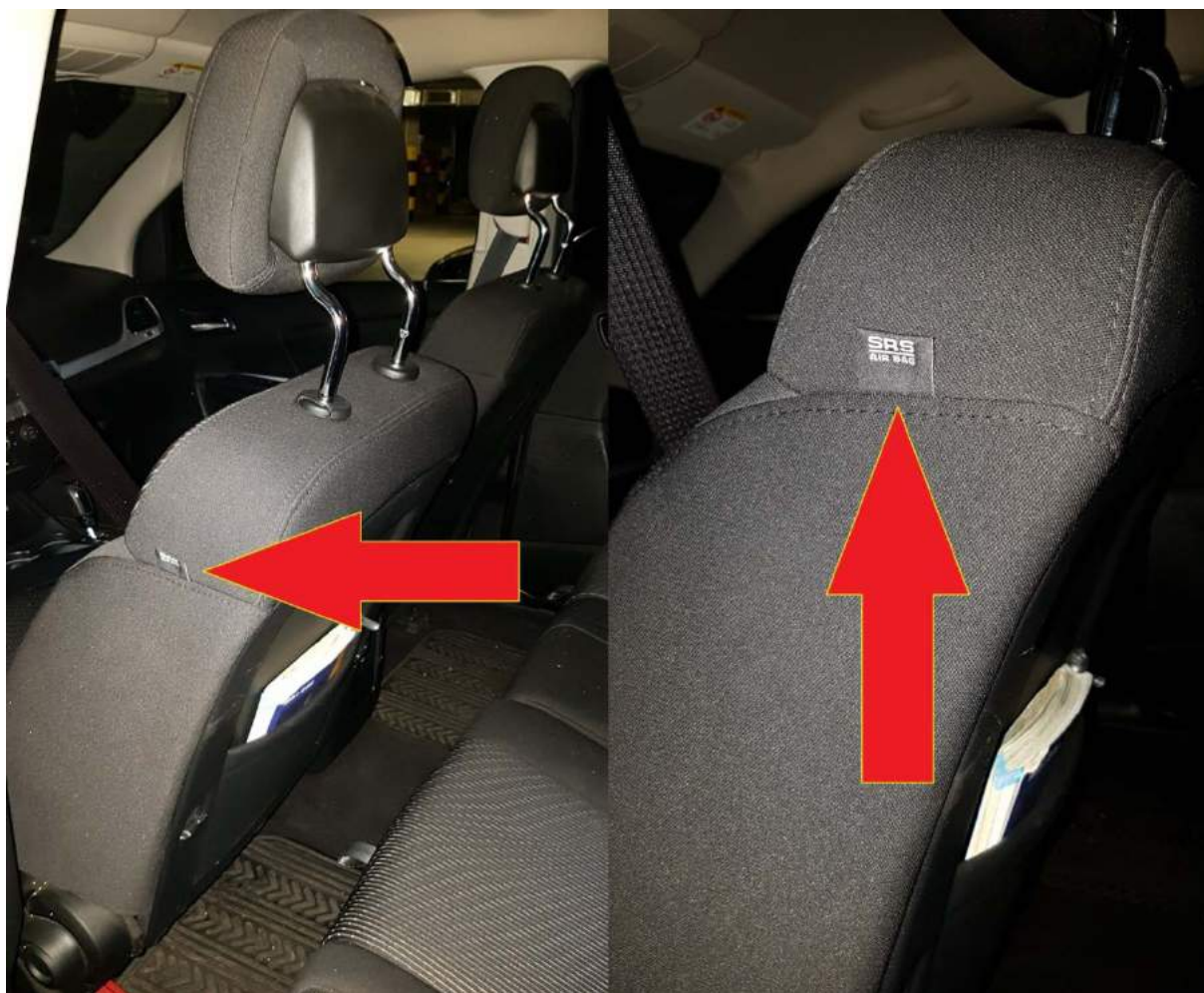
Rys. 141. Umieszczenie elementów systemów bezpieczeństwa w fotelach
