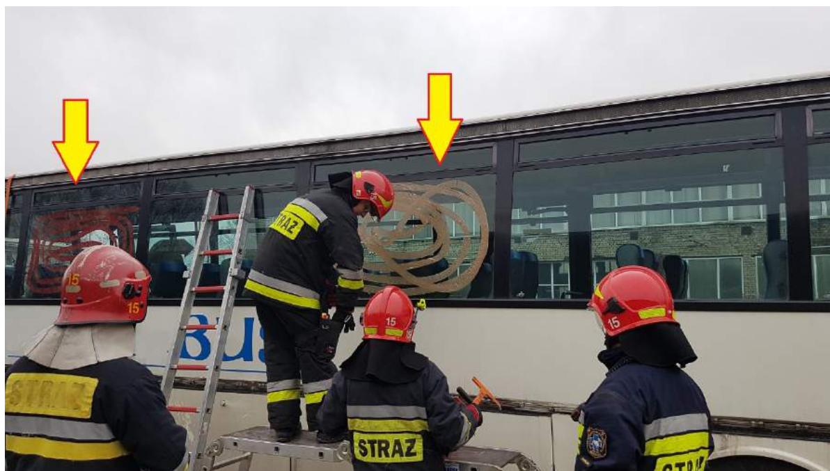
Rys. 394. Dokładne oklejenie szyb. Praca z podestu ratowniczego
