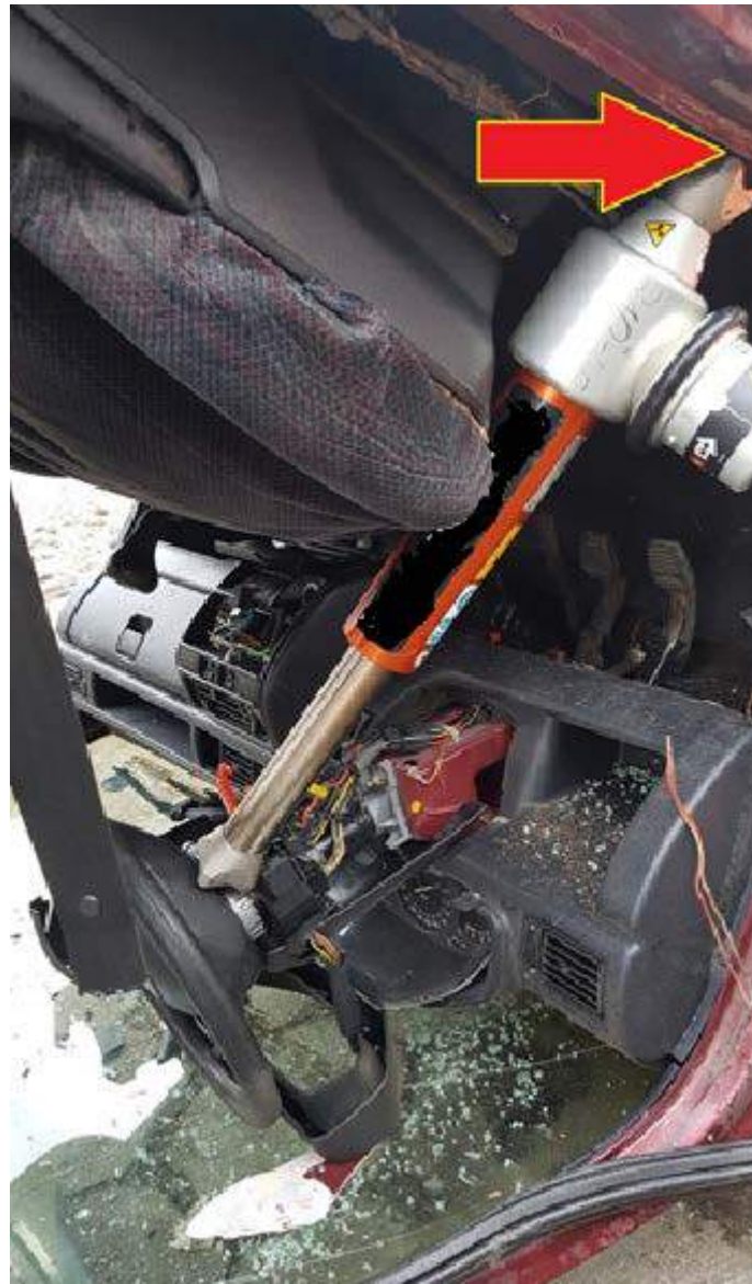
Rys. 202. Wyparcie kolumny kierowniczej przy pomocy cylindra rozpierającego wypartego o próg pojazdu. Pojazd w pozycji na dachu. Z progu pojazdu muszą być zdjęte lub odchyłone gumowe i/lub plastikowe elementy, aby zapobiec wyskoczeniu cylindra
