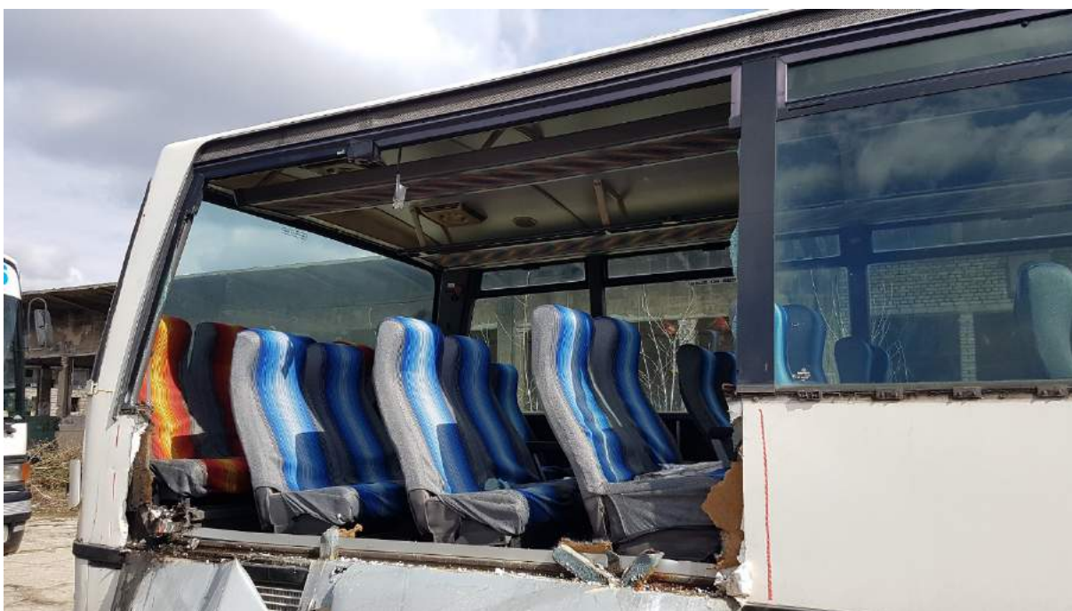
Rys. 401. Przestrzeń uzyskana po usunięciu boku o szerokości dwóch okien
