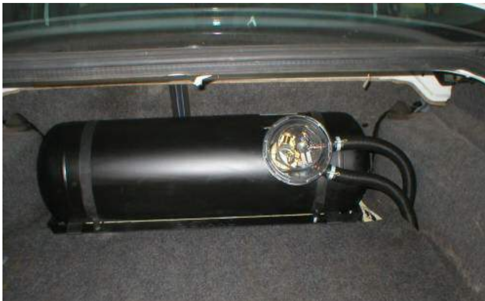
Rys. 71. Zbiornik walcowy, umiejscowiony w bagażniku
