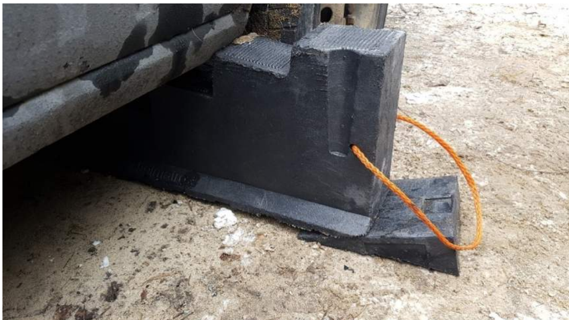
Rys. 148. Pierwszy sposób wykorzystania klina schodkowego we współpracy z klinem
