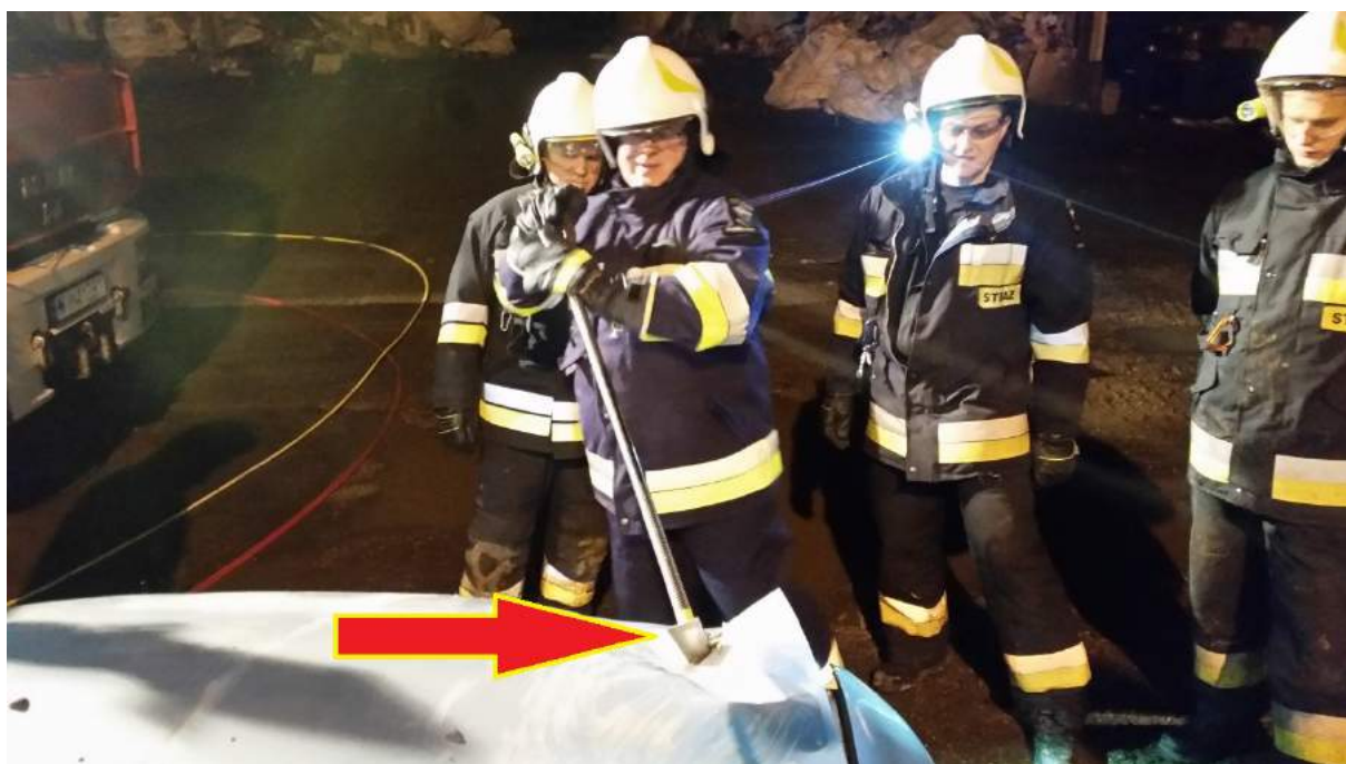
Rys. 331. Uzyskanie szczeliny poprzez odgięcie narzędzia
