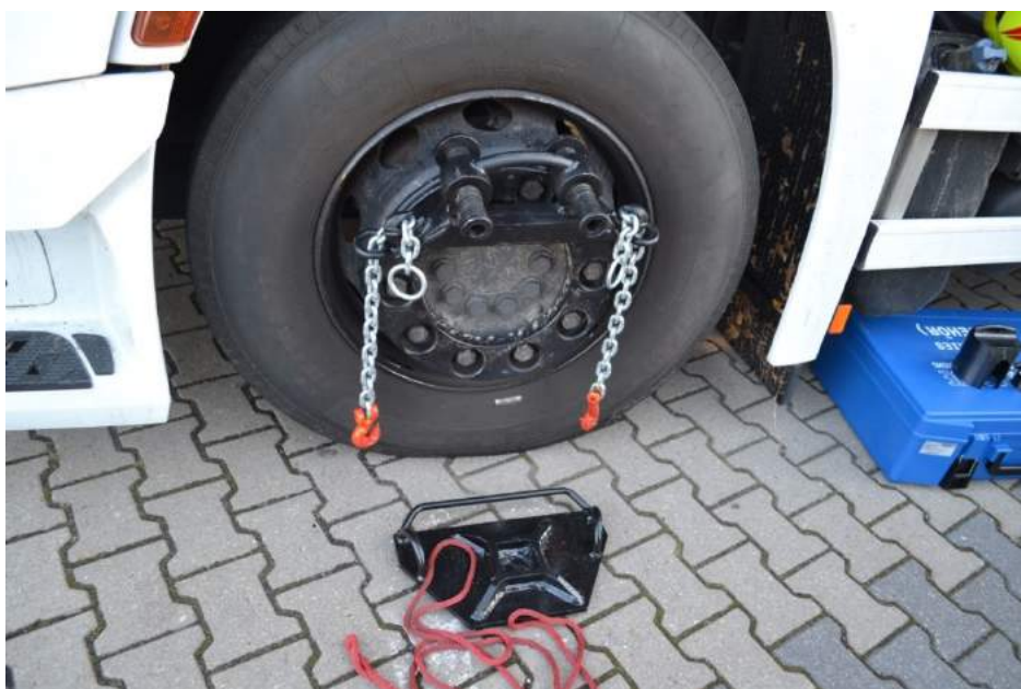
Rys.380. Specjalna końcówka montowana na feldze wypukłej
