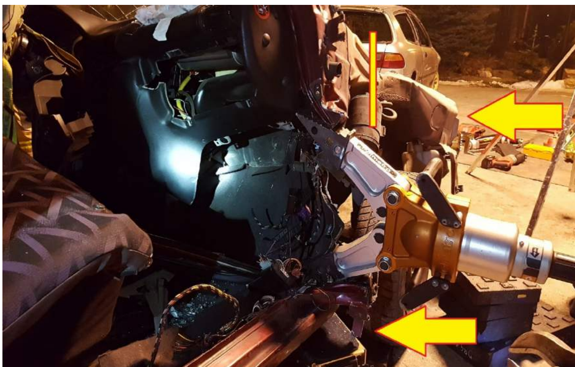
Rys. 211. Wyparcie powstałego nacięcia i podniesienie deski rozdzielczej. Strzałkami zaznaczono podbudowę pod słupkiem B oraz zdjęcie nadkola. Linia zaznaczono nacięcie ułatwiające podniesienie deski rozdzielczej
