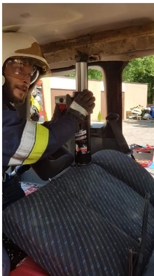
Rys. 284. Kontynuacja siłowego opuszczenia tylnego oparcia cylindrem rozpierającym. Konieczna podbudowa przy dachu
