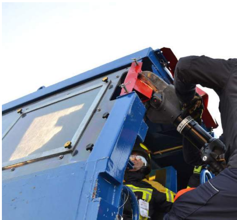
Rys. 341. Nacięcie słupka A równoległe do jego przekroju
