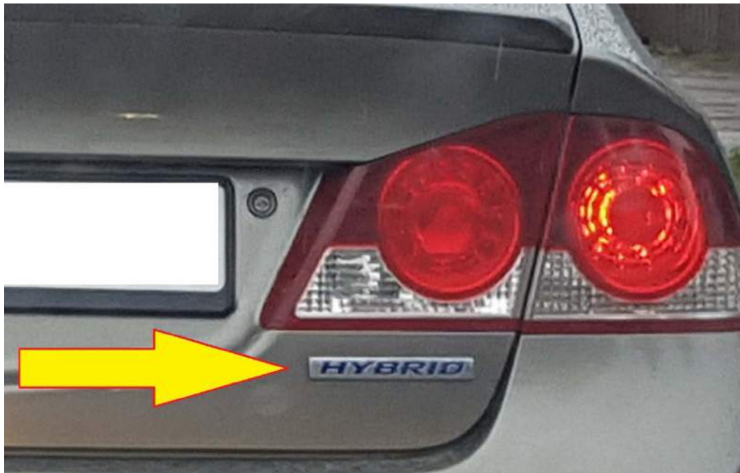
Rys. 79. Oznaczenie samochodu hybrydowego na klapie bagażnika
