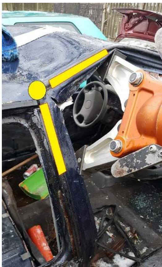
Rys. 266. Końcówki ramion rozpieracza tworzą ze zgrzewem trójkąt równoramienny
