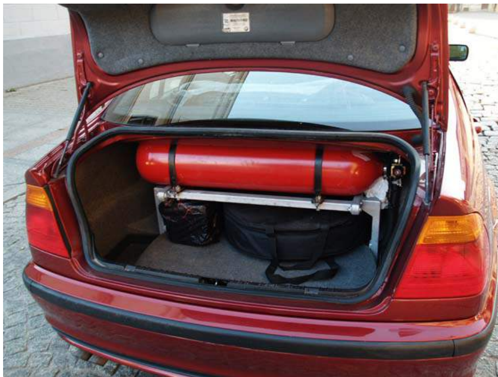
Rys. 75. Zbiornik CNG w bagażniku auta
