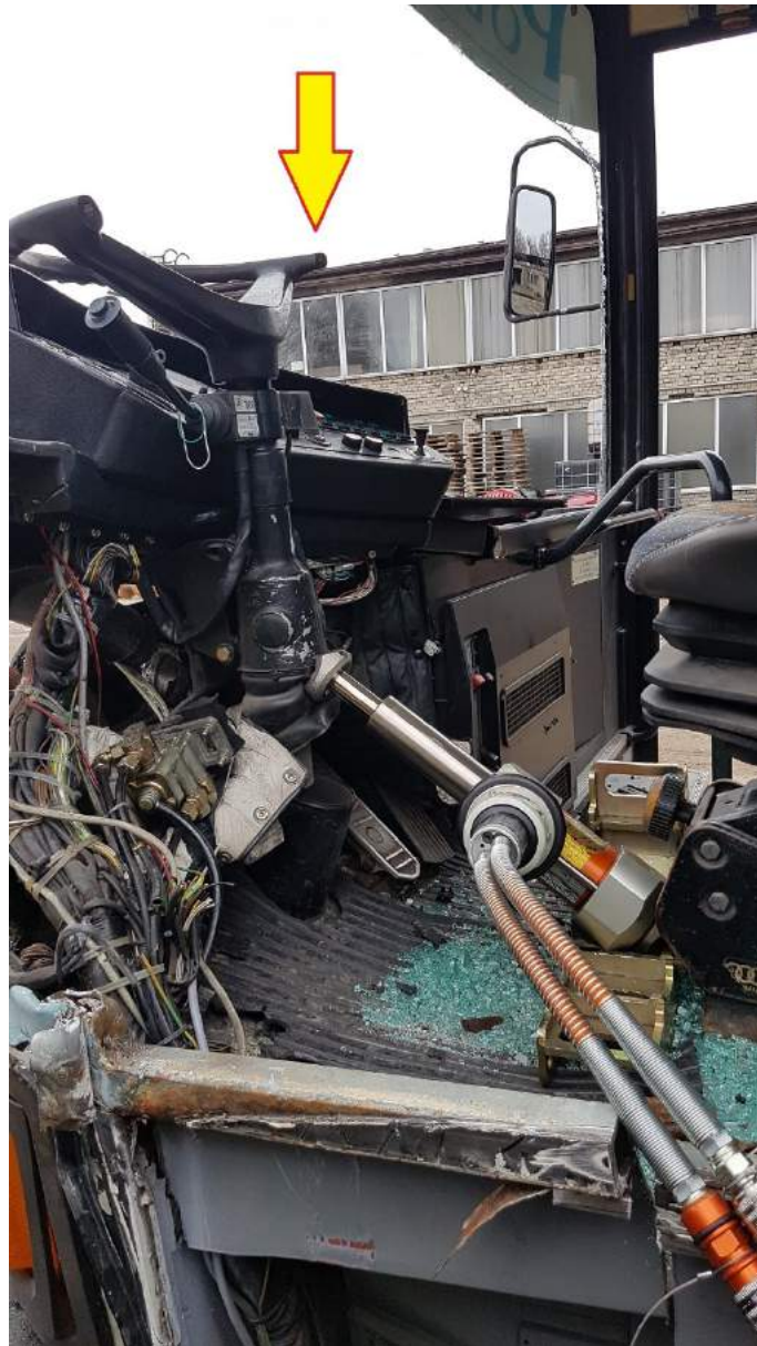
Rys. 414. Odepchnięcie kolumny kierownicy przy pomocy cylindra rozpierającego. Widoczne częściowe obciążenie koła kierownicy likwidujące ucisk na ciało kierowcy
