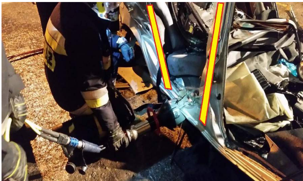
Rys. 239. Pojazd po uderzeniu w tył. Sytuacja przed rozpieraniem. Żółte linie pokazują występowanie słupka C i D. Wykonanie cięcia odprężającego w progu
