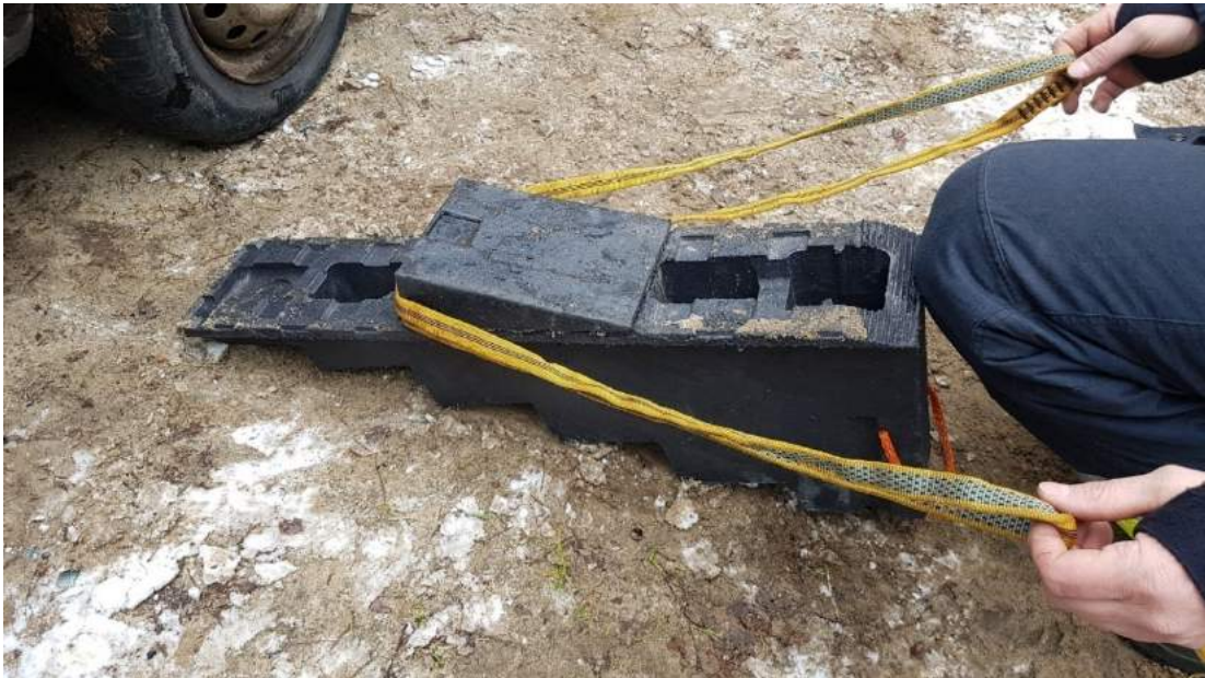
Rys. 151. Trzeci sposób wykorzystania klina schodkowego we współpracy z klinem
