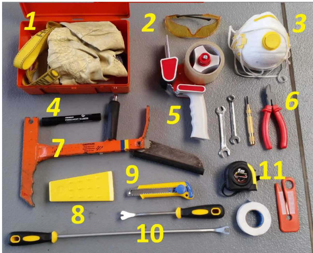
1 – Ostrona na kierownicę. 2 – Okulary ochronne. 3 – Maski pyłowe. 4 – Marker. 5 – Oklejarka. 6 – Klucze płasko-oczkowe, zbijak, cęgi boczne. 7 – Piła do szyb. 8 – Klin z tworzywa. 9 – Nóż. 10 – Chwytyki tapicerskie. 11 – Nóż do pasów, taśma izolacyjna, taśma miernicza
