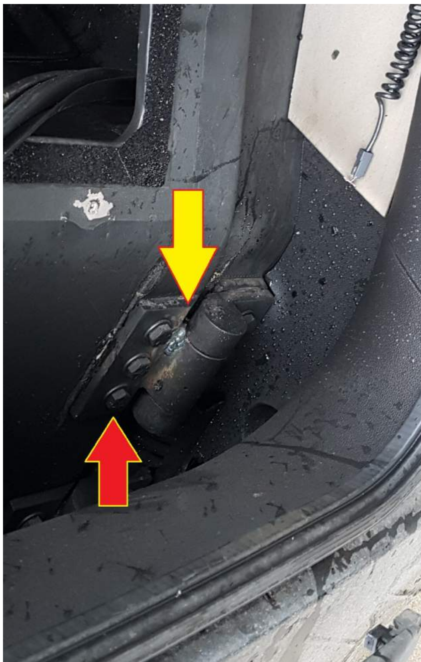
Rys. 460. Nieskuteczna próba przecięcia zawiasu palnikiem (żółta strzałka). Skuteczne okazało się rozkręcenie śrub zawiasów (czerwona strzałka)
