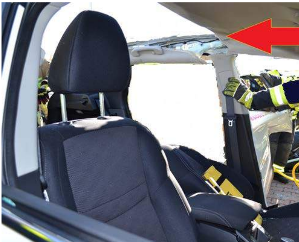
Rys. 264. Uwidocznione w wyniku rozpoznania wewnętrznego umiejscowienie generatora położonego obok słupka C uniemożliwiający użycie cylindra rozpierającego w tym miejscu
