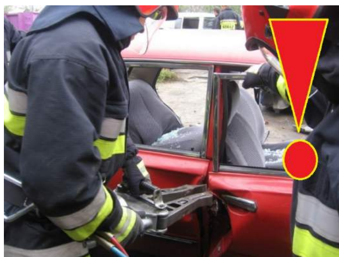
Rys. 11. Widoczny nieefektywny zgniot drzwi, w wyniku nieprawidłowego przyłożenia rozpieracza prostopadle do konstrukcji w poprzednim ruchu (brak kierunku siły powodującego wyrwanie drzwi)
