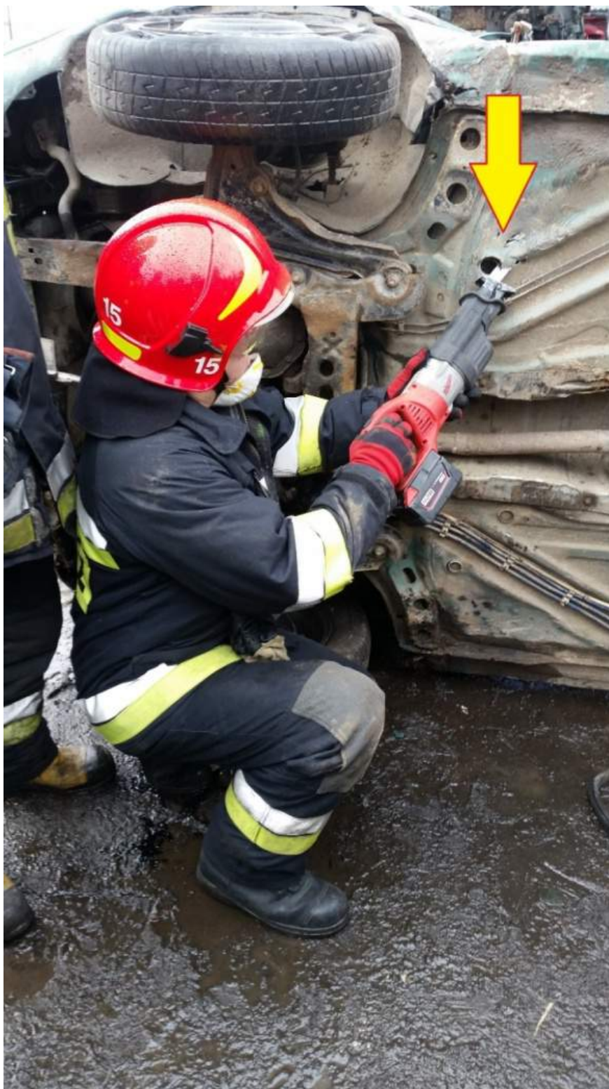
Rys. 219. Rozpoczęcie wykonania otworu w podłodze przy pomocy ostrza piły szablastej
