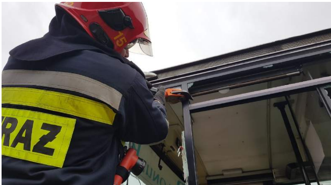
Rys. 405. Cięcie drobnych profili okiennych przy pomocy mini-nożyc
