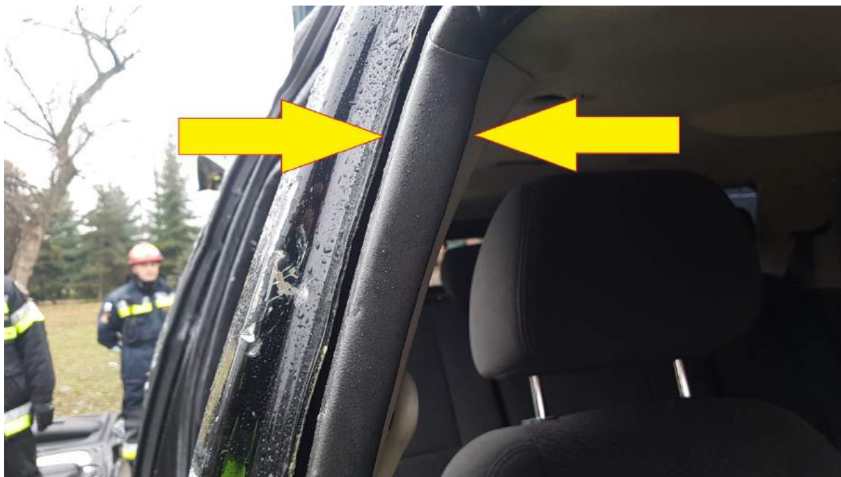
Rys. 449. Wewnętrzny szkielet balistyczny. Okolice słupka C
