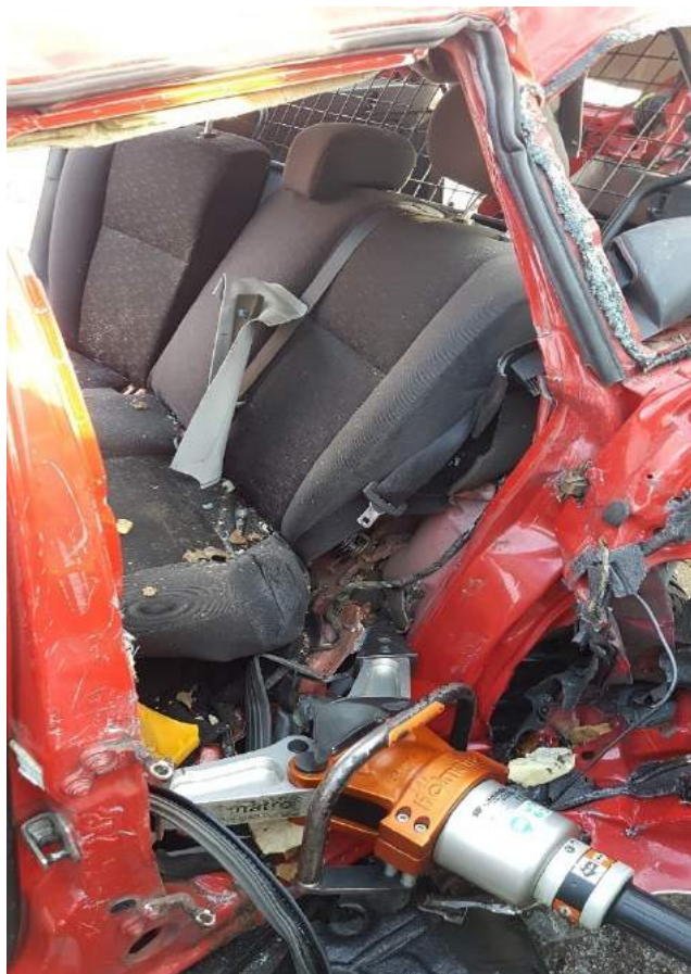
Rys. 238. Sytuacja po usunięciu drzwi i rozpieraniu przy pomocy rozpieracza
