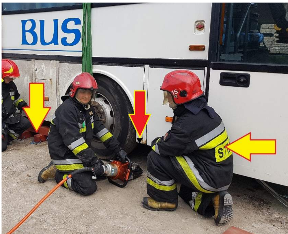
Rys. 424. Podnoszenie autobusu sprzętem hydraulicznym o punkt przeznaczony do lewarowania. Stabilizacja wspomagająca poprzez bieżącą podbudowę drewnem
