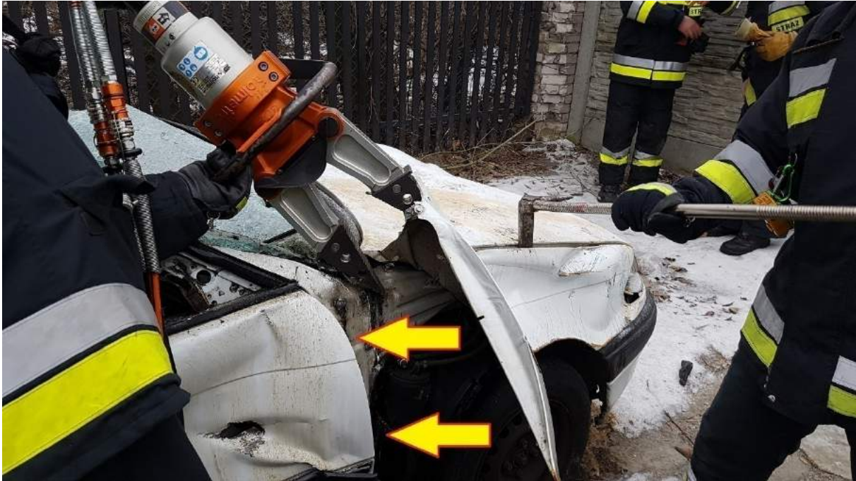
Rys. 248. Zdjęcie nadkola dające możliwość rozpoznania sytuacji pod spodem, ujawnienia miejsc, które należy przeciąć w niektórych technikach dostępu do nóg osób poszkodowanych oraz dające dostęp do zawiasów przednich drzwi
