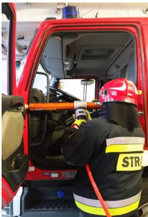
Rys. 340. Ustawienie cylindra rozpierającego przy wypychaniu przodu kabiny (zarówno bez nacięć odprężających, jak i z nimi)
