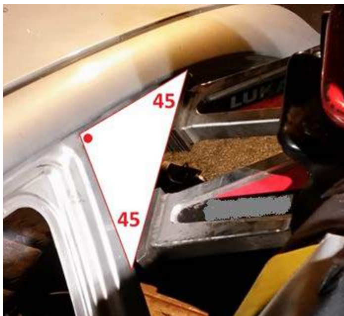
Rys. 267. Rozpierzacz umieszczamy tak, aby dach i słupek umieszczone były pod kątem 45 stopni do ramion
