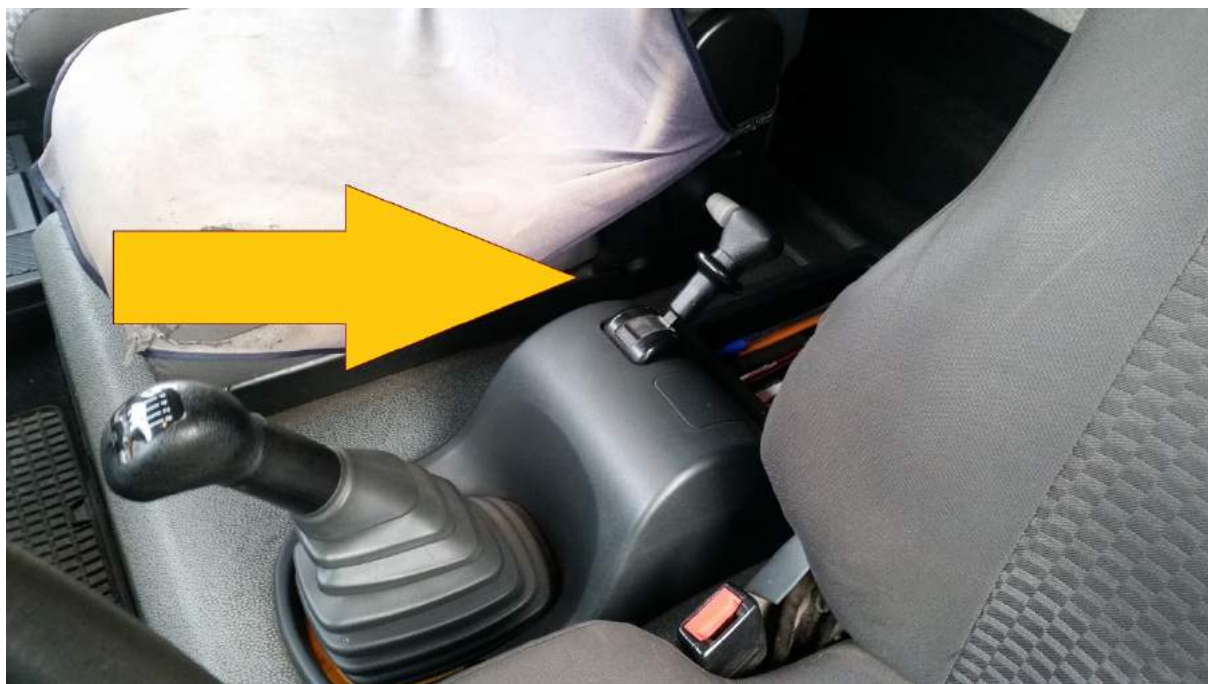
Rys. 102. Dźwignia hamulca postojowego przy drążku zmiany biegów
