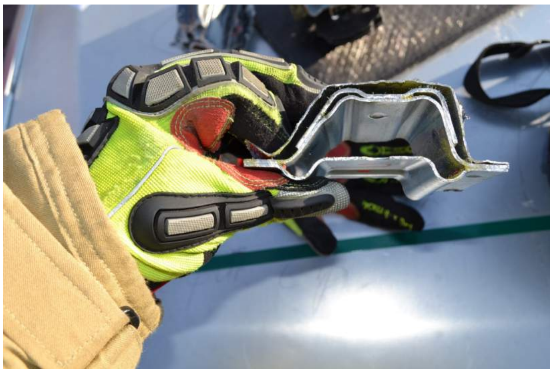
Rys. 57. Profil ze stali o podwyższonej wytrzymałości, która mogłaby uniemożliwić przecięcie nożycami
