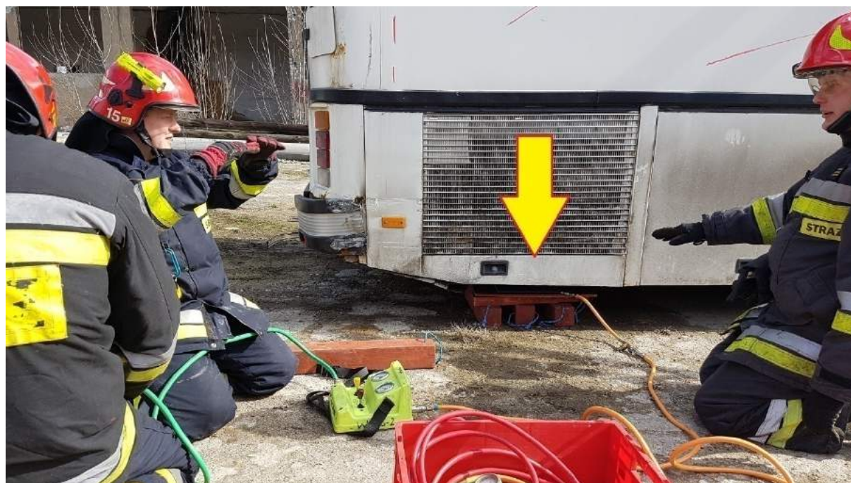
Rys. 425. Podnoszenie autobusu sprzętem pneumatycznym
