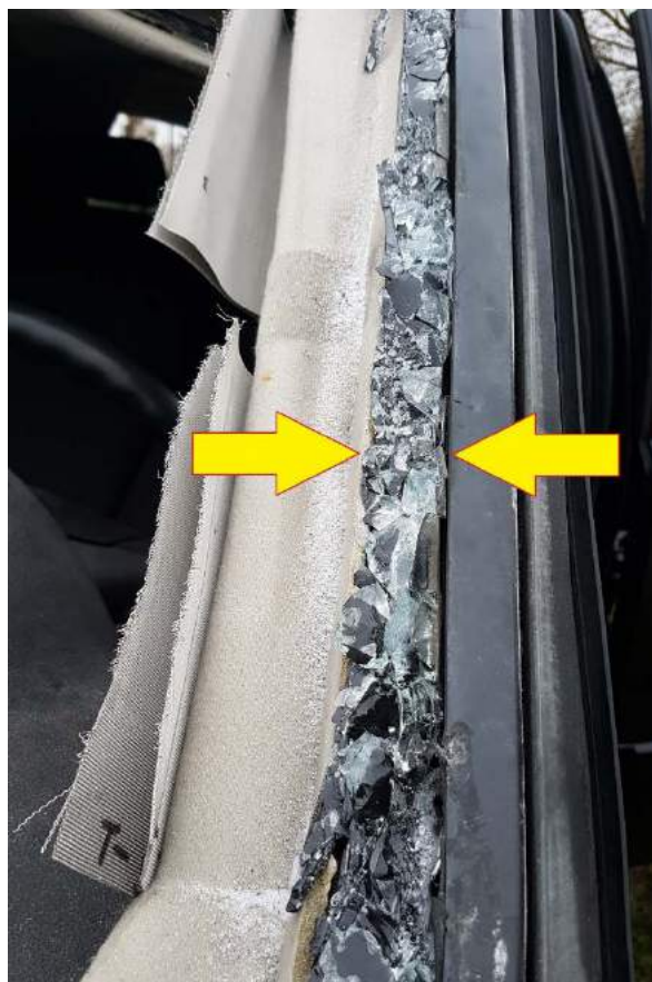
Rys. 453. Grubość szyby przedniej
