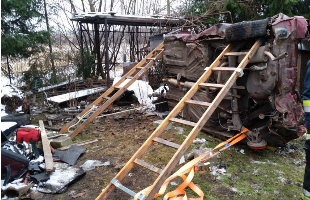
Rys. 296. Zastosowanie przesł drabiny nasadkowej do stabilizacji we współudziale linki oraz pasa z naciągiem
