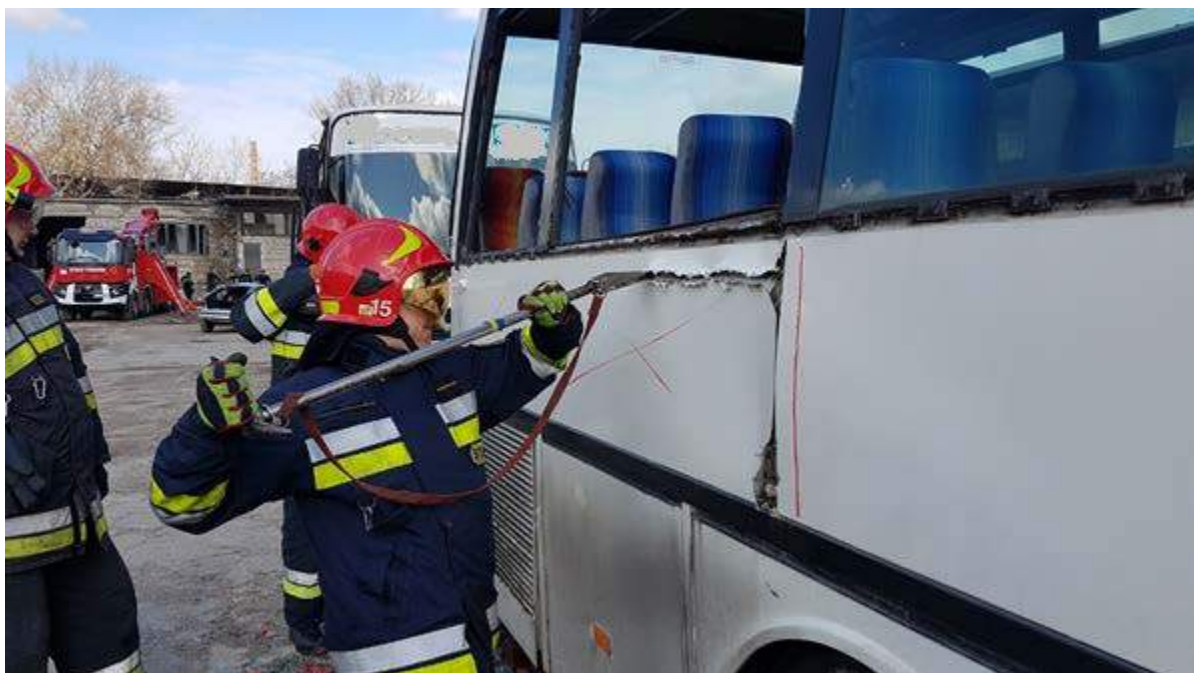
Rys. 403. Cięcie poszycia narzędziem halligan z końcówką tnącą
