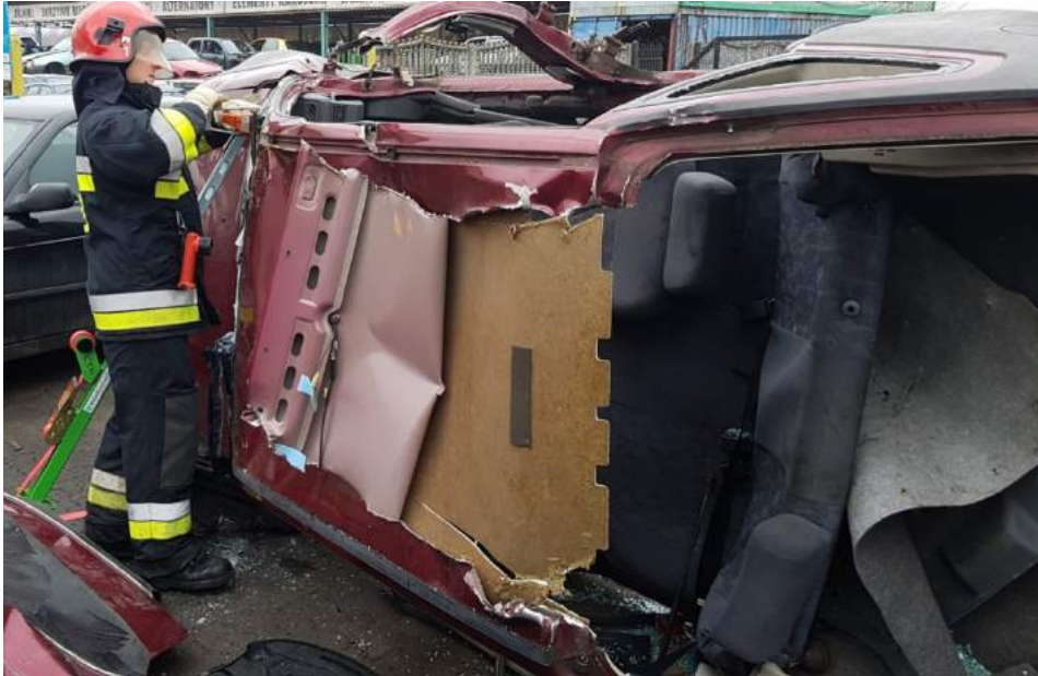
Rys. 299. Wykonanie techniki tunelowania w samochodzie typu sedan w pozycji na boku
