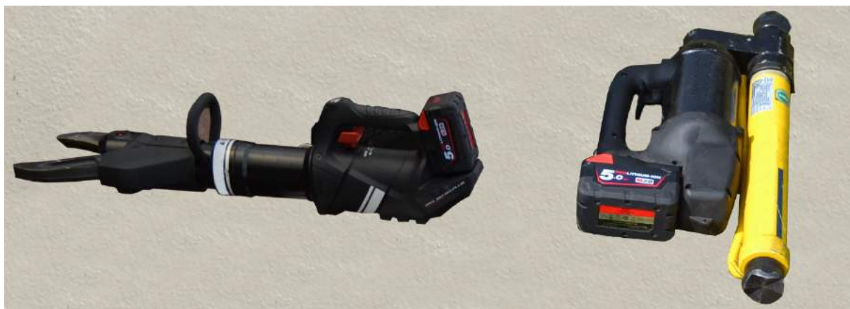
Rys. 22. Narzędzia o zintegrowanym napędzie elektrycznym (akumulatorowym)
