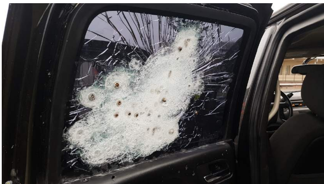
Rys. 452. Szyba boczna, wytrzymała ostrzał z broni palnej
