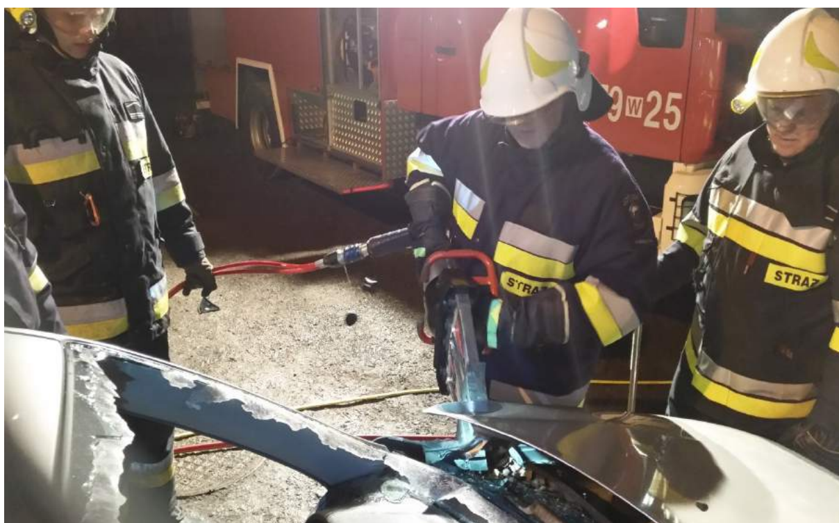
Rys. 328. Wyrwanie zawiasów maski przy pomocy rozpieracza
