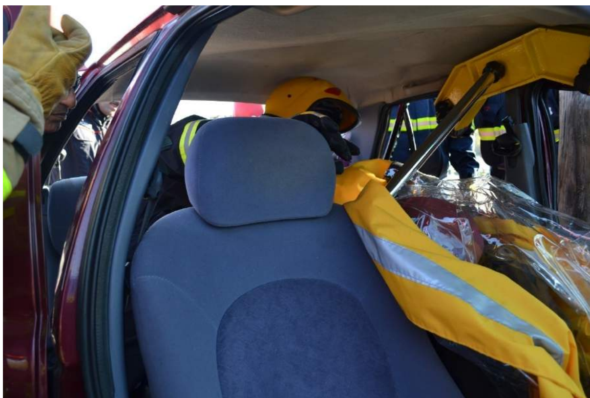
Rys. 225. Cross-ramming wykonywany pod kątem. Wyparcie o płaski wspornik
