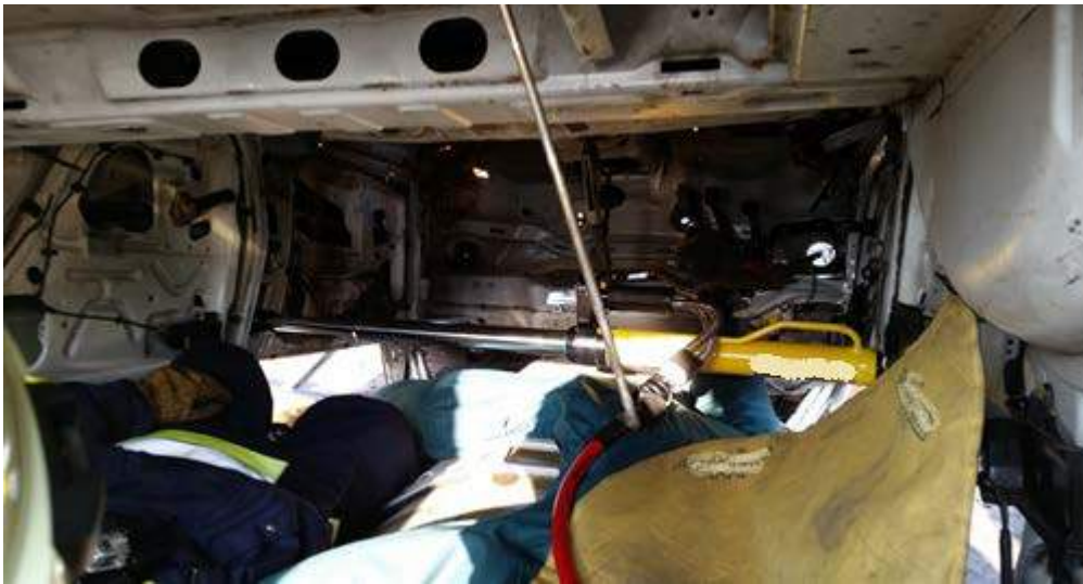
Rys. 307. Technika cross-ramming w pojeździe na dachu
