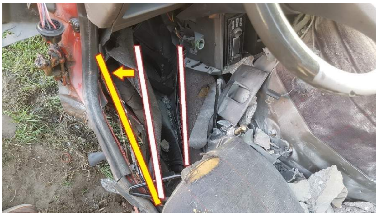
Rys. 236. Sytuacja po rozpieraniu. Białe linie pokazują, gdzie znajdował się tunel środkowy i próg pojazdu. Żółta strzałka i linia pokazują kierunek rozpierania, które uwolniło stopy poszkodowanego
