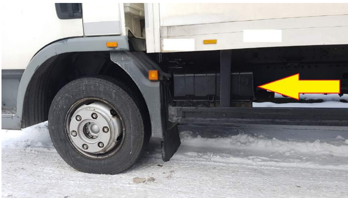
Rys. 91. Akumulatory pod pokrywą, zamontowane na ramie, zaraz za kabiną
