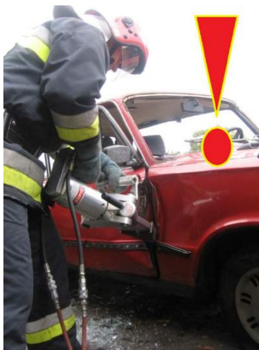
Rys. 10. Przyłożenie rozpieracza prostopadle do konstrukcji powoduje zgniot nadkola i drzwi, bez uzyskania efektu ich wyrwania. Powoduje to wręcz postępujące zakleszczenie
