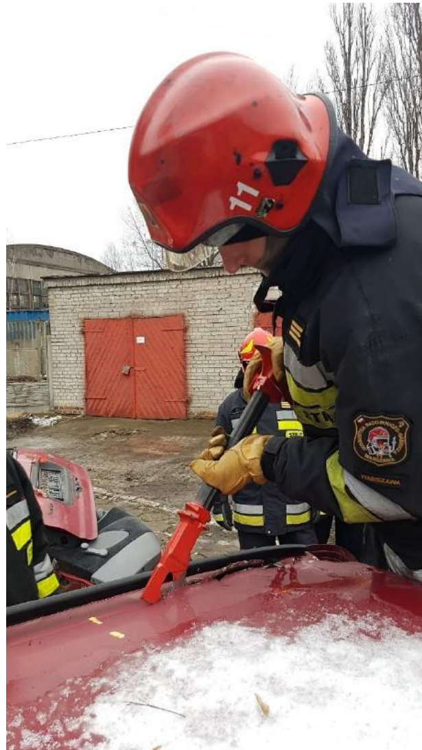
Rys. 288. Cięcia wzdłużne przy użyciu inopora
