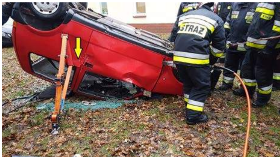
Rys. 305. Prawidłowe wyparcie głowicy o płaski, metalowy element. Ściąganie pasa dodatkowo dociąga ją do konstrukcji auta. Wykonywany dostęp boczny
