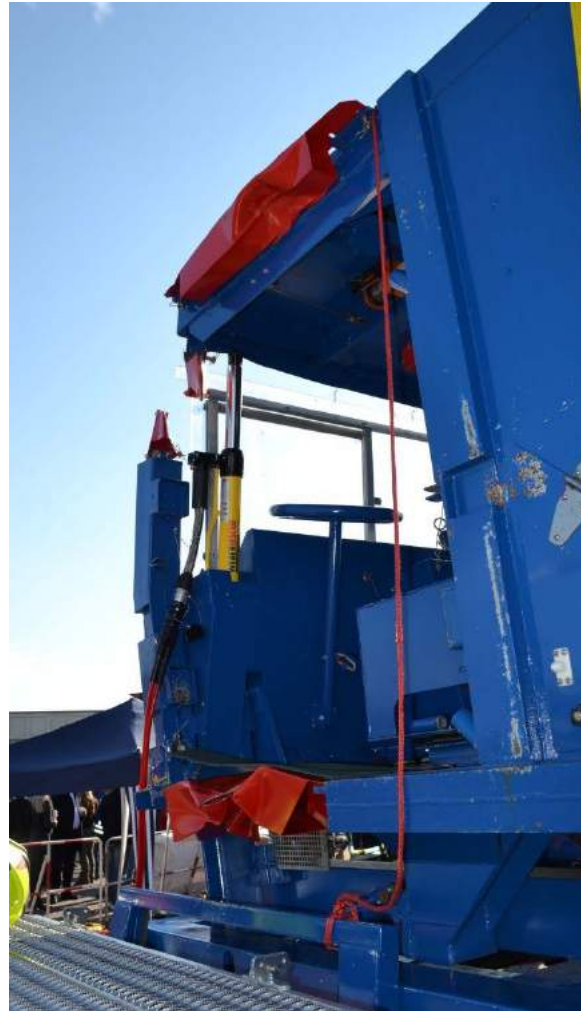
Rys.345. Wypychanie dachu kabiny przy pomocy cylindra rozpierającego
