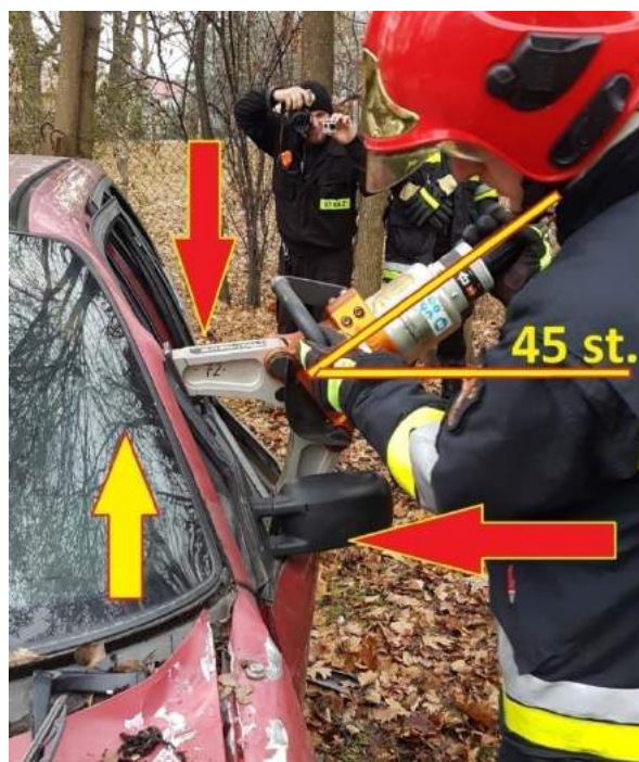
Rys. 12. Przyłożenie rozpieracza pod kątem 45 stopni. W wyniku wykorzystania odpowiedniego kierunku działania siły, jedno ramię wrywa drzwi do zewnątrz. Drugie ramię tworzy podstawę. Siły w tym miejscu nie są duże (nie powodują nawet pęknięcia szyby)
