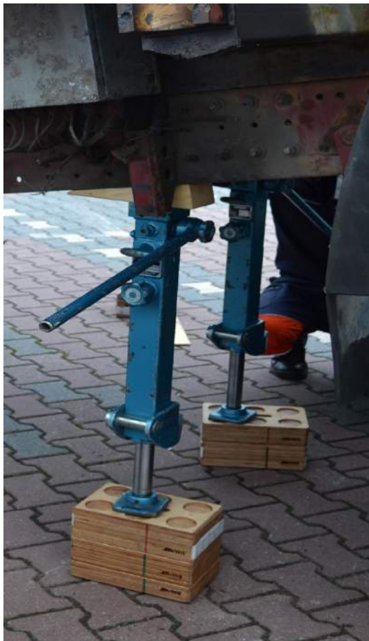
Rys. 376 A, B. Podnoszenie ciężarówki lewarami hydraulicznymi i cylindrem rozpierającym pod ramą pojazdu
