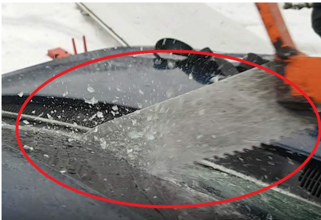
Rys. 179. Różne frakcje pyłu szklanego podczas cięcia szyby klejonej
