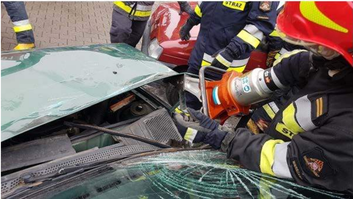
Rys.329. Wyrwanie zawiasów maski przy pomocy rozpieracza
