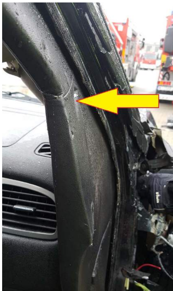
Rys. 451. Wewnętrzny szkielet balistyczny. Okolice słupka A
