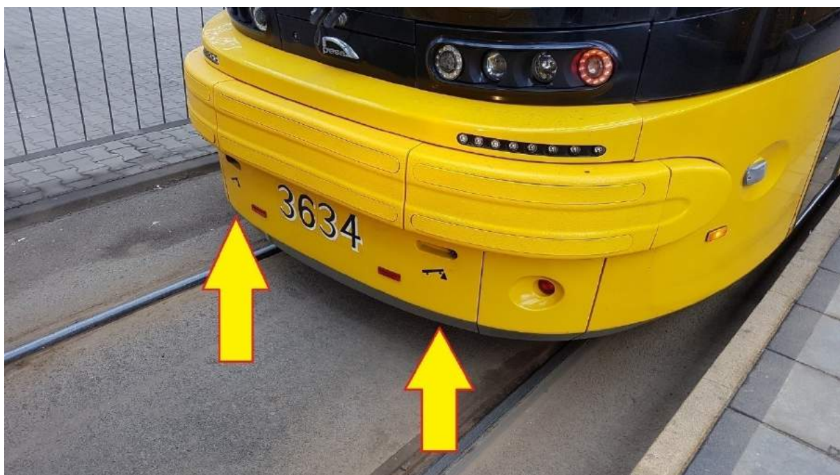
Rys. 430. Zaznaczone punkty do podnoszenia wagonu
