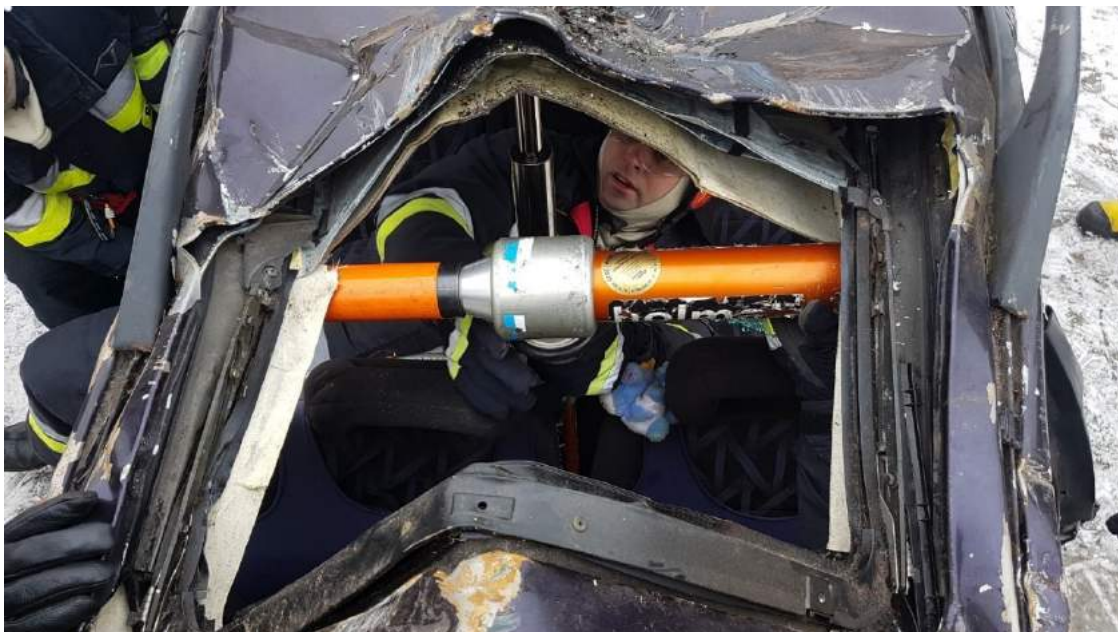
Rys. 230. Cross-ramming wykonywany dwoma cylindrami rozpierającymi, między słupkami C-C oraz w pionie (ważna podbudowa dachu i ewentualnie podłogi)
