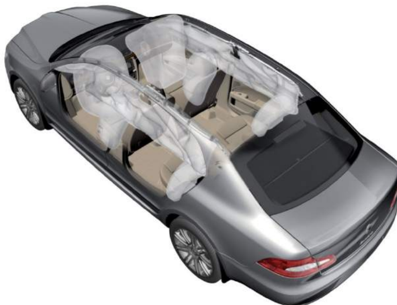
Rys. 61. Umiejscowienie poduszek bezpieczeństwa. Skoda Octavia 2016 r.
