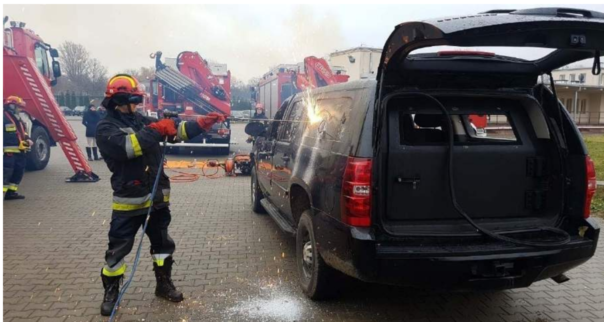
Rys. 464. Nieskuteczna próba przecięcia szyby palnikiem (lancą tlenową)
