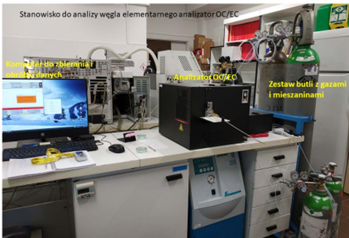
Fot. 2. Stanowisko do analizy węgla elementarnego za pomocą analizatora termooptycznego z detektorem płomieniowo-jonizacyjnym [źródło własne]
