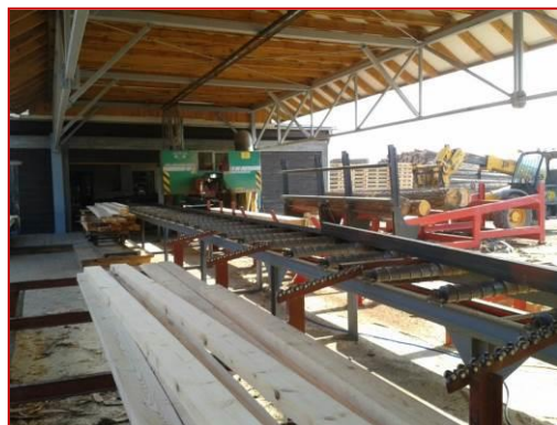
Zdjęcie. Wiata – Trak MEBOR taśmowy z odciągami na trociny i podajnik wzdłużny na kłody w tartaku.
