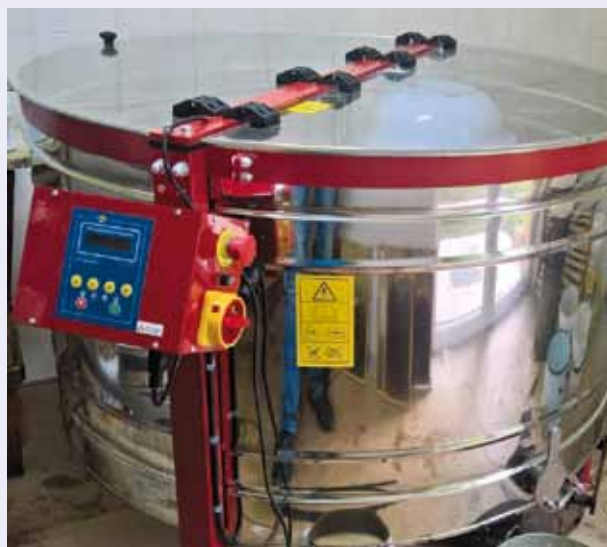
MIODARKA – URZĄDZENIE DO ODWIROWYWANIA MIODU Z PLASTRÓW PSZCZELICH W GOSPODARSTWIE SŁAWOMIRA TRZYBIŃSKIEGO ■ HONEY EXTRACTOR – A DEVICE TO CENTRIFUGE HONEY FROM HONEYCOMBS ON THE FARM OF SŁAWOMIR TRZYBIŃSKI
