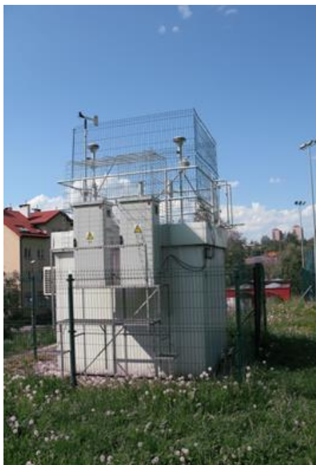
Rys. 3. Stacja monitoringu jakości powietrza w Krakowie przy ul. Bujaka, na której prowadzone są m.in. manualne i automatyczne pomiary pyłu PM10 i PM2,5. (autor zdjęcia B. Toczko).
