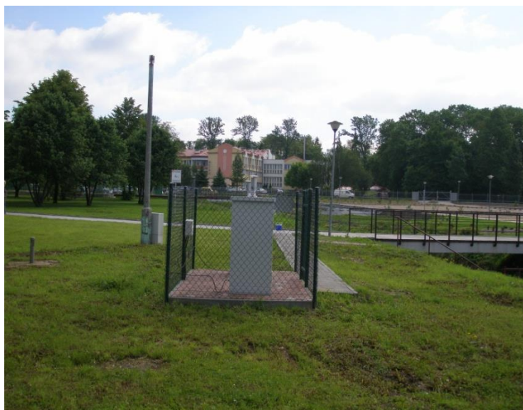
Rys. 5. Pobornik do pomiarów pyłu zawieszzonego PM10 w Busku Zdroju. (autor zdjęcia B. Toczko).
