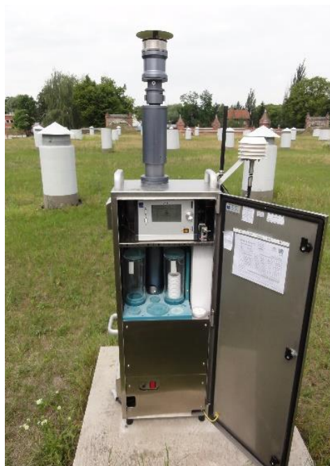
Rys. 4. Pobornik do pomiarów pyłu zawieszzonego PM2,5 we Wrocławiu przy ul. Na Grobli. (autor zdjęcia B. Toczko).
