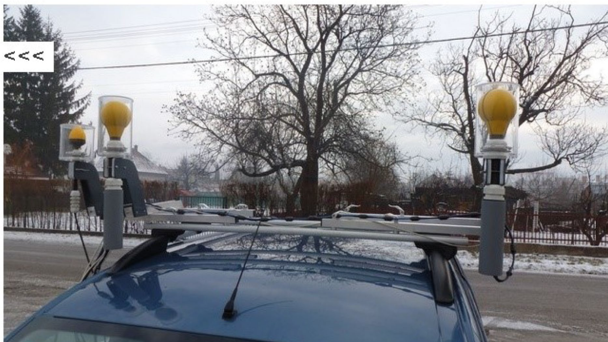
Rys. 27 Umieszczenie anten pomiarowych na dachu samochodu – monitoring na Słowacji
