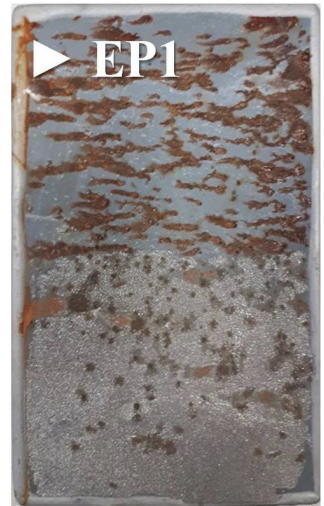
Epoksydowa powłoka wysokocynkowa (handlowa)
