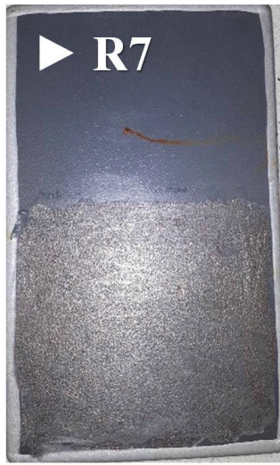
Powłoka z pyłem Zn i nanorurkami węglowymi CNT (R7)
