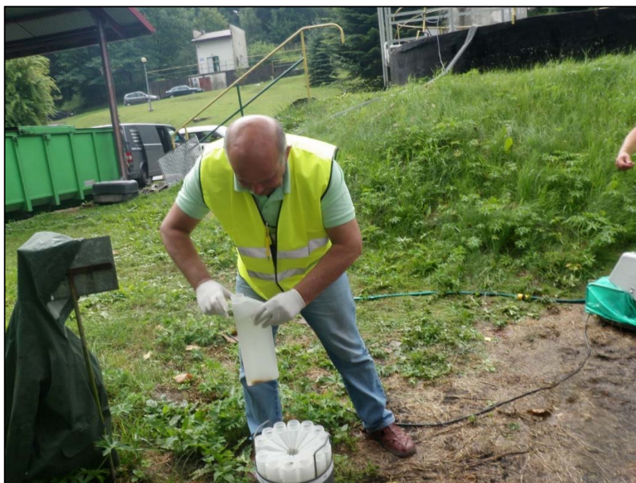
Ryc. 1. Pobór próbek ścieków odpływających z oczyszczalni w Polańczyku wykonany przez Laboratorium WIOŚ w Rzeszowie z użyciem sprzętu do poboru próbek zakupionego w ramach Programu Operacyjnego „Infrastruktura i Środowisko”. Polańczyk, 2015-07-15.
