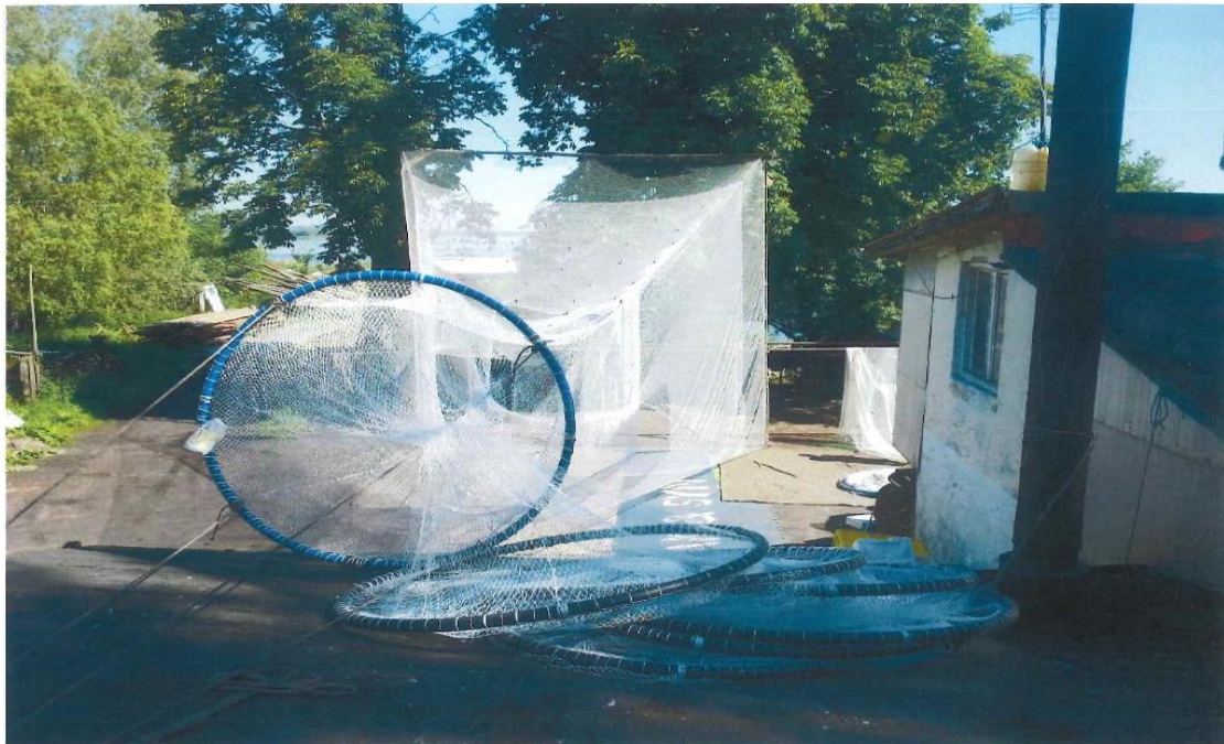
Fot. 7. Widok „od tyłu” alhama. Kwadratowy wlot, zszyte cztery kliny tworzące skrzydła i pierwsza obręcz matni.
