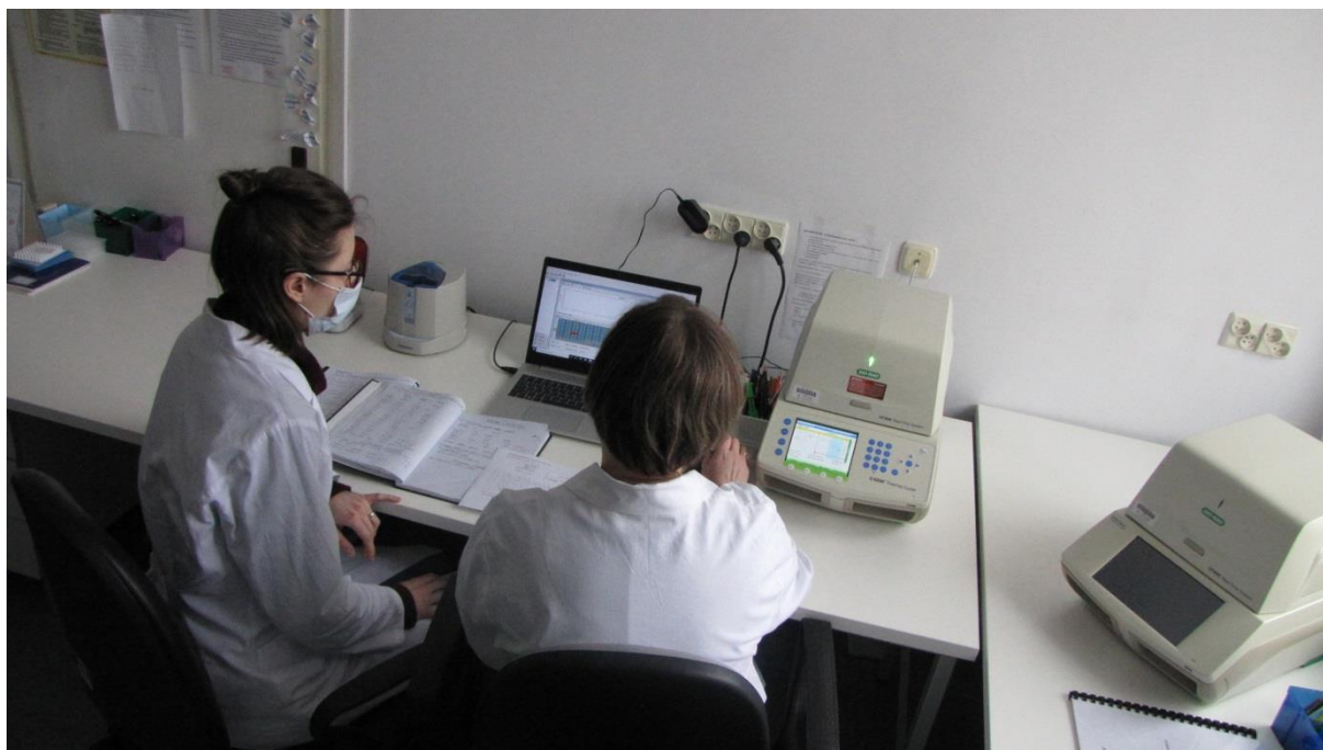
Etap amplifikacji i odczytu analizy na aparacie CFX96 firmy BioRad Fot.: Kamil Mrozowicz
