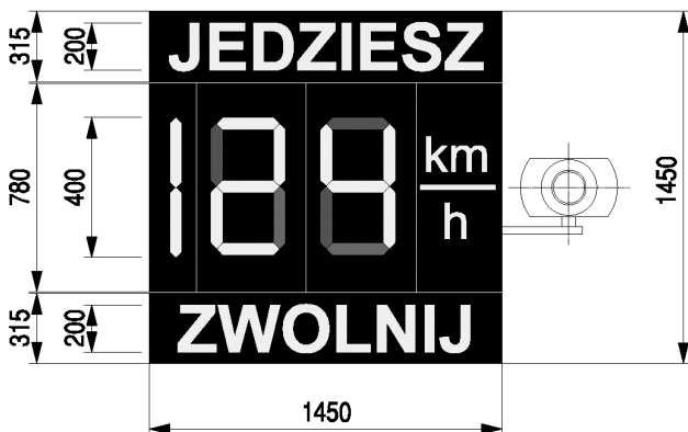
Rys. 13.6.1. Przykładowy wyświetlacz prędkości rzeczywistej z detektorem radarowym
