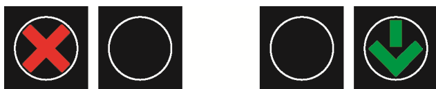
Rys. 4.2.10. Sygnalizator S-4 z sekwencją sygnałów nad pasami o przemiennym kierunku ruchu
