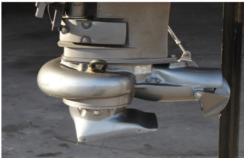
Fotografia nr 4.6. Pędnik strugowodny silnika zaburtowego
