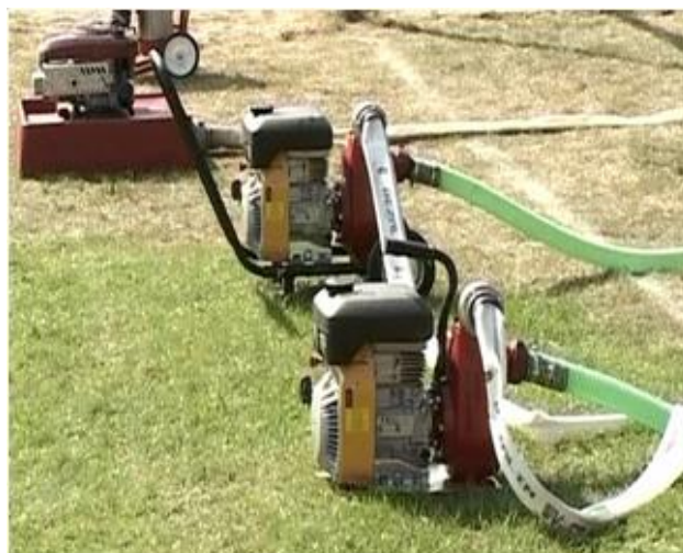
Fotografia nr 3.5. Małe motopompy do pompowania zanieczyszczonej wody z piwnic budynków. Posiadają silniki czterosurowe i otwarte wirniki, które nie są zatykane przez zanieczyszczenia. Posiadają wydajność 400 do 800 l/min, która spada przy wzroście oporów dławienia linii tłocznej i wysokości ssania. Nadają się do odpompowywania studni do głębokości ok. 7.5 m (wynikającej z ciśnienia atmosferycznego)
