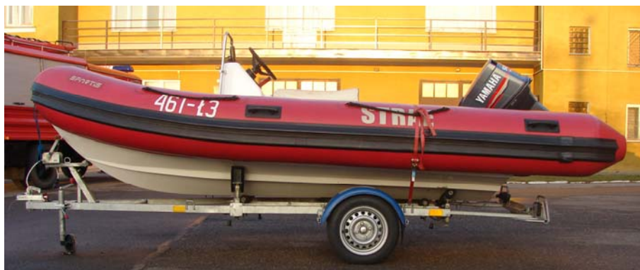
Fotografia nr 4.4. Łódź ratownicza o konstrukcji hybrydowej
