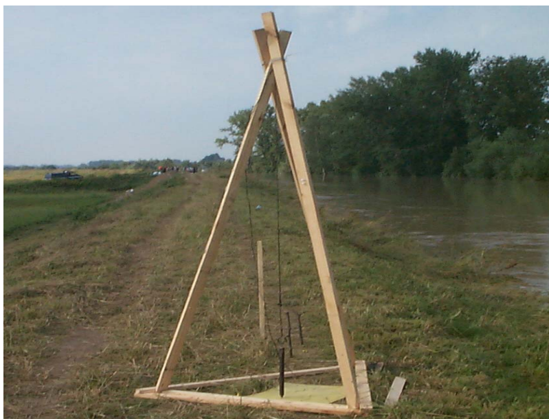
Fotografia nr 2.5. Prowizoryczny przyrząd do badania ruchów wału
