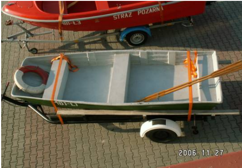
Fotografia nr 4.1. Łodzie z kadłubami sztywnymi wykonane z kompozytu (włókno i żywica)
