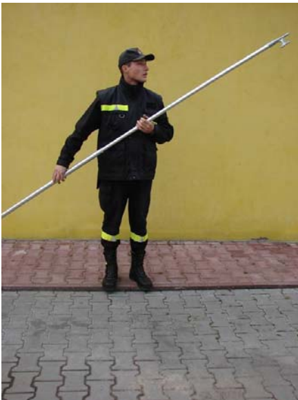
Fotografia nr 4.18. Bosak metalowy teleskopowy
