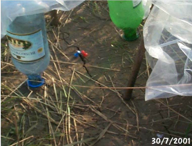
Fotografia nr 2.4. Prosty sposób obserwacji powiększania się szczeliny
