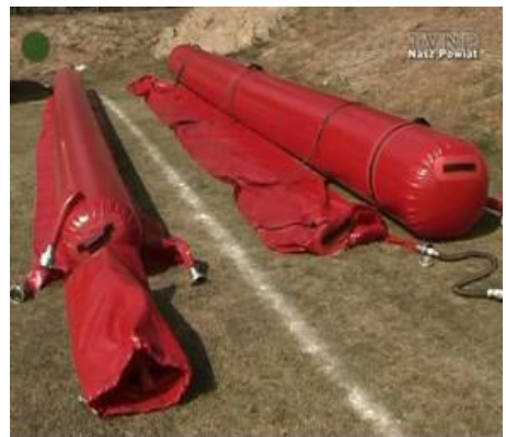
Fotografia nr 2.9. Zapory przeciwpowodziowe napelniane wodą
