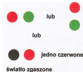
A.11. Zakaz przejścia - przygotować się do wejścia lub przejścia jedno czerwone światło zgaszone
