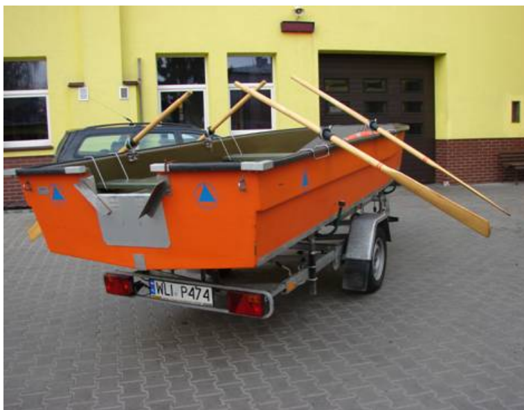
Fotografia nr 8.13. Duża płaskodenna łódź ratownicza odpowiednia do transportu zaopatrzenia
