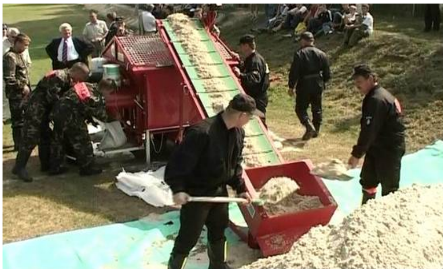
Fotografia nr 2.17. Mechaniczna pakowarka piasku, w czasie napełniania worków
