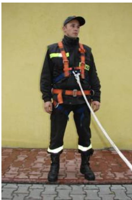
Fotografia nr 9.5 Szelki ratownicze z linką
