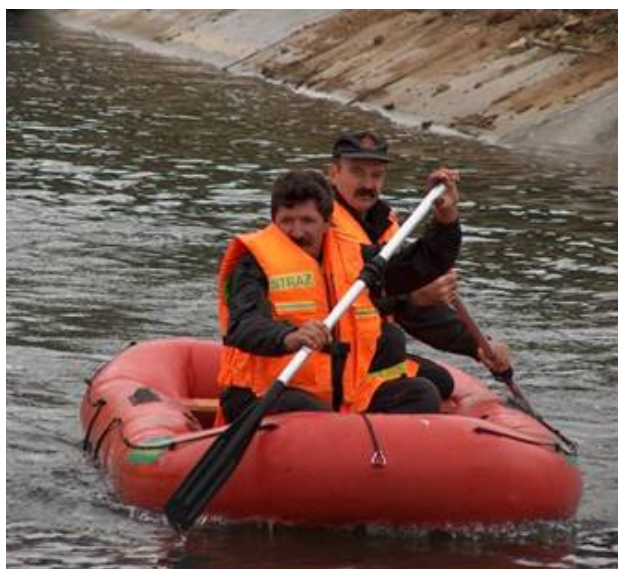
Fotografia nr 4.3. Mała łódź pneumatyczna. Może służyć do celów pomocniczych. Nie nadaje się do pracy na wodach szybko płynących, ani działań na terenie powodziowym. Może służyć jako zabezpieczenie działań na lodzie.
