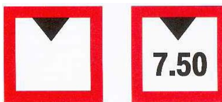
C.2. Ograniczona wysokość prześwitu nad zwierciadłem wody
