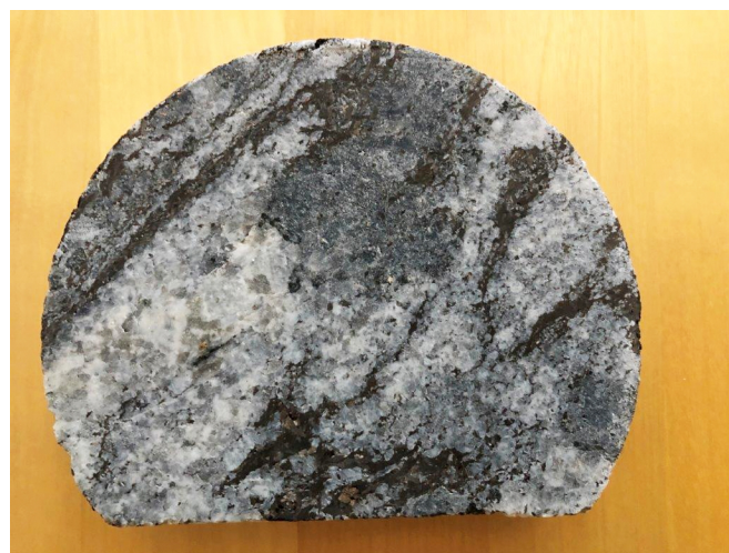
Fot. 1. Gnejs, w którym budowane jest składowisko geologiczne Onkalo (rdzeń wiertniczy o średnicy 12 cm) (Fot. autora).
