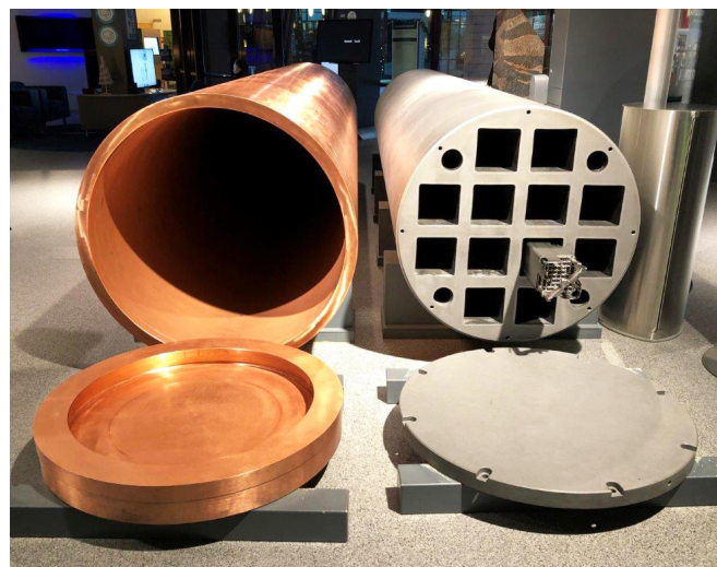
Fot. 2. Pojemnik do składowania zużytego paliwa jądrowego złożony z żeliwnego korpusu z otworami na kasety z prętami paliwowymi (po prawej) i miedzianej osłony, eksponowany w centrum informacyjnym EJ Olkiluoto (fot. autora).
