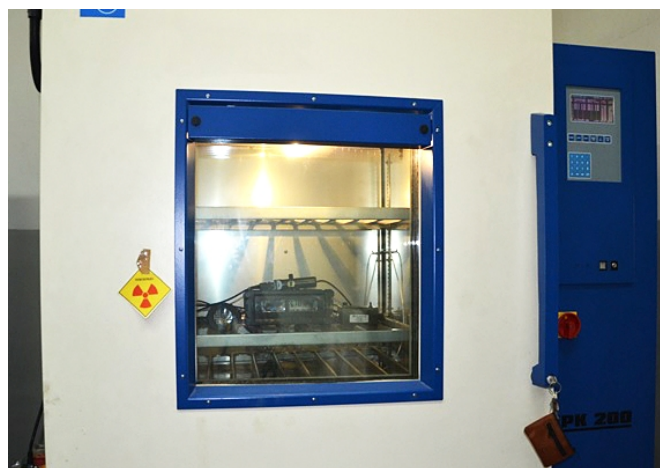
Rys. 9. Przyrząd podczas badań klimatycznych (materiały własne WICHiR).
