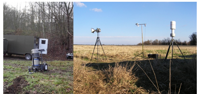
Rys. 13. Pomiary dozymetryczne w terenie. Po lewej stronie – polowy zestaw do badań spektrometrycznych, po prawej stronie – polowy zestaw do środowiskowych pomiarów dozymetrycznych (autor: Marek Natora – opracowanie własne WICHiR).
