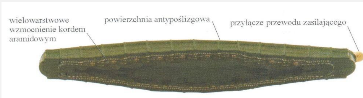
Rysunek nr 6. Budowa siłownika pneumatycznego wysokociśnieniowego [1,2,3].
