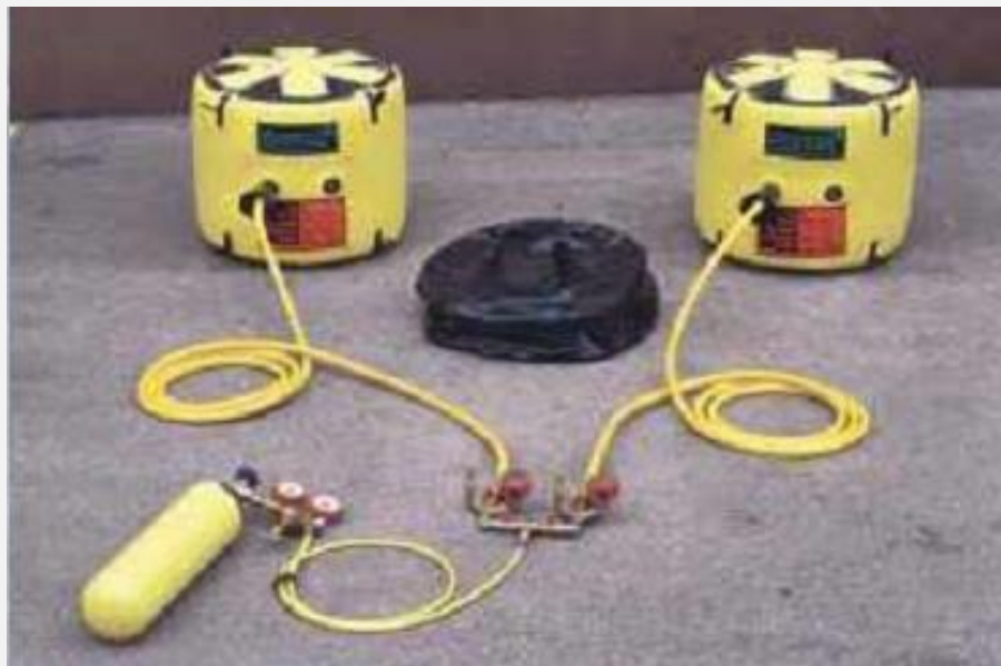
Rysunek nr 16. Złożony zestaw ratowniczy pneumatyczny niskociśnieniowy [1,2,3].
