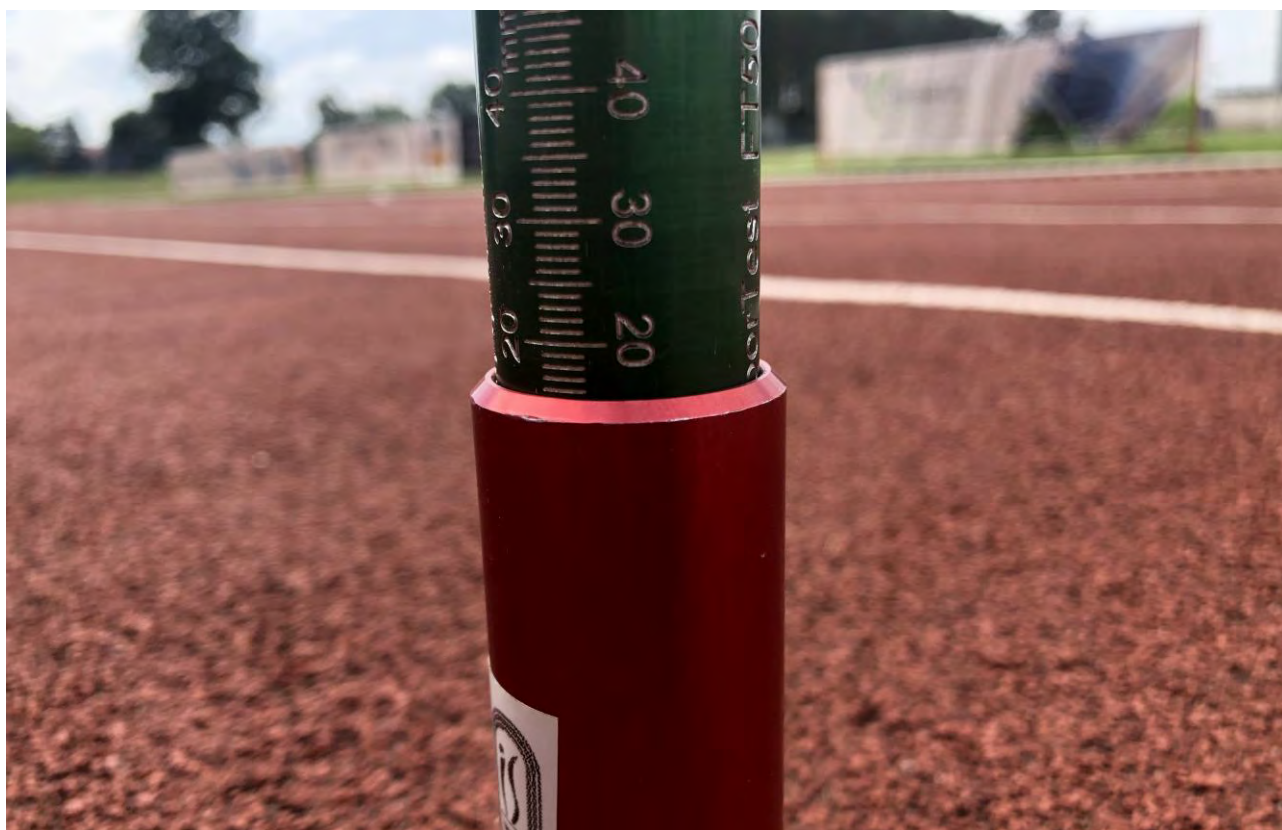
Fot. 3 Pomiar grubości nawierzchni
