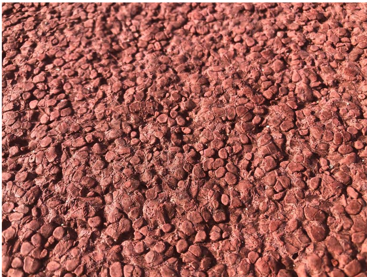
Fot. 19 Przykład nawierzchni syntetycznej z użytym wadliwym granulatem EPDM
