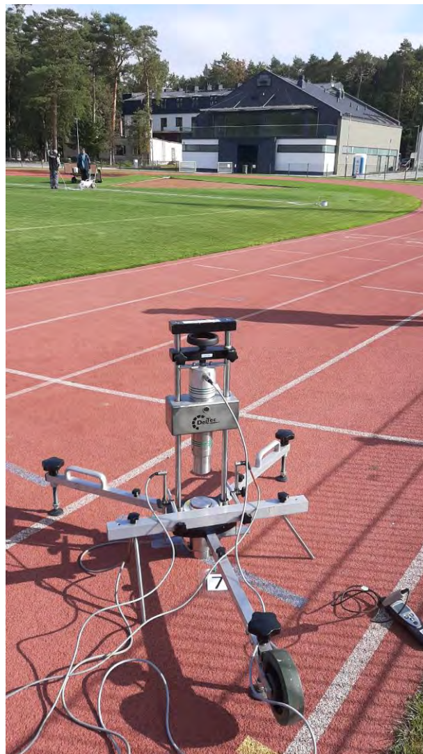
Fot. 8 Badanie amortyzacji siły i odkształcenia pionowego
