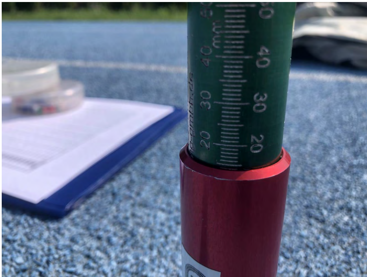
Fot. 4 Badanie grubości nawierzchni
