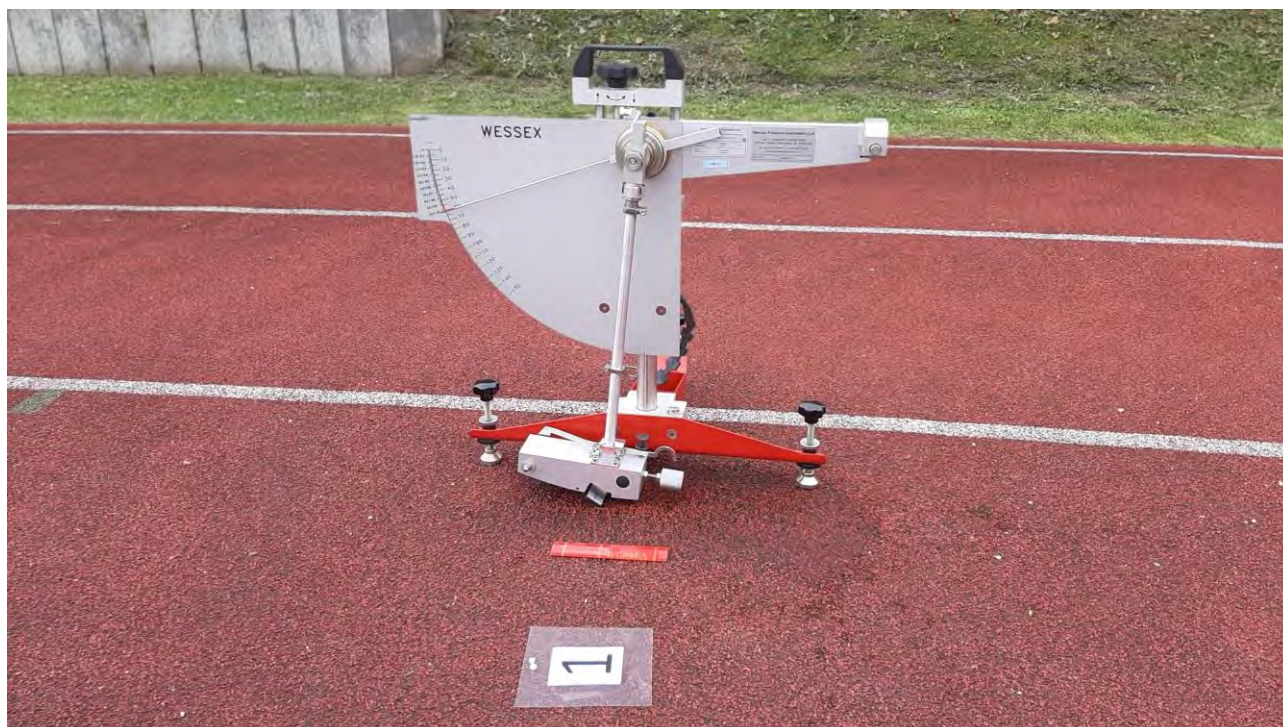
Fot. 3 Badanie oporu poślizgu w punkcie nr 1
