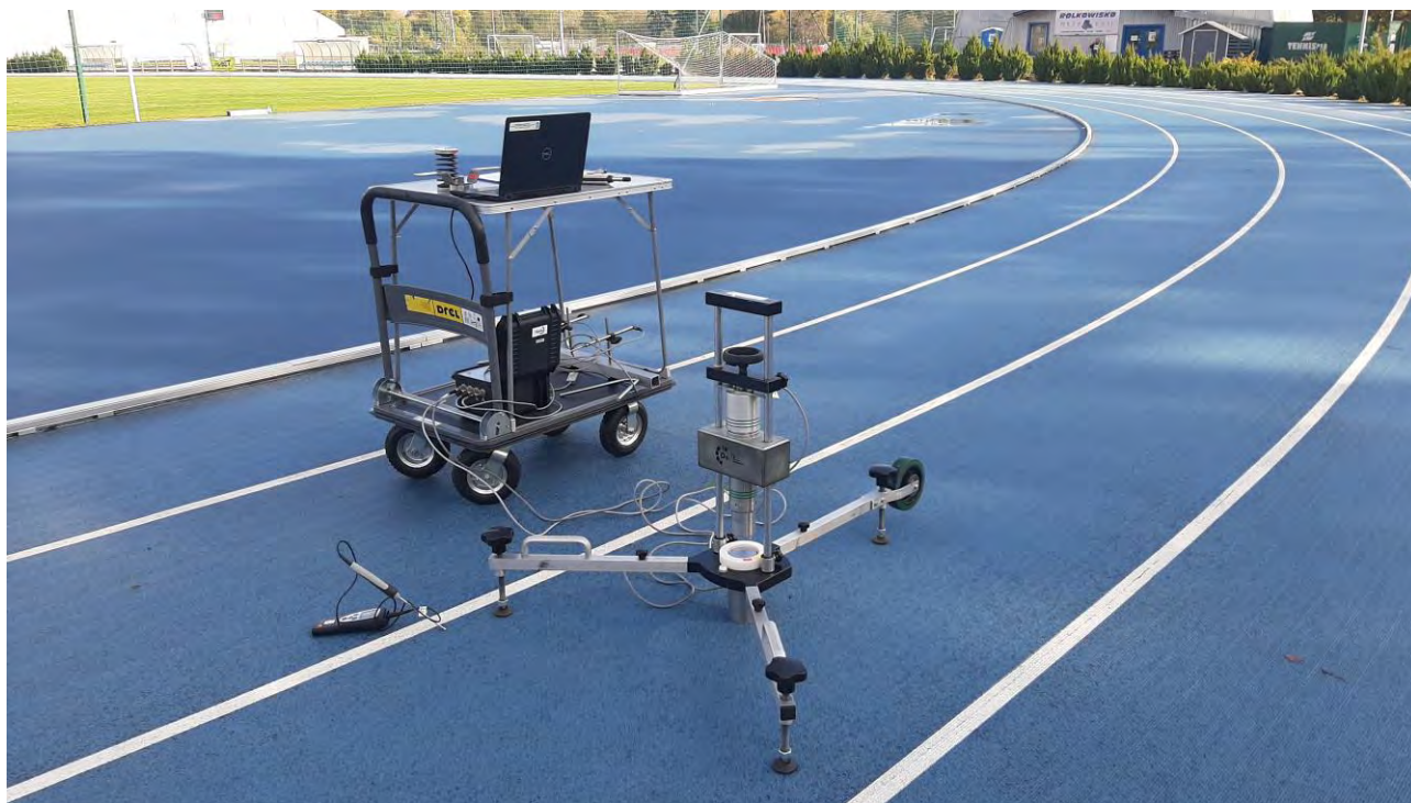
Fot. 3 Badanie amortyzacji siły w punkcie nr 1
