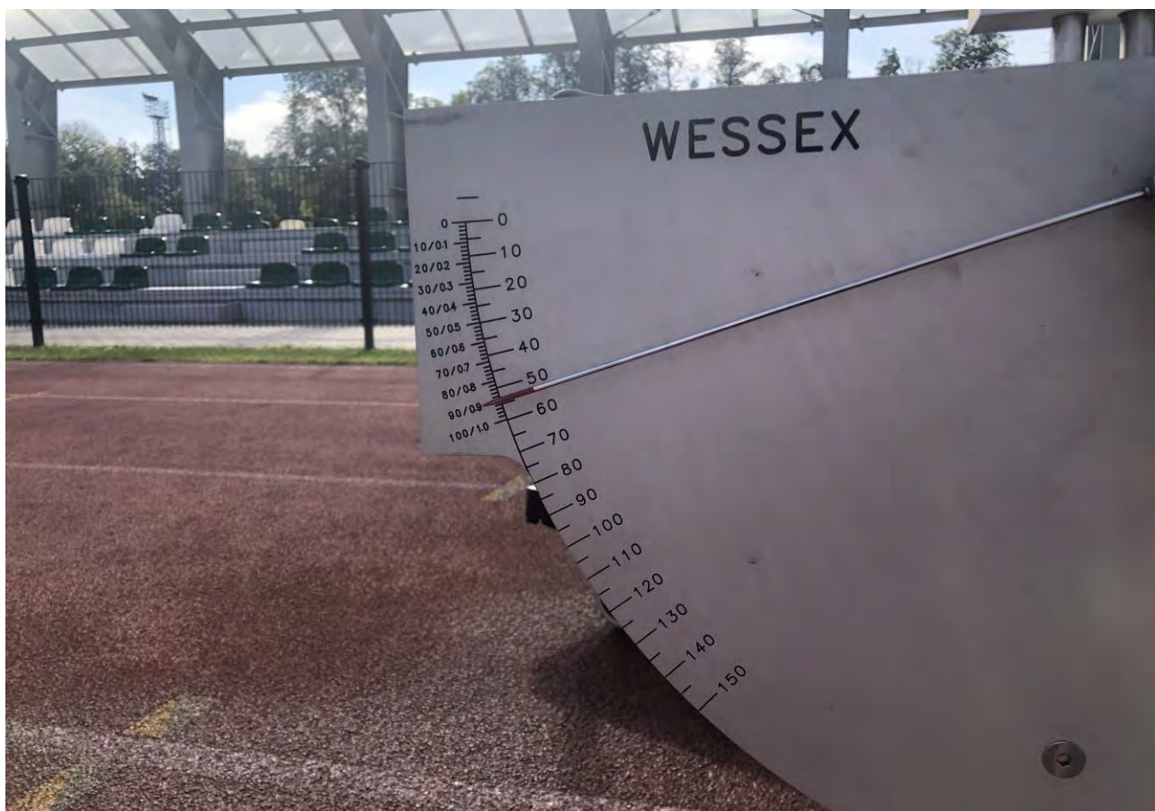
Fot. 6 Wynik badania oporu poślizgu na głównej prostej
