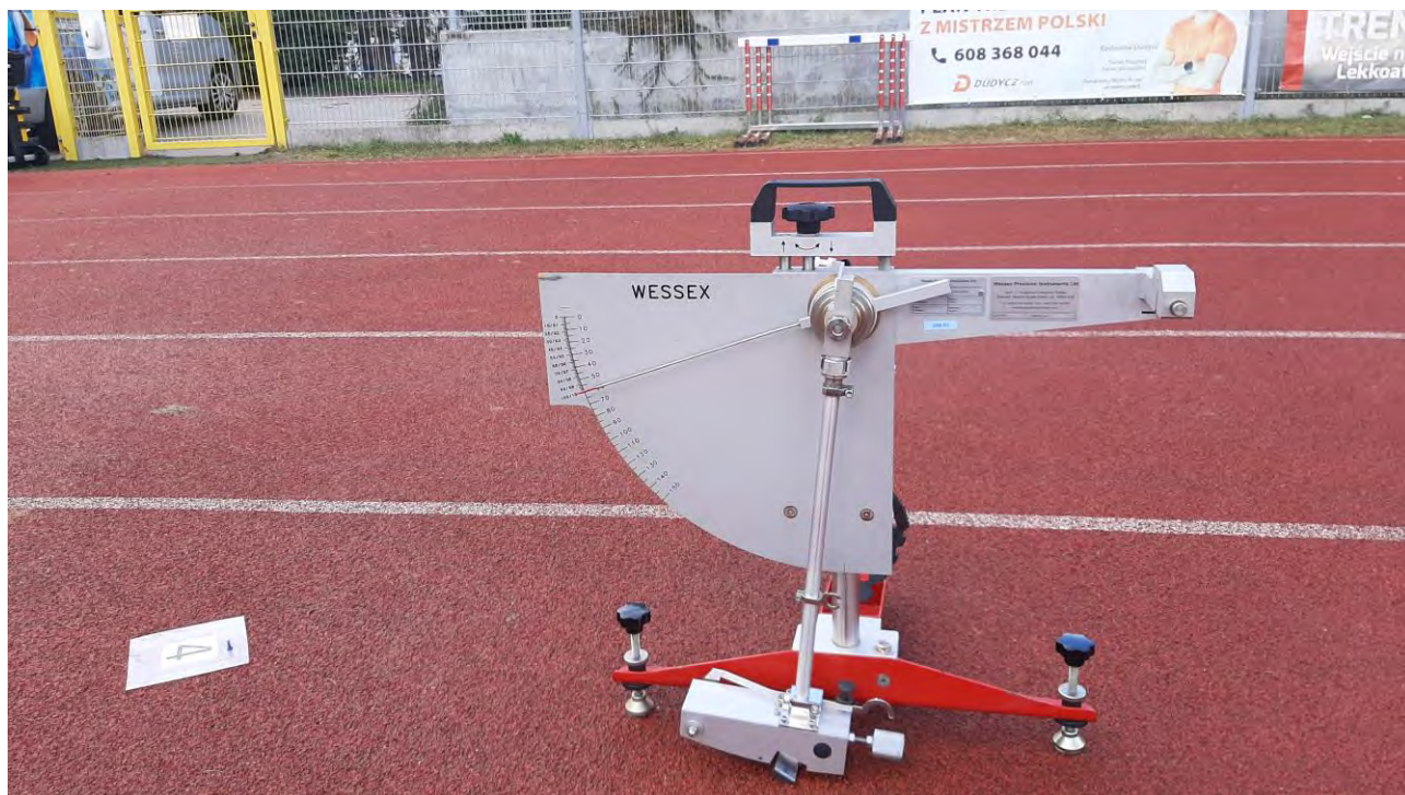
Fot. 3 Badanie oporu poślizgu w punkcie nr 4
