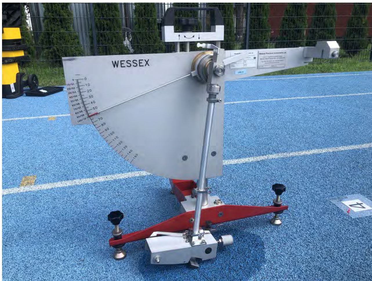
Fot. 3 Badanie oporu poślizgu na nawierzchni
