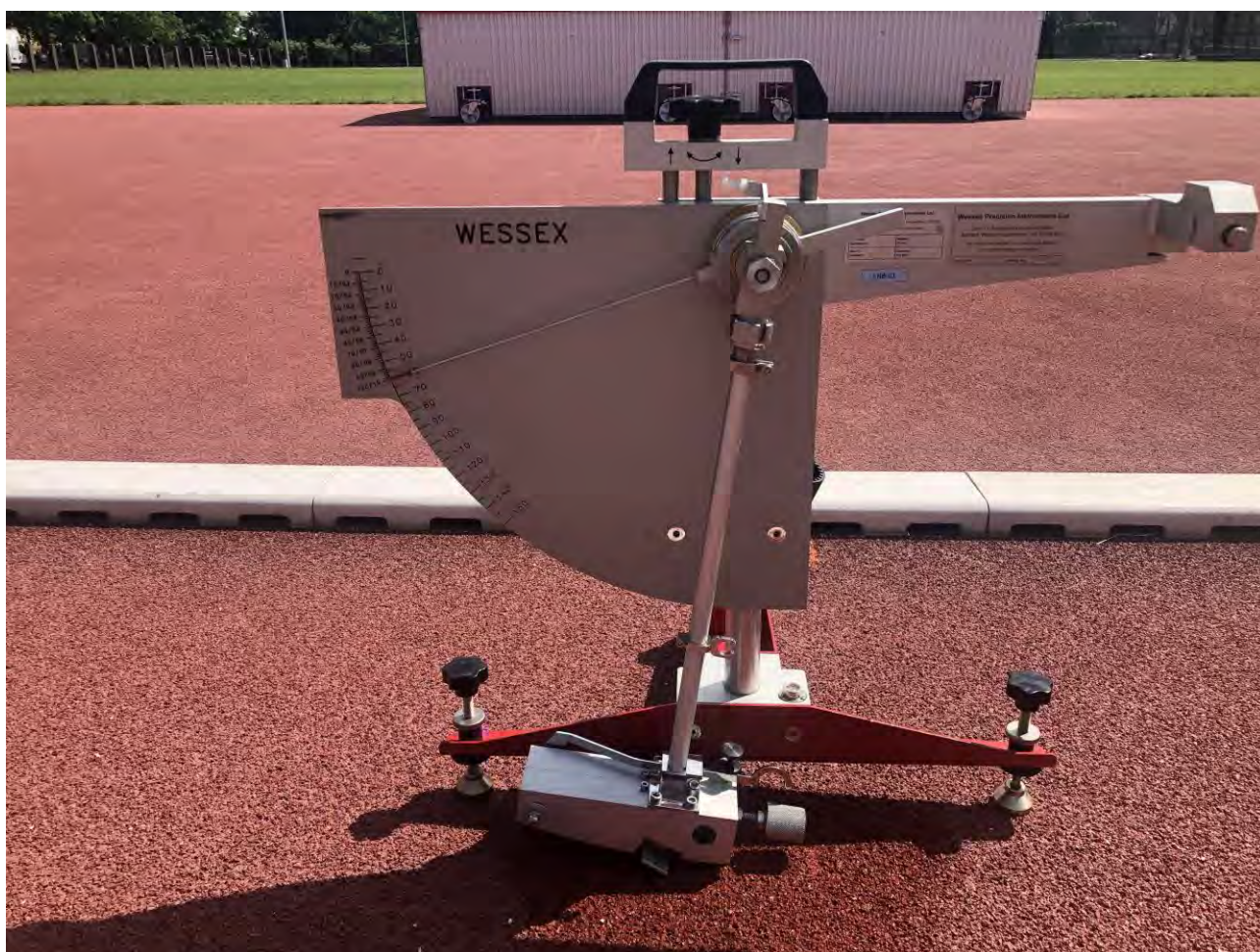
Fot. 7 Badanie oporu poślizgu na mokro
