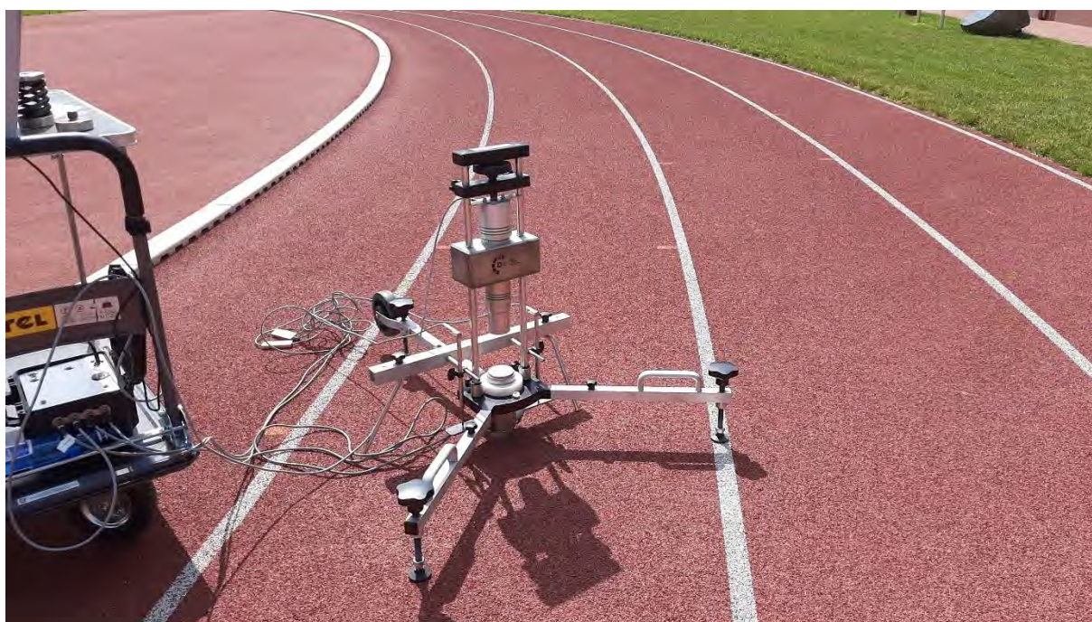
Fot. 14 Przykładowy pomiar odkształcenia pionowego na nawierzchni syntetycznej
