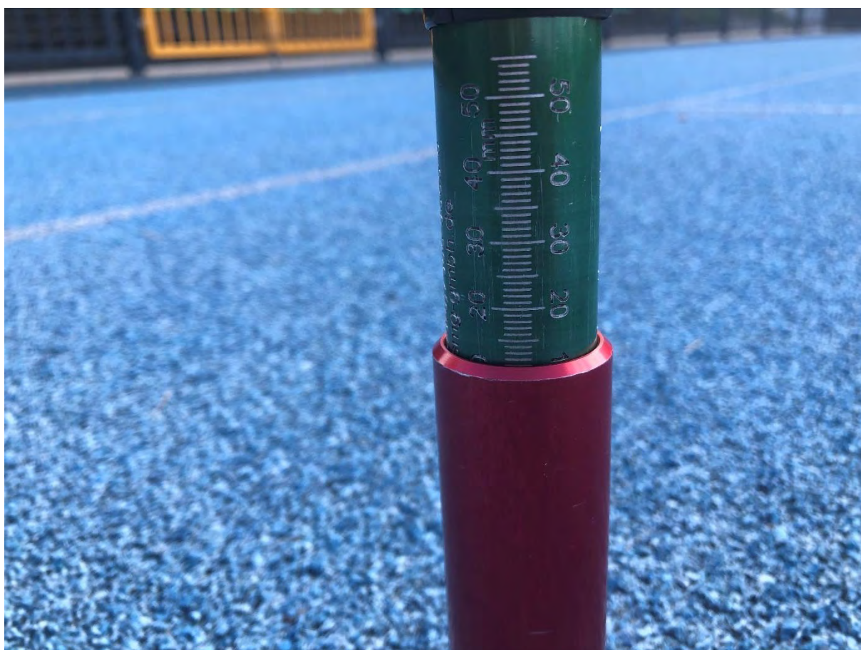
Fot. 16 Przykładowy pomiar grubości nawierzchni syntetycznej
