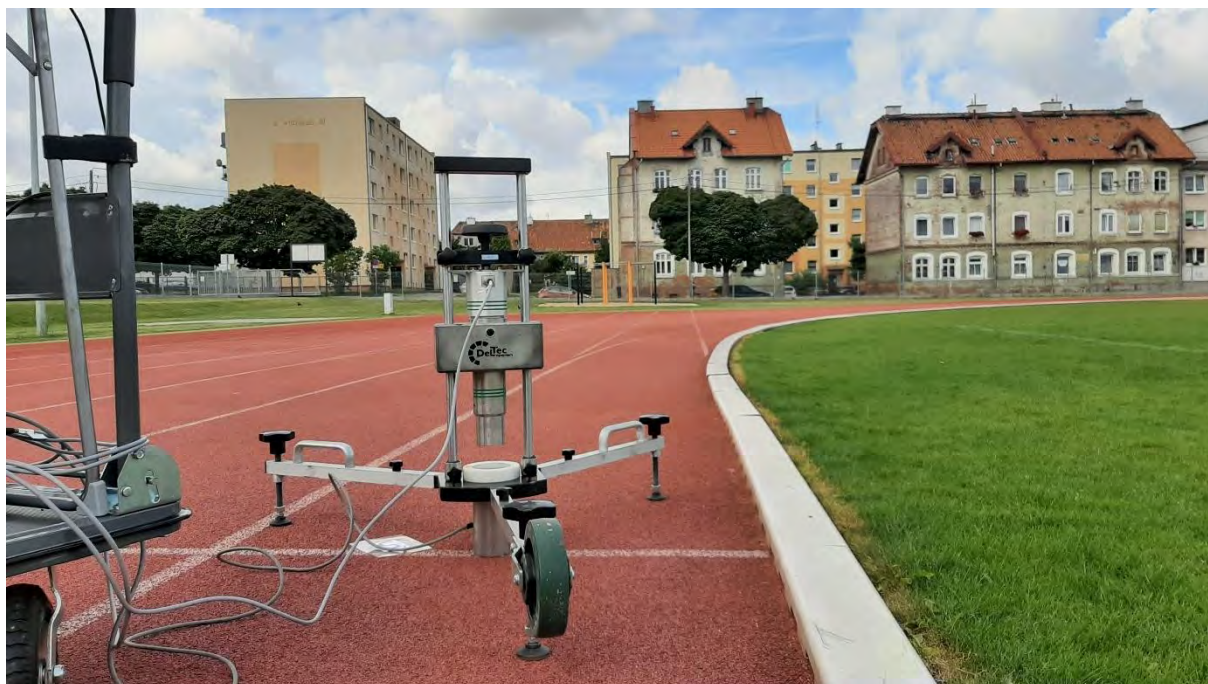
Fot. 13 Przykładowy pomiar amortyzacji siły na nawierzchni syntetycznej
