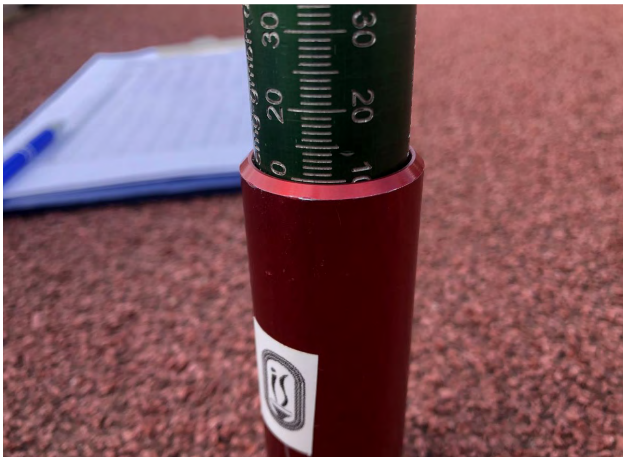
Fot. 3 Badanie grubości nawierzchni
