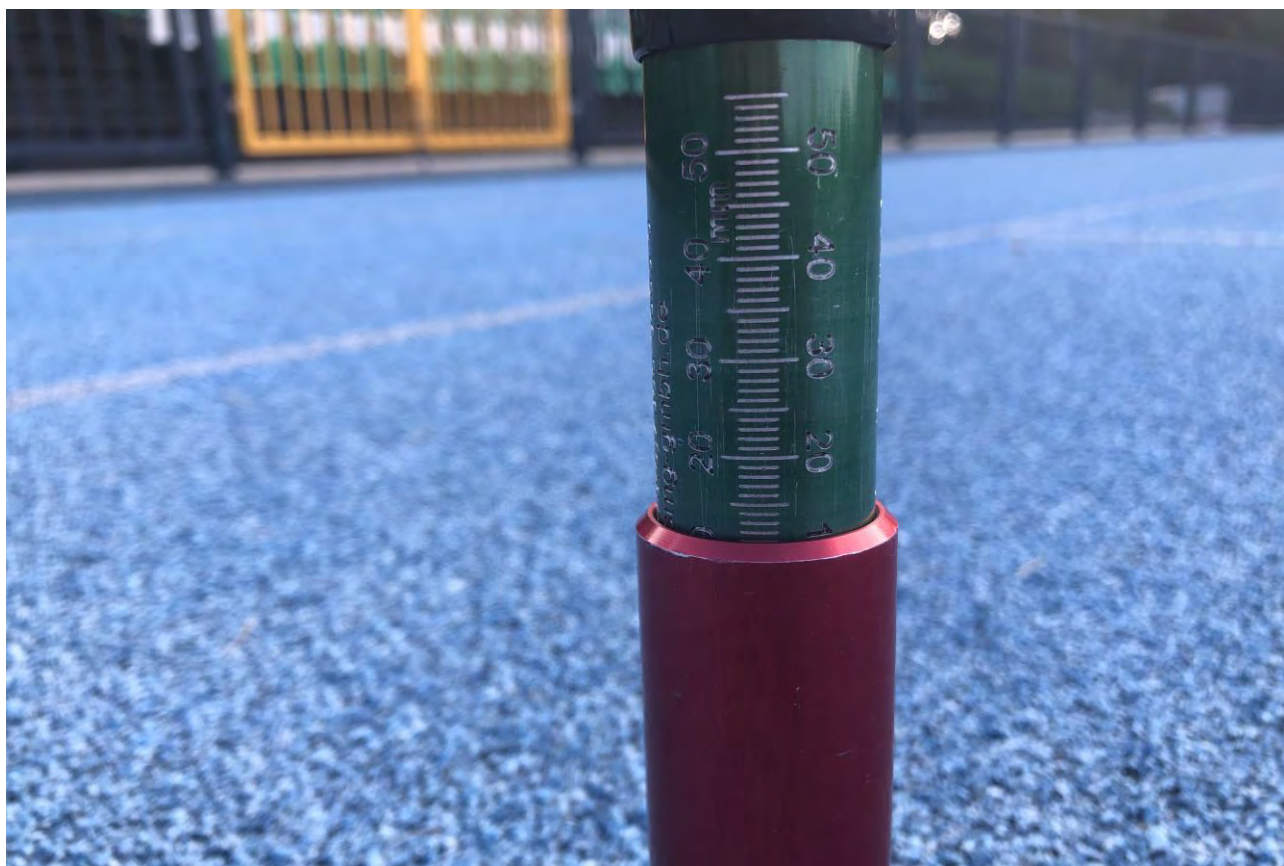
Fot. 6 Badanie grubości nawierzchni
