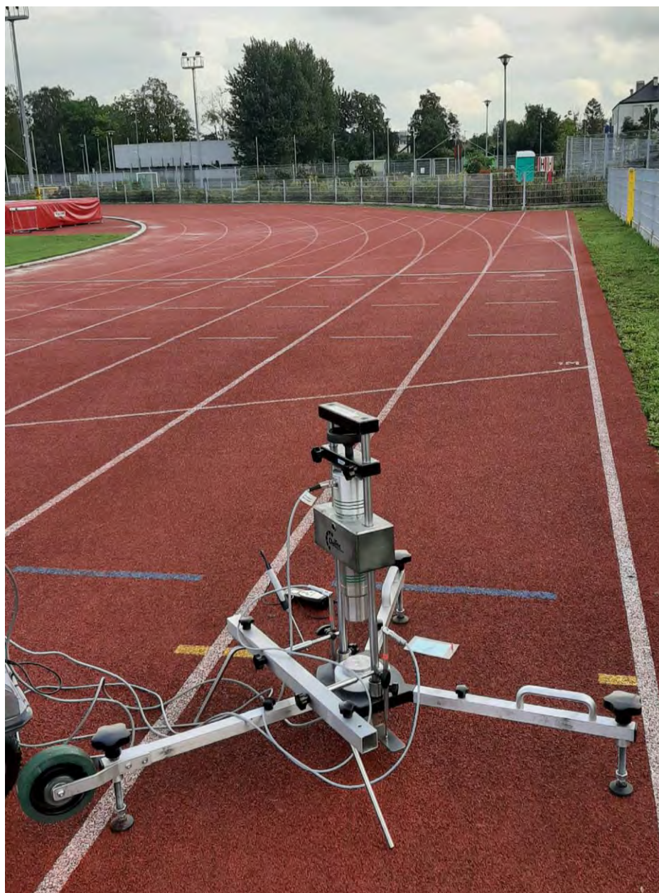
Fot. 5 Badanie odkształcenia pionowego w punkcie nr 7
