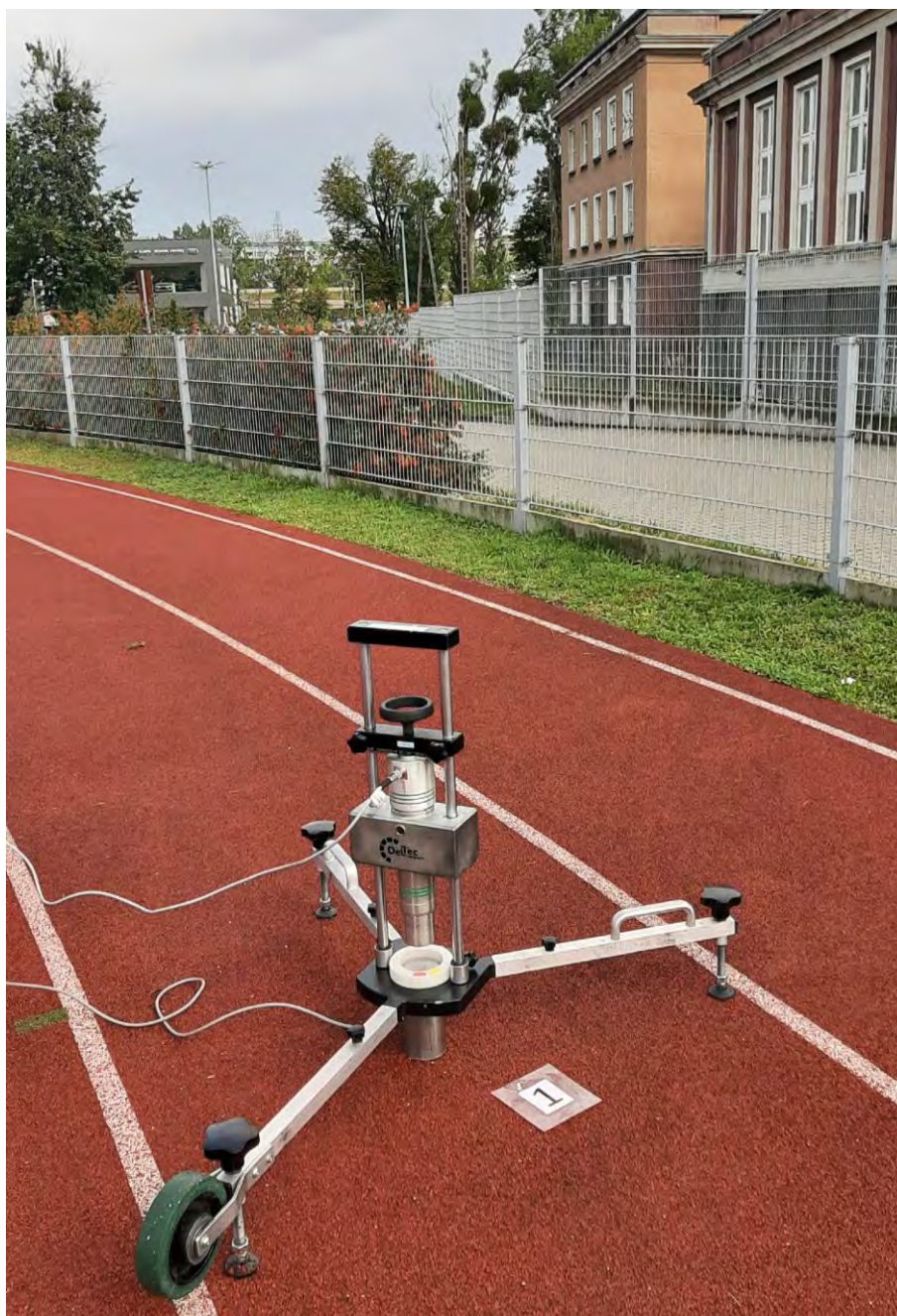
Fot. 4 Badanie amortyzacji siły w punkcie nr 1
