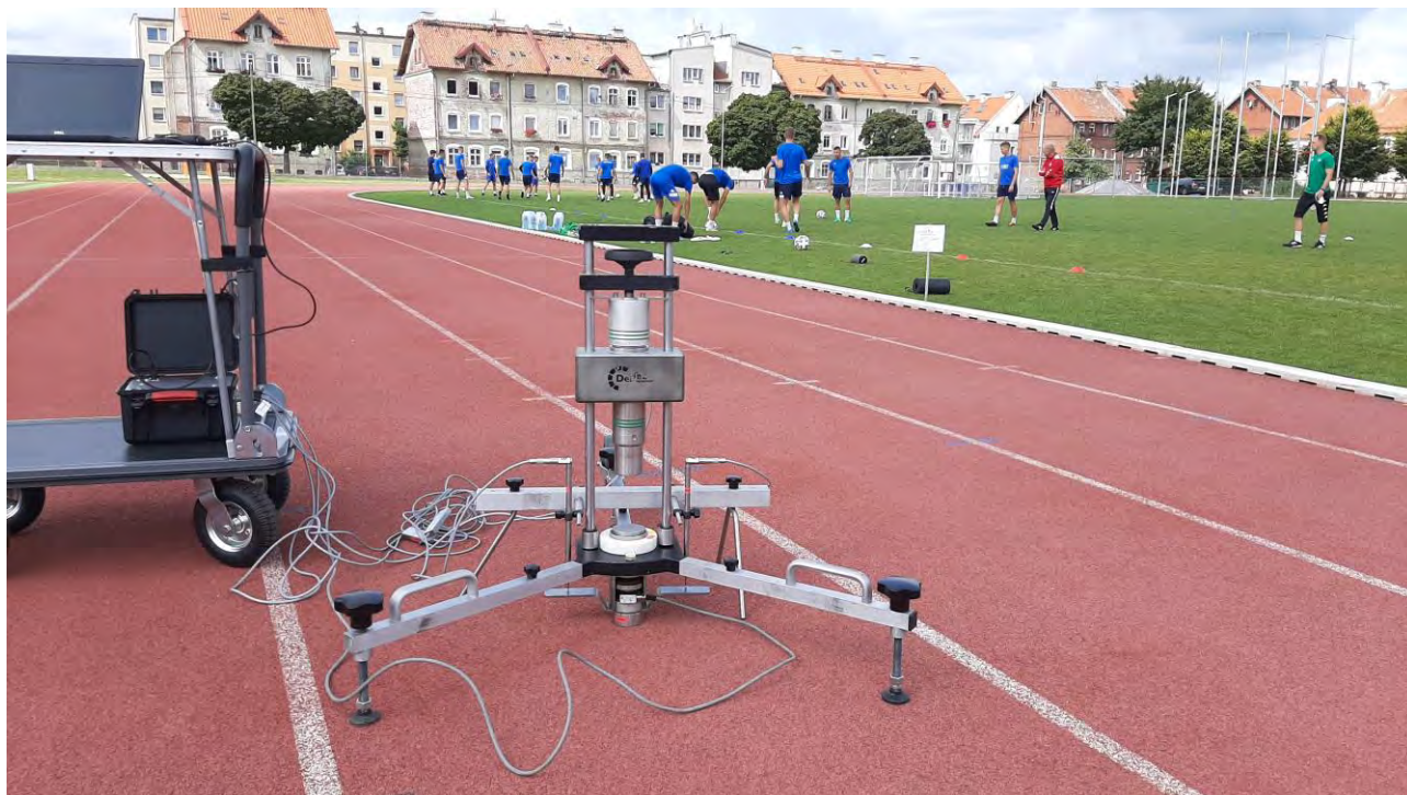
Fot. 5 Badanie odkształcenia pionowego
