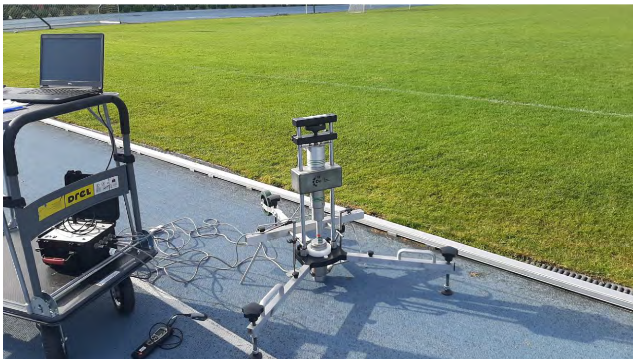
Fot. 4 Badanie odkształcenia pionowego w punkcie nr 2
