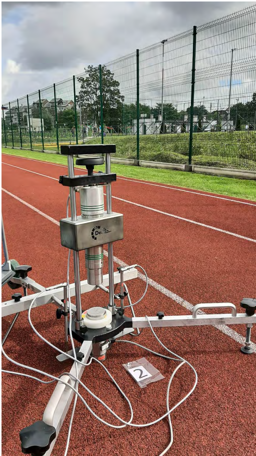
Fot. 5 Badanie odkształcenia pionowego w punkcie nr 2
