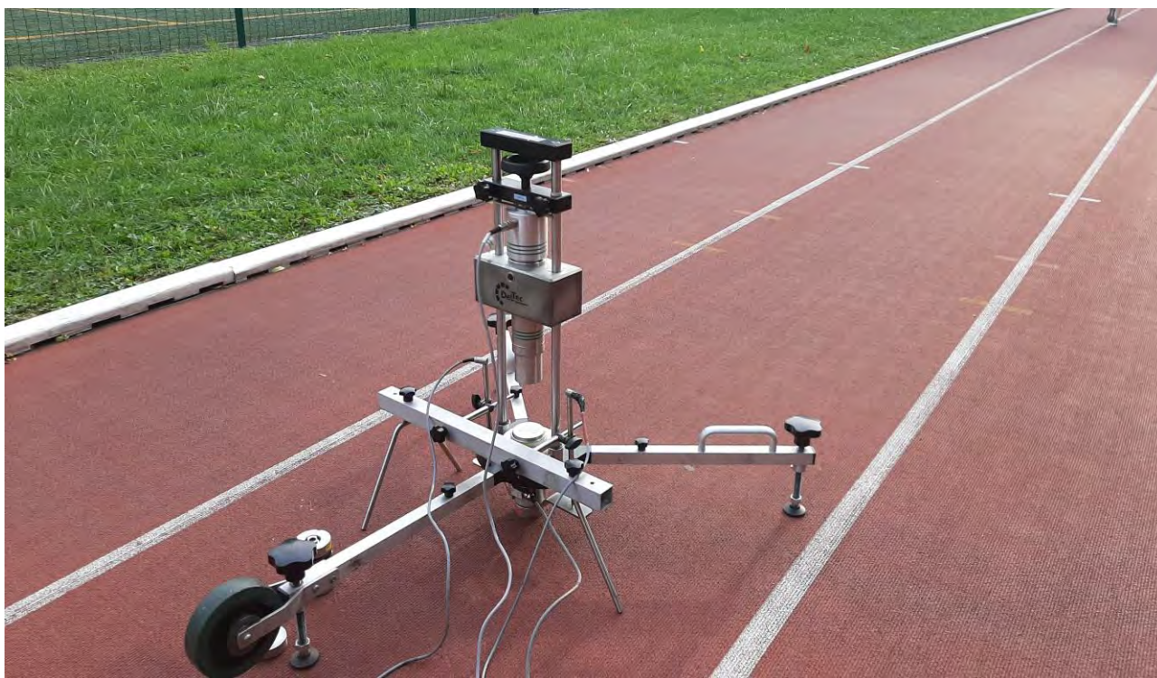
Fot. 4 Badanie odkształcenia pionowego
