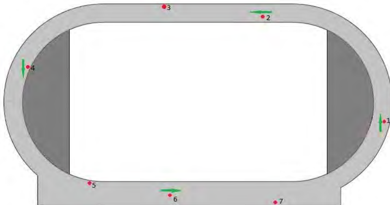
Rysunek 1 Plan obiektu z zaznaczonymi lokalizacjami punktów badawczych amortyzacji siły, odkształcenia pionowego oraz oporu poślizgu.
