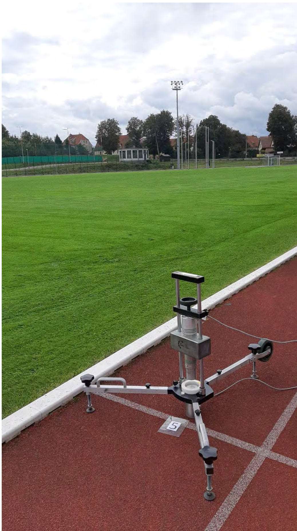
Fot. 4 Badanie amortyzacji siły w punkcie nr 5
