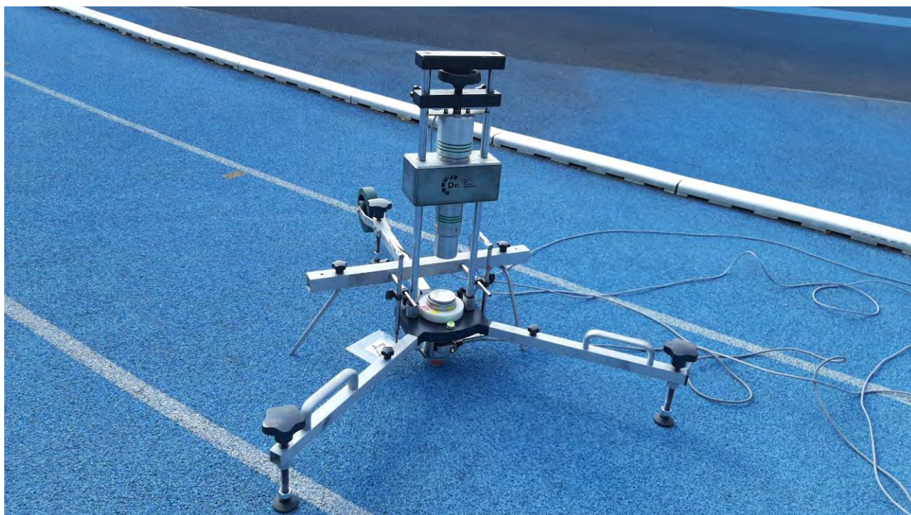
Fot. 5 Badanie odkształcenia pionowego
