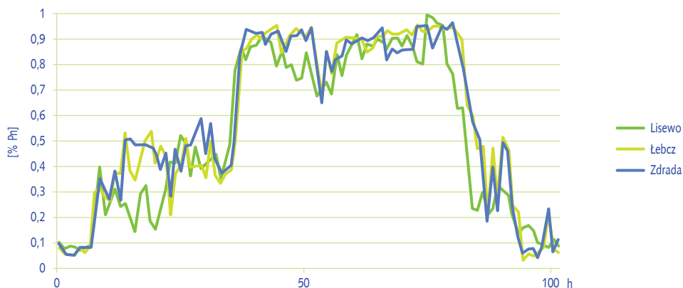
Rysunek nr 2. Przebieg pracy farm wiatrowych Lisewo, Łęcz i Zdrada w tym samym czasie w odniesieniu do ich mocy zainstalowanych.
