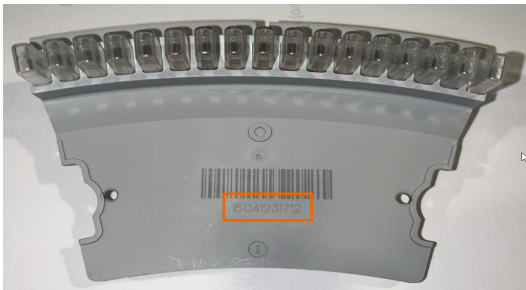
Rysunek 1. Lokalizacja numeru serii na segmencie kuwet do pierścienia reakcyjnego Atellica CH
