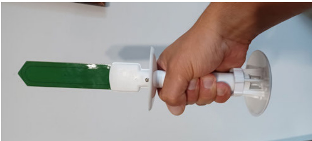
Fot. 6. Czujnik doglebowy mierzący dynamikę zmian wilgotności i temperatury gleby
