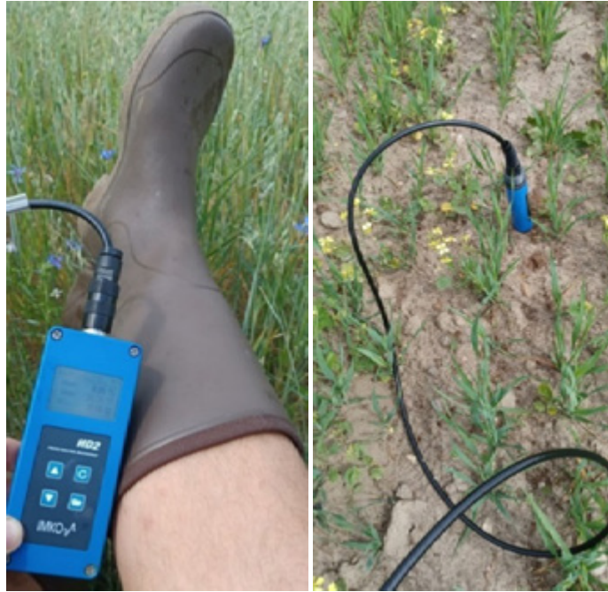
Fot. 4 – 5. Pomiary wykonywane za pomocą sondy dogłębowej SONO TRIME-PICO 32 i rejestratora danych IMKO HD2.
