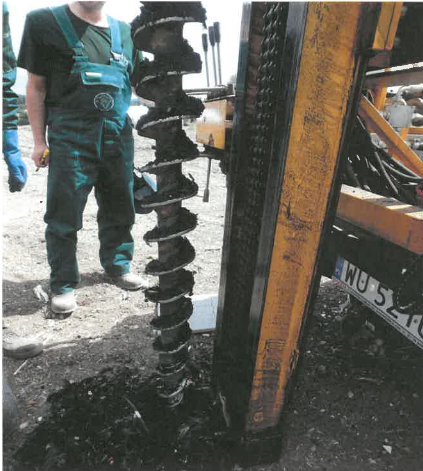
Wykonywanie odwiertów wiertnicą mechaniczną w celu określenia głębokości i rodzaju zalegających odpadów w miejscowości Nowa Ruda
