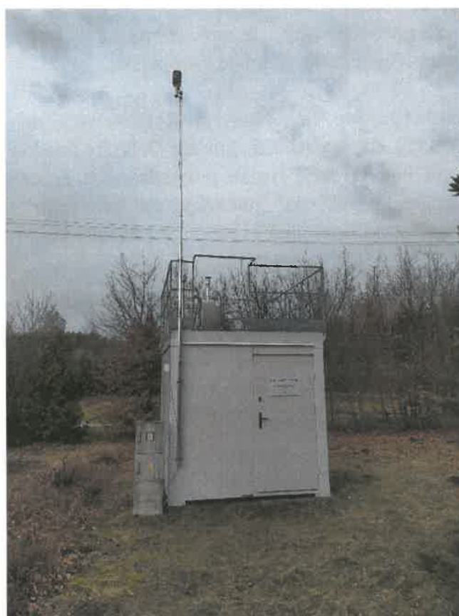
Jeden z zakupionych w 2019 roku kontenerów, mieszczący wyposażenie stacji monitoringu zanieczyszczeń powietrza.
