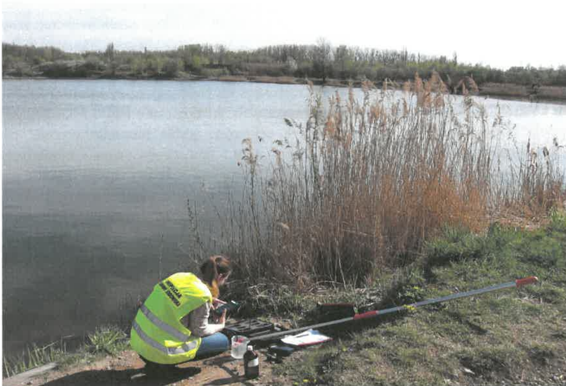
Zanieczyszczenie substancjami ropopochodnymi stawu w Chorzowie – pobór prób oraz pomiar in situ z użyciem przenośnego analizatora pH, temperatury i przewodności
