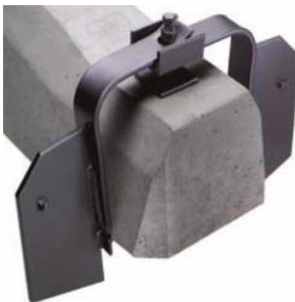
Rys. 6.4.2. Przykład profilu stalowego mocowanego do podkładów lub podrozdnic, których zadaniem jest zwiększenie oporu poprzecznego toru w konstrukcji podsypkowej
