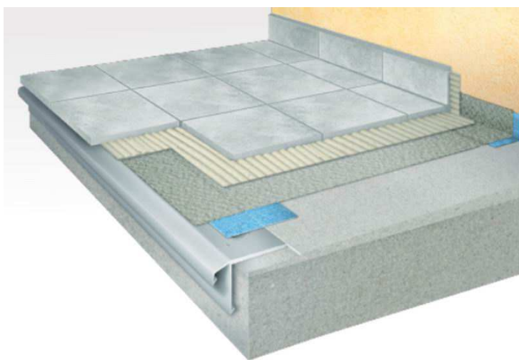
Krawędź płyty spocznikowej
