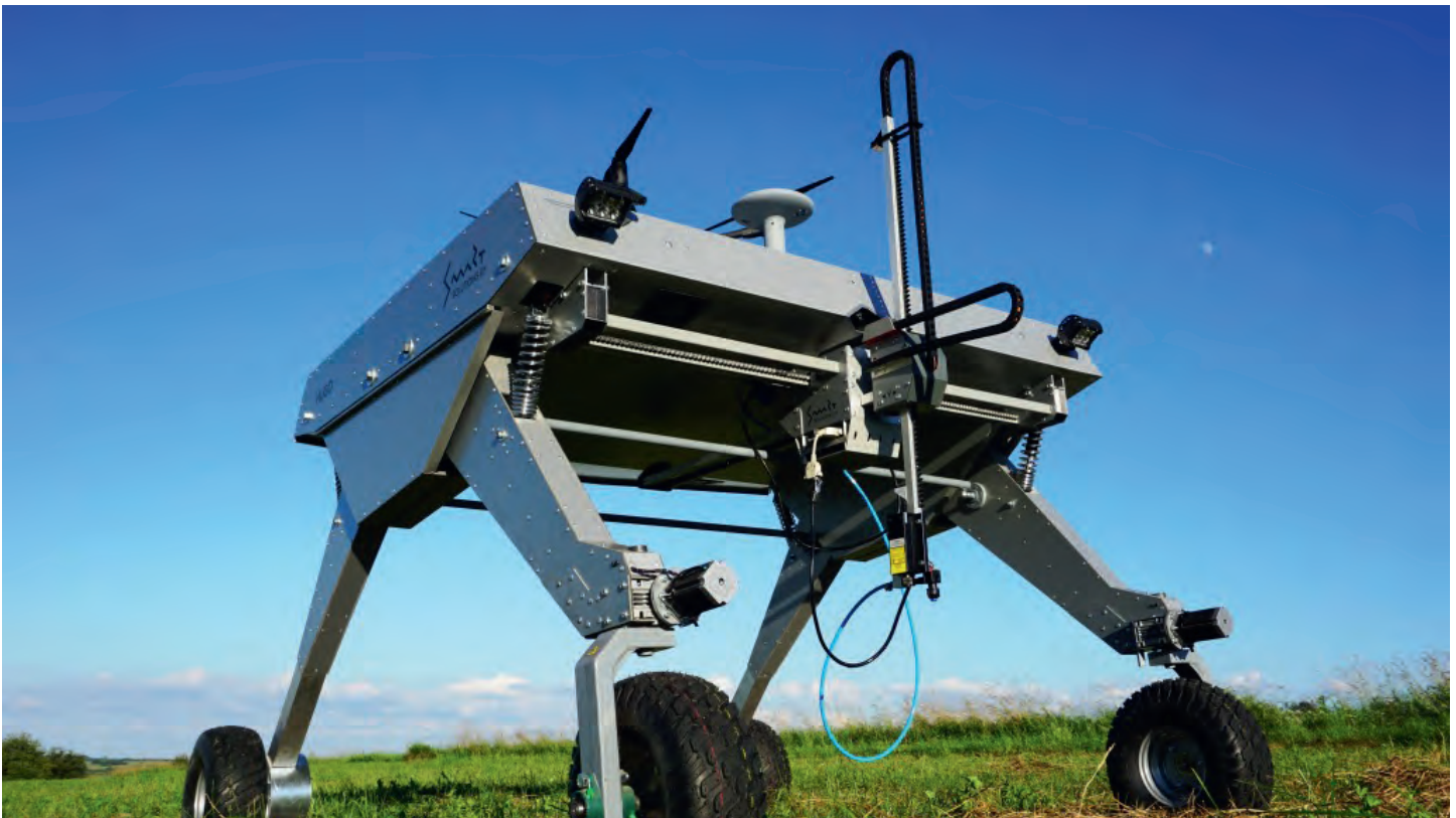
Fot. 3. Robot Rolniczy – bezałogowa platforma jezdna zintegrowana z technologią Hugo – Growth Stimulator.
