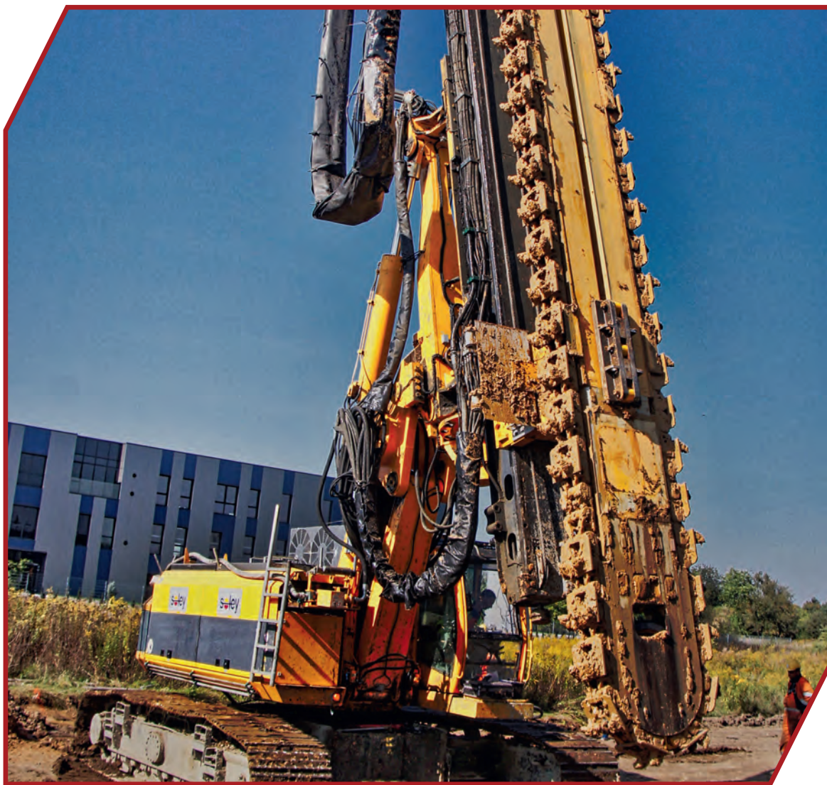
Fot. 2. Prototyp narzędzia TFoW podczas pierwszych testów.
