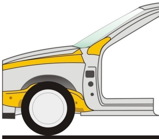
Rysunek nr 4.12. Wzmocnienia słupka B powodujące odchylenie kół przednich
