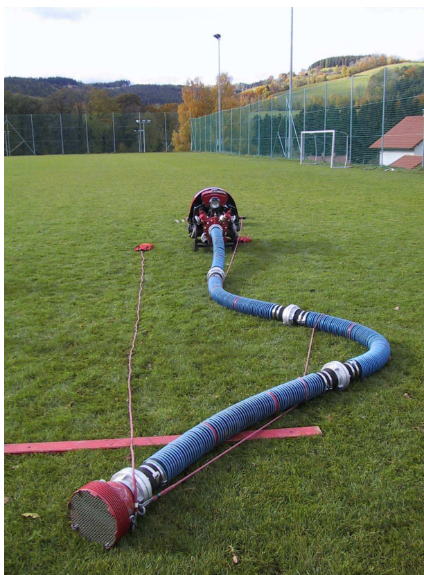
Rys. 11 Właściwie sprawiona linia ssawna
