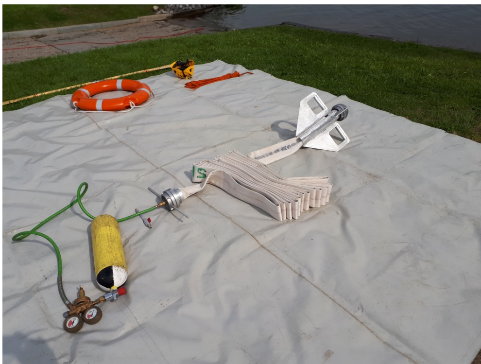
Zdj. 30 Połączenie butli z reduktorem ciśnienia i pokrywą z króćcem pneumatycznym Autor: asp. K. Bartoszak
