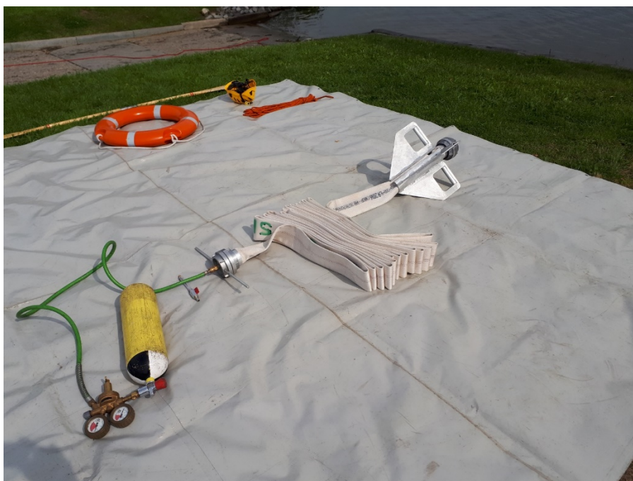
Zdj. 41 Pożarniczy wąż tłoczny przygotowany do napełnienia sprężonym powietrzem Autor: asp. K. Bartoszak
