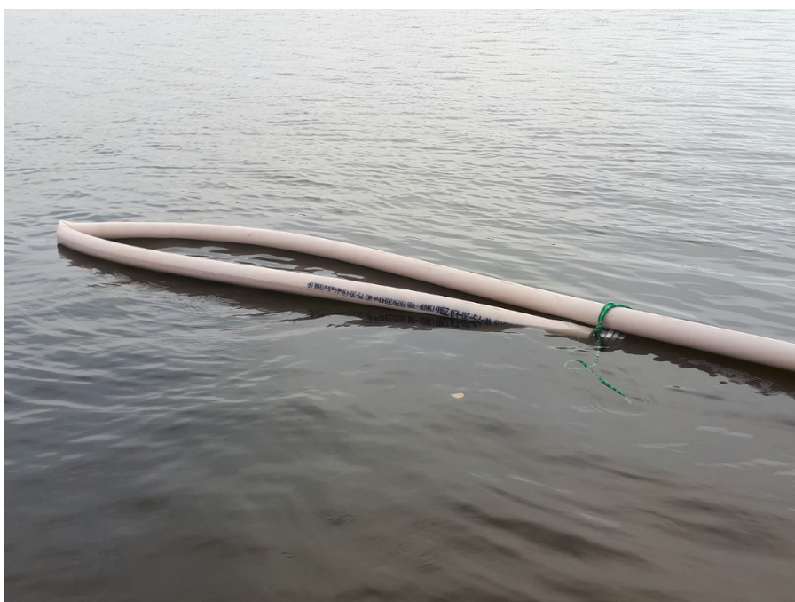
Zdj. 42 Pożarniczy wąż tłoczny po napełnieniu przygotowany do działań Autor: asp. K. Bartoszak
