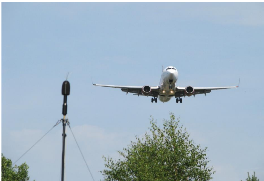
Fot. 2.4 Pomiar hałasu lotniczego na lotnisku MPL Katowice w Pyrzowicach
