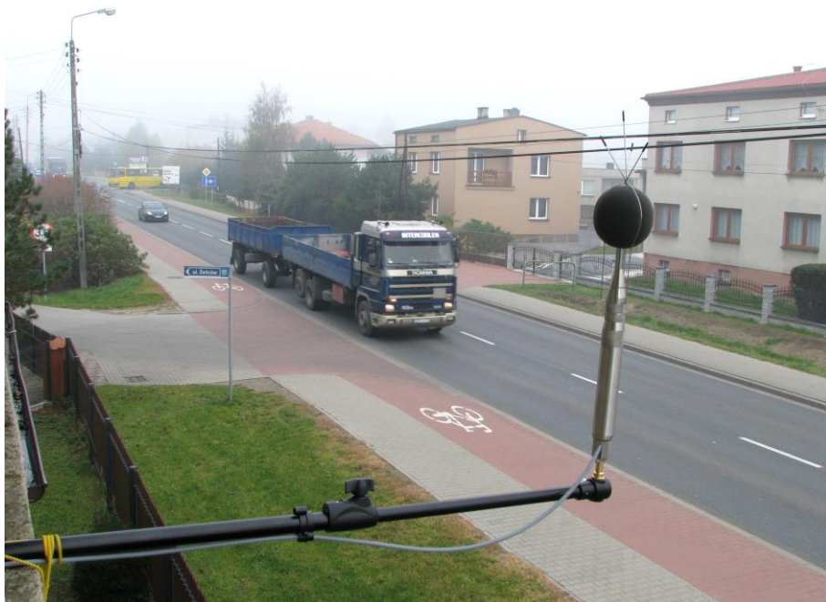
Fot. 2.2 Pomiar hałasu drogowego w miejscowości Imielin.
