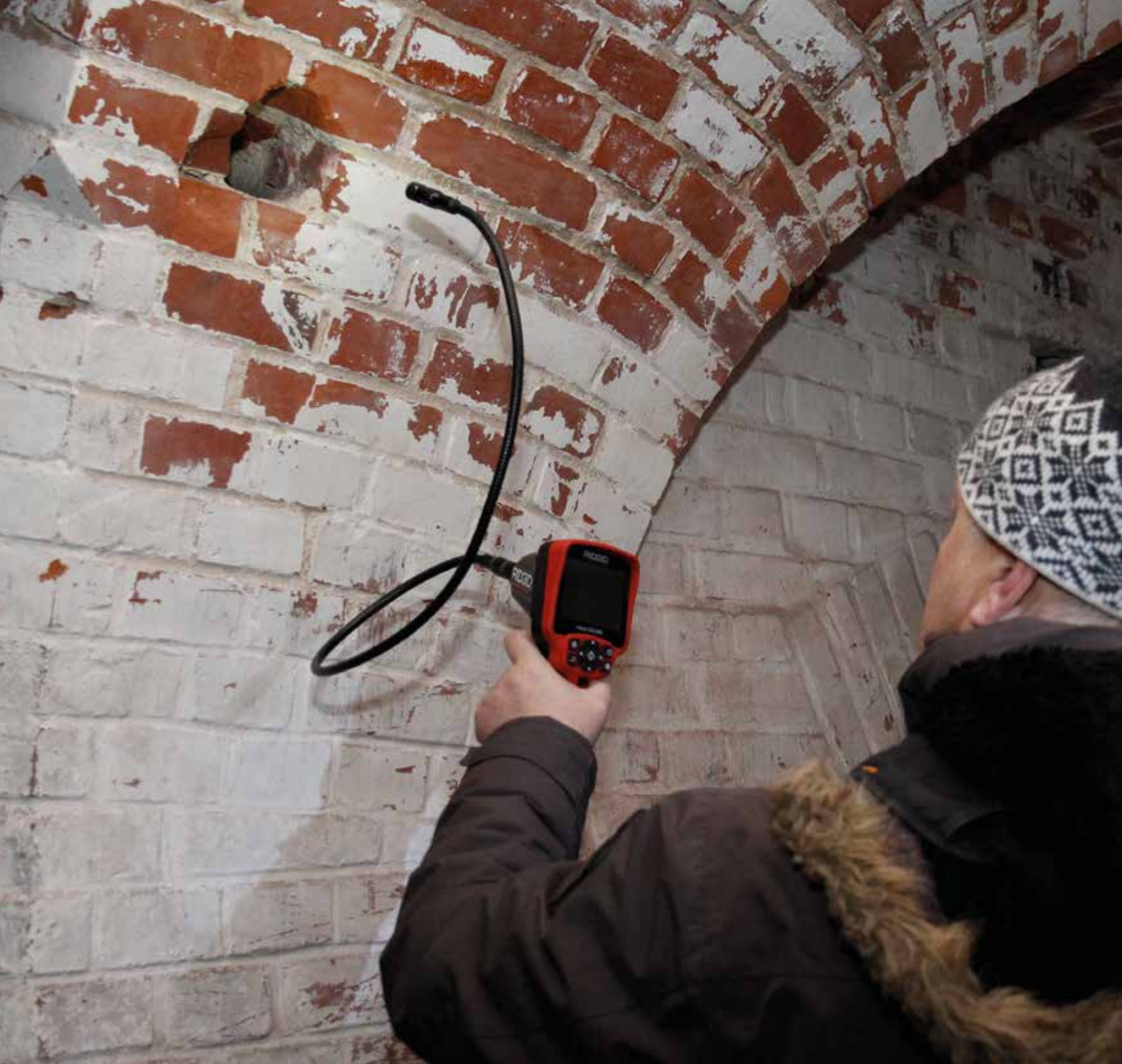
Endoskop zaopatrzony w kamerę i źródło światła umożliwia poszukiwanie nietoperzy w głębokich szczelinach, fot. Miłosz Owieśny
