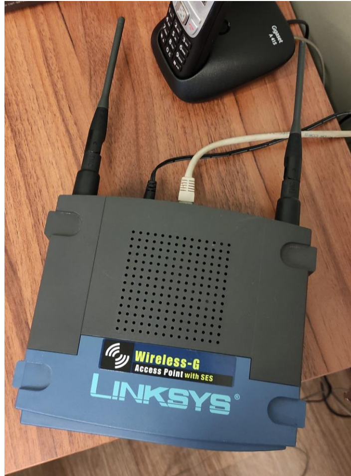
Fot. 1: Widok punktu dostępowego model WAP54G
