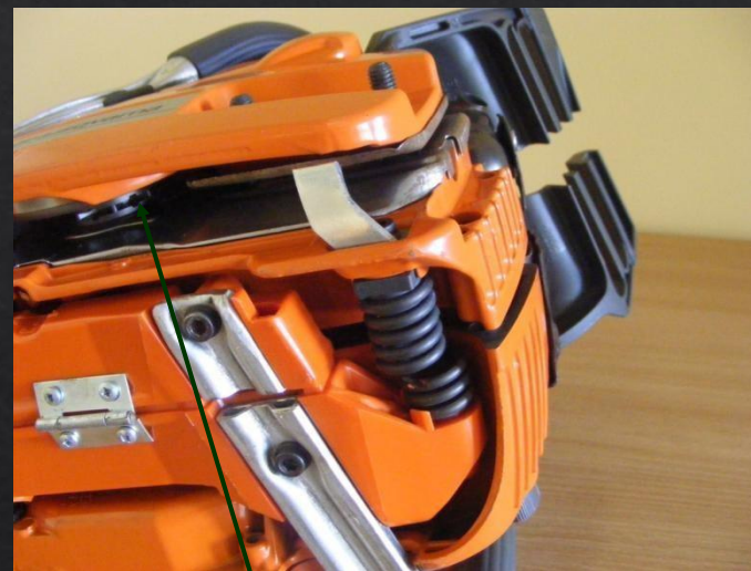
Kółko napędowe łańcucha tnącego w pilarence do drewna
