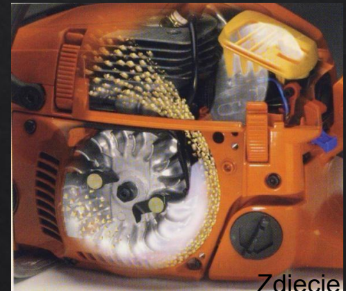
Oczyszczanie zassanego powietrza w filtrze odśrodkowym
