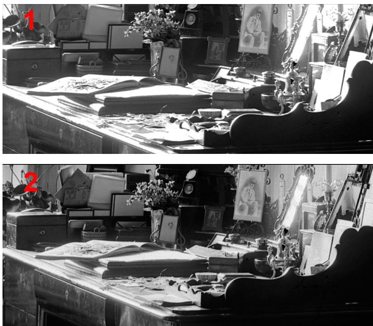
3.104. Fragment negatywu. Porównanie pozytywu uzyskanego: metodą skanowania (1), metodą fotograficzną (2). Widoczny zanik szczegółów w światłach obrazu uzyskanego metodą skanowania. Negatyw ze zbiorów MHK. Opracowanie W. Pyzik
