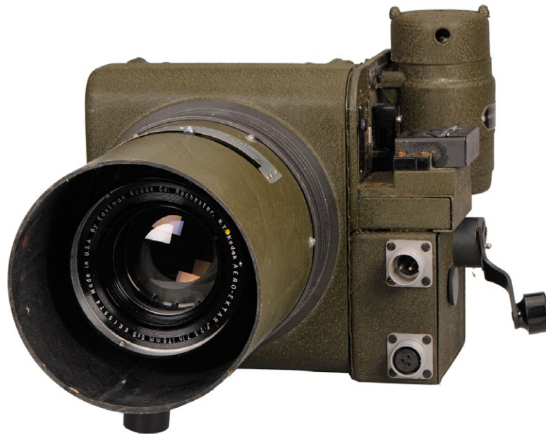
2.16. Lotniczy aparat fotograficzny Kodak K24 z promieniotwórczym obiektywem Aero Ektar. Ze zbiorów Muzeum Historii Fotografii. Fot. W. Staszkiwicz
