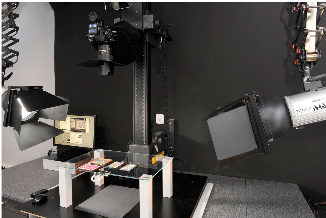
3.155. Stanowisko do pracy bezcieniowej, pozwalające na lepsze odwzorowanie krawędzi przedmiotów. Pracownia Dokumentacji Obrazowej MHF. Fot. W. Staszkiwicz
