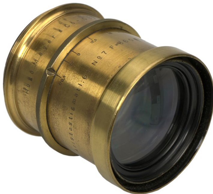
2.14. Obiektyw Hugo Mayera Aristostigmat 360 mm f/6,5 , opatentowany w 1900 r., ze zbiorów MHF. Fot. W. Staszekiewicz
