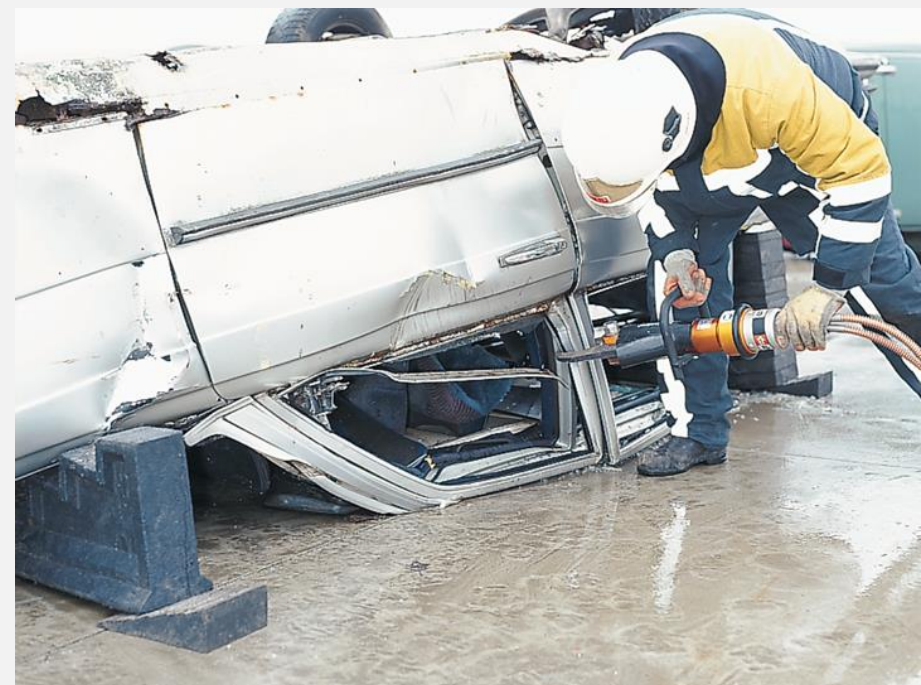
Przecinanie profili stalowych
