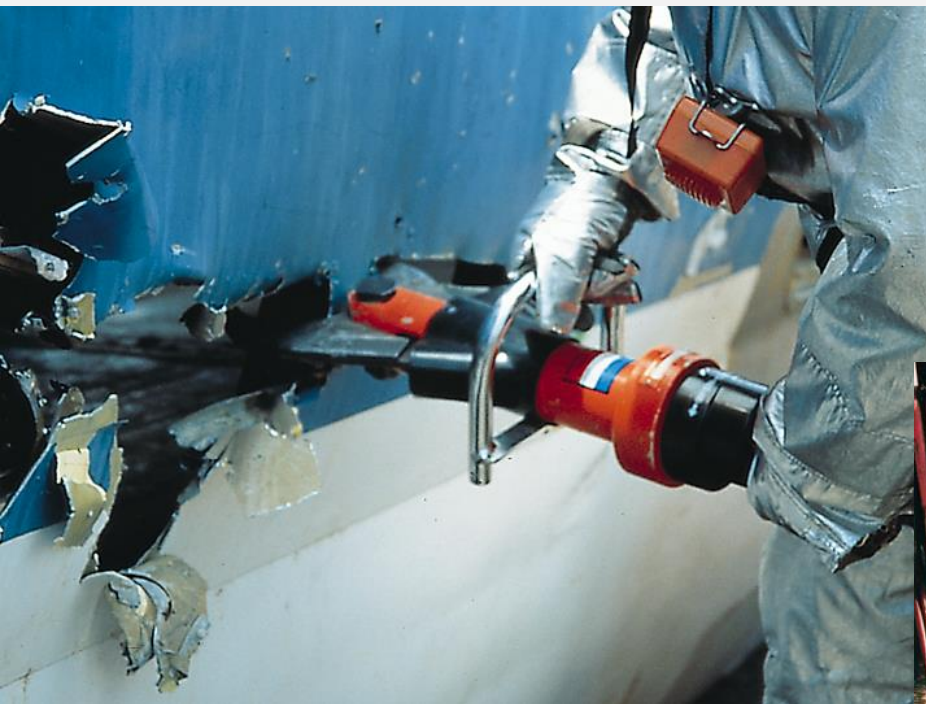
Cięcie powłok blaszanych (karoserii, kadłubów)
