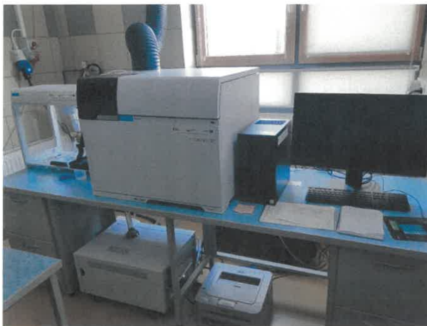
Spektrometr mas z plazmą wzbudzaną indukcyjnie ICP-MS
