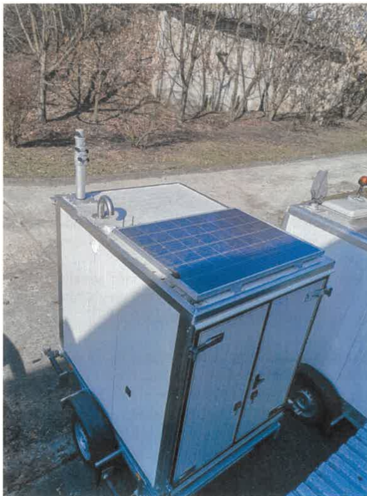
Kontener do hałasowych stacji pomiarów hałasu
