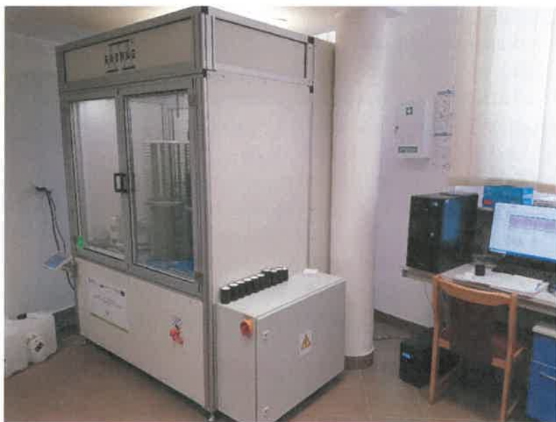
Automatyczny system do ważenia filtrów z pyłem PM10/PM2.5
