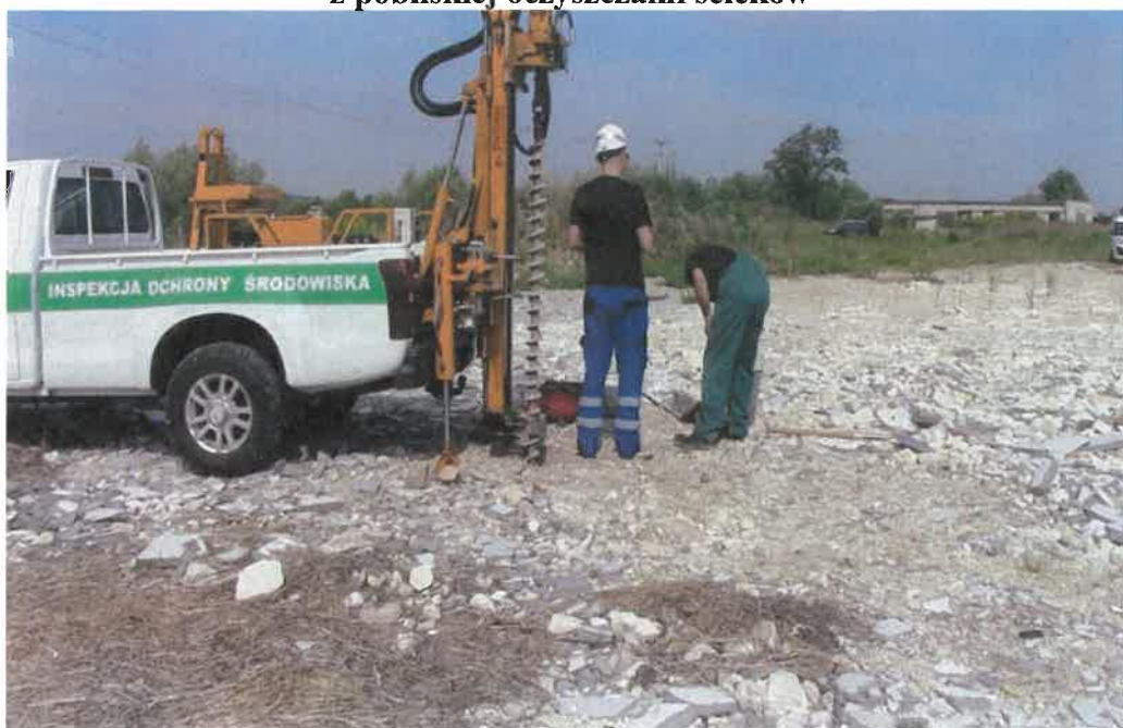
Wykonanie odwiertów na terenie zrehabilitowanego wyrobiska po osadniku byłej Cukrowni w Jaworze
