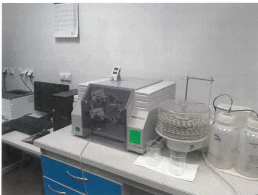
Analizator rtęci – Mercur
