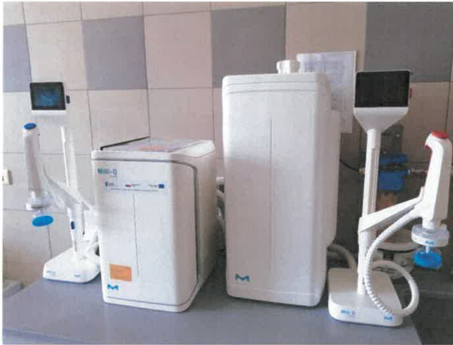
System do debiologizacji i demineralizacji wody
