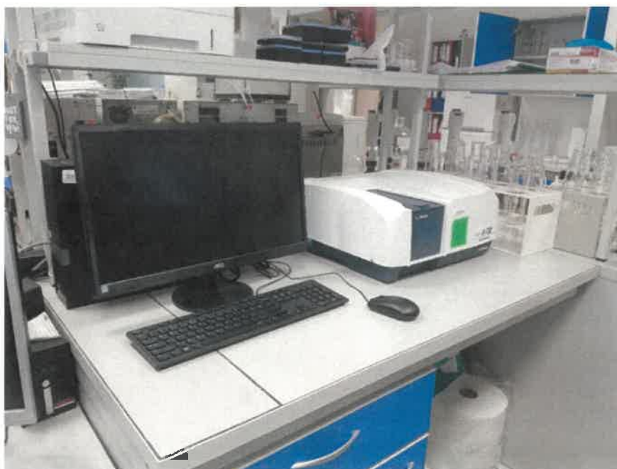
Spektrometr UV/VIS V-730
