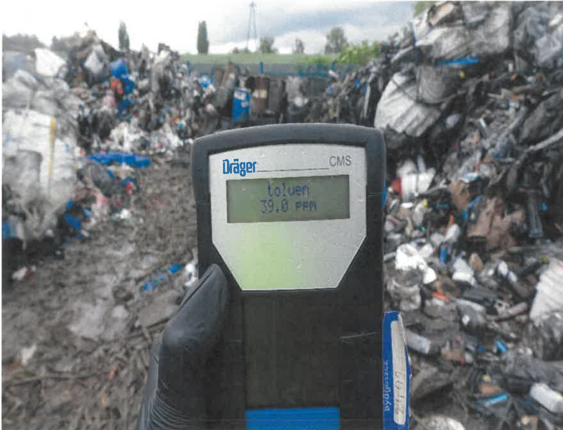
Pożar miejsca magazynowania odpadów w m. Ludzisko, gm. Inowrocław. Badanie obecności w powietrzu wybranych substancji z użyciem detektora wielogazowego do wykrywania substancji chemicznych
