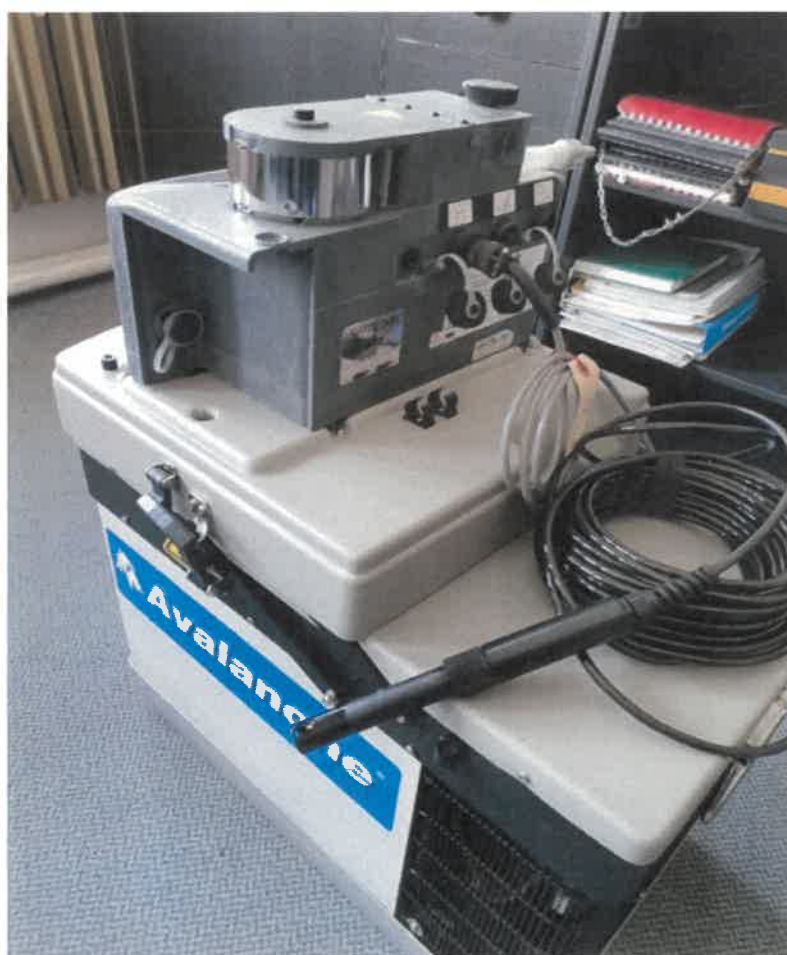
Automatyczny pobornik próbek wody i ścieków Avalanche
