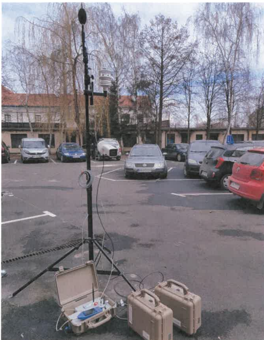
Mierniki hałasu wraz z kalibratorem masztem i stacją meteo
