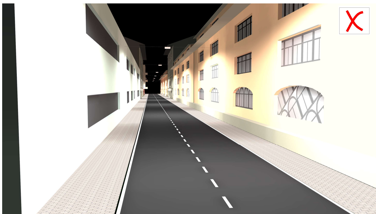
Rys. 7.2.1. Przykład występowania światła intruzyjnego na fasadach budynków (okna)
