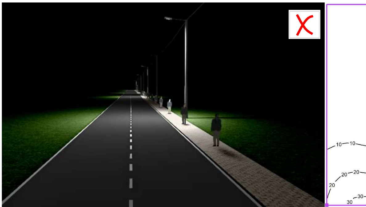
Rys. 7.1.3. Przykład błędnej dokonanej zmiany klasy oświetleniowej przez wyłączenie co drugiej oprawy oświetleniowej (praktyka niedopuszczalna): po lewej widok sytuacji oświetleniowej, po prawej rozkład izoluks na jezdni pomiędzy dwoma kolejnymi słupkami ( E_{hr} = 8 \text{ lx} , E_{min} = 0,49 \text{ lx} , E_{max} = 32 \text{ lx} , U_0 = 0,06 )
