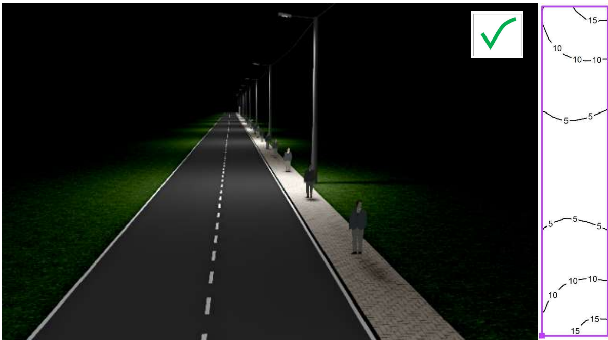
Rys. 7.1.2. Przykład prawidłowej zmiany klasy oświetleniowej (związanej np. ze zmianą natężenia ruchu drogowego) i osiągniętych normatywnych poziomów oświetlenia w klasie C5 (redukacja o dwa poziomy w dół od poziomu klasy C3 realizowana za pomocą zmniejszenia strumienia świetlnego opraw; praktyka prawidłowa): po lewej widok sytuacji oświetleniowej, po prawej rozkład izoluks na jezdni pomiędzy dwoma kolejnymi słupkami ( E_{hr} = 8 \text{ lx} , E_{min} = 3,31 \text{ lx} , E_{max} = 16 \text{ lx} , U_0 = 0,42 )
