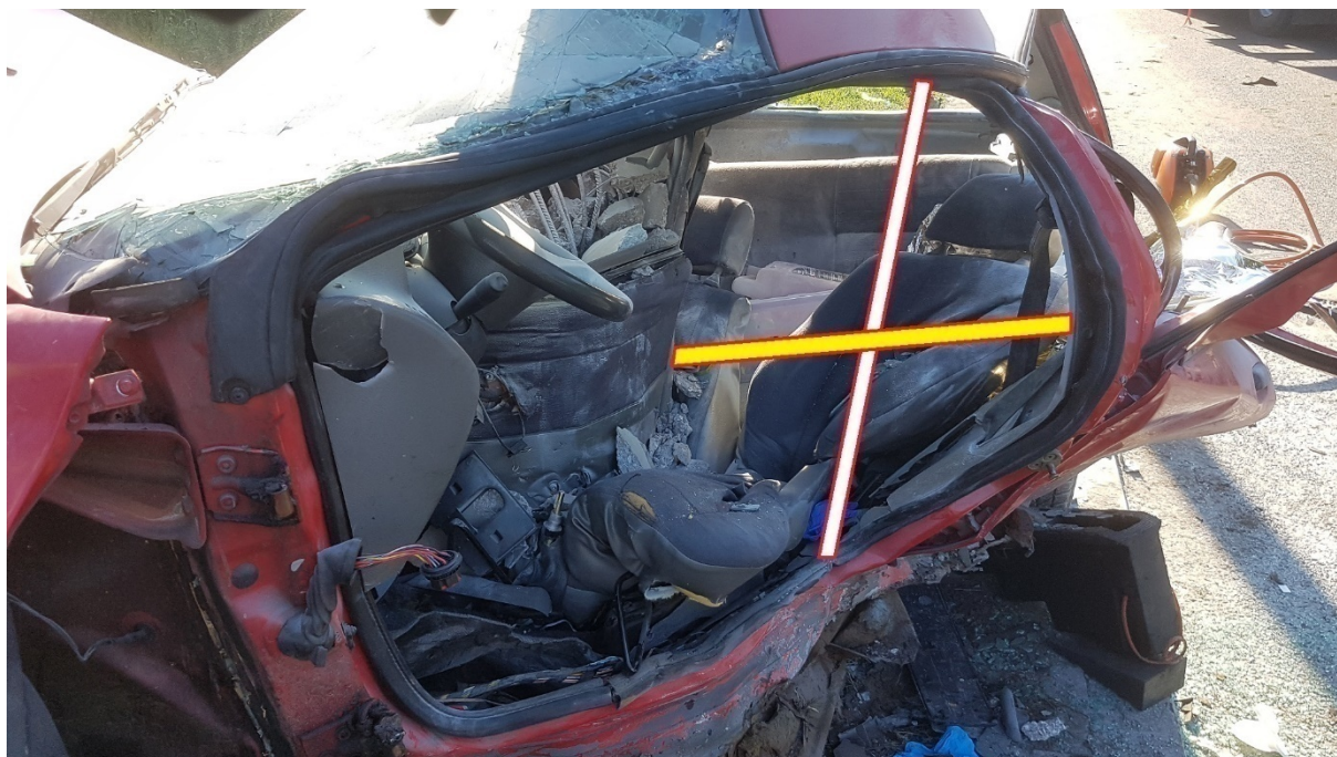
Rys. 235. Sytuacja po rozpieniu. Biała linia pokazuje, gdzie znajdował się słupek C przed rozpieniem. Żółta linia pokazuje kierunek rozpienia, które uwolniło miednicę uszkodzonego
