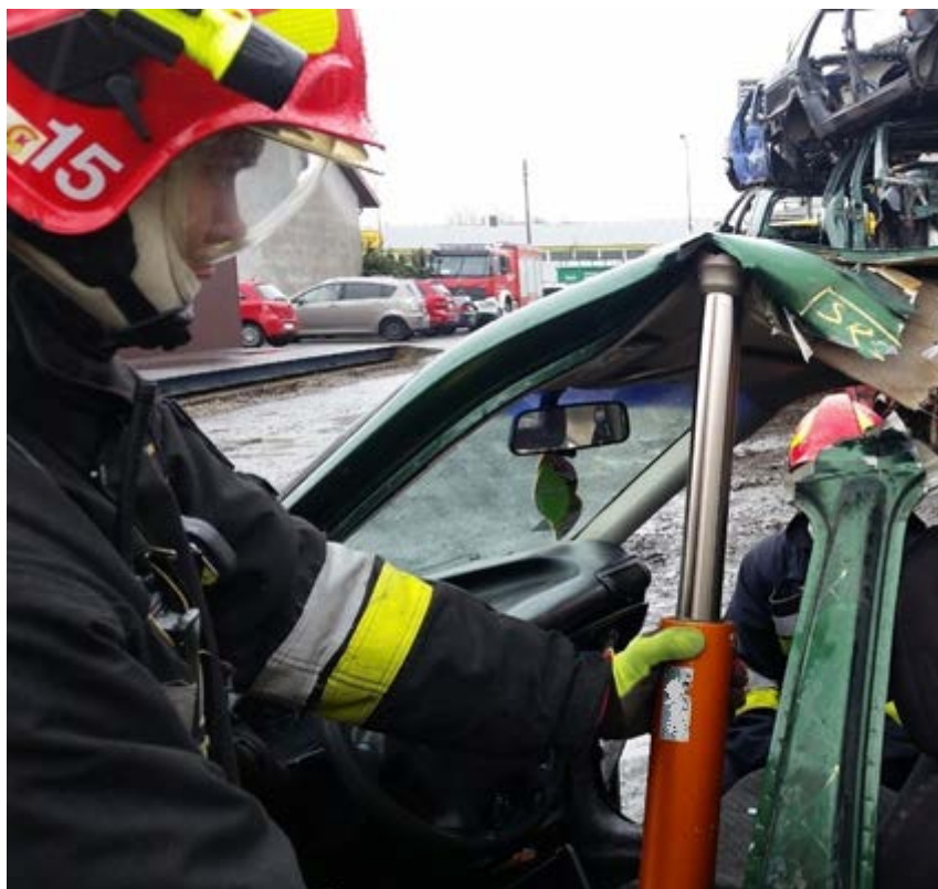
Rys. 263. Całkowite oderwanie słupka po pęknięciu zgrzewu
