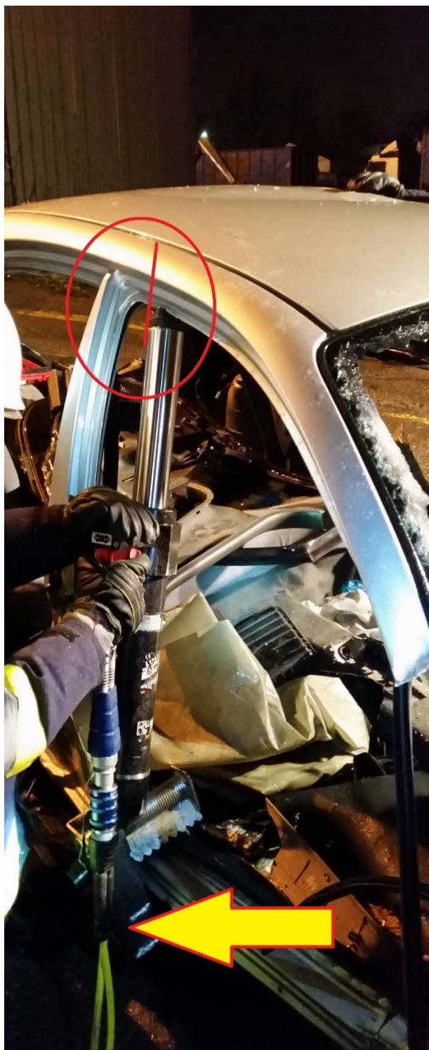
Rys. 261. Niezbędna podbudowa progu i górny punkt wyparcia omijający całkowicie konstrukcję słupka C
