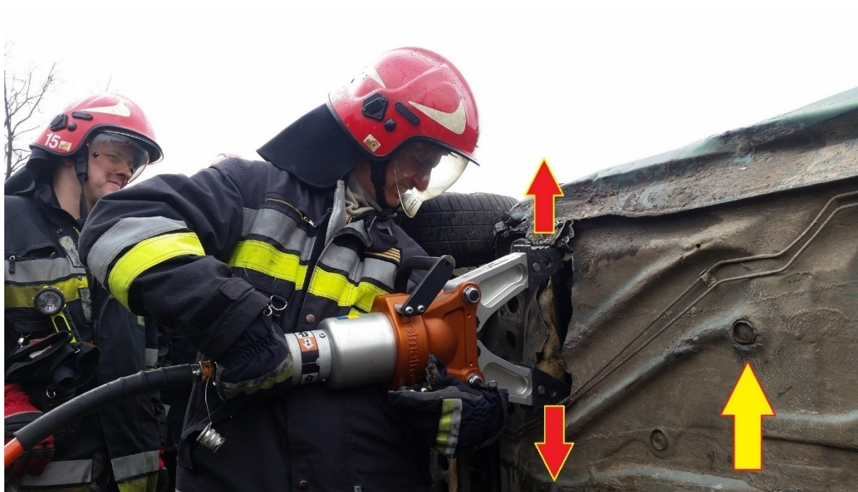
Rys. 221. Wykonanie otworu w podłodze rozpieraczem. Żółta strzałka wskazuje otwór konserwacyjny
