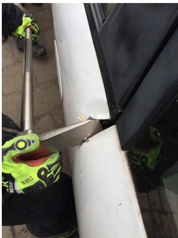
Rys. 245 A, B. Powiększanie szczeliny przez obrót narzędzia
