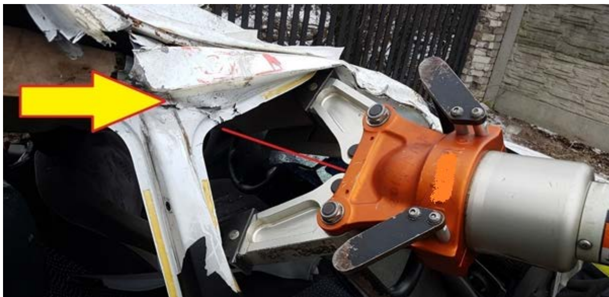
Rys. 265. Ramiona rozpieracza omijają element bezpieczeństwa biernego obok słupka C. Siła wypadkowa działa bezpośrednio na zgrzew
