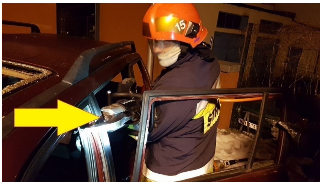
Rys. 254. Przecięcie słupka C przy otwartych / wyważonych drzwiach tylnych. Cięcie słupka w tym miejscu wykonywane jest po nacięciu odprężającym u jego podstawy
