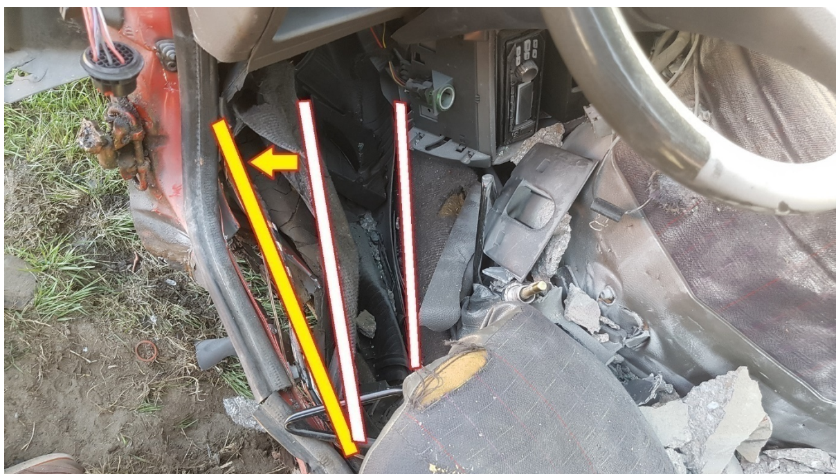
Rys. 236. Sytuacja po rozpieniu. Białe linie pokazują, gdzie znajdował się tunel środkowy i próg pojazdu. Żółta strzałka i linia pokazują kierunek rozpienia, które uwolniło stopy uszkodzonego
