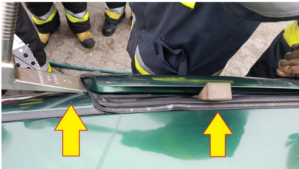
Rys. 244. Uzyskanie szczeliny przez obrót halligana. Zablokowanie przestrzeni drewnianym klinem
