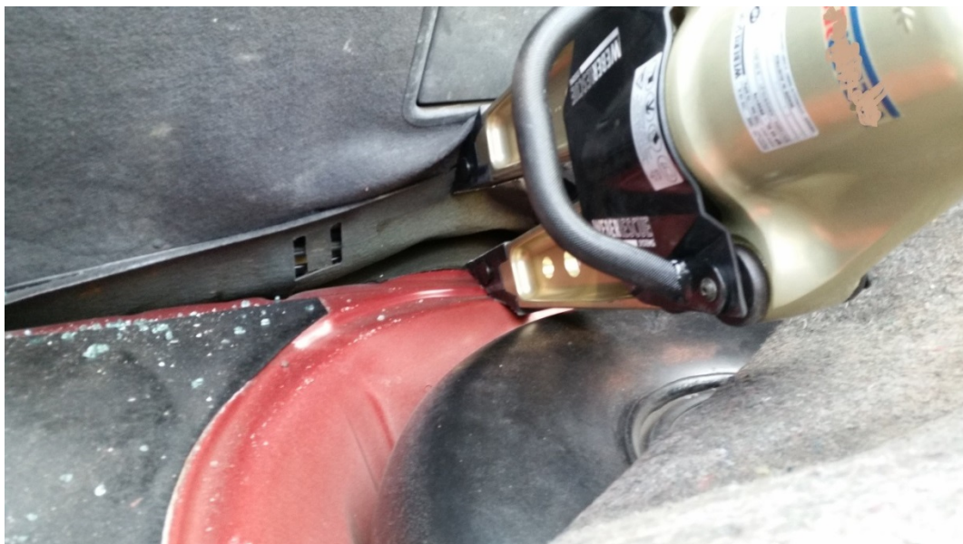
Rys. 278. Zerwanie punktów mocowania oparcia tylnej kanapy
