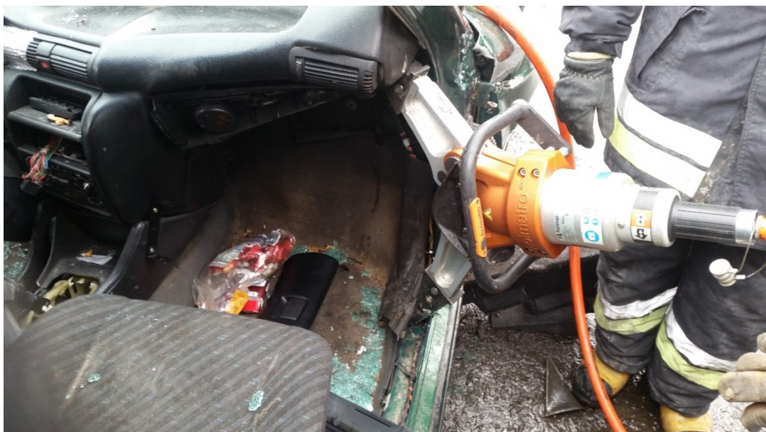
Rys. 204. Wypychanie deski rozdzielczej przy pomocy rozpieracza. Z progu pojazdu muszą być zdjęte lub odchylone gumowe i/lub plastikowe elementy, aby zapobiec wyskoczeniu rozpieracza
