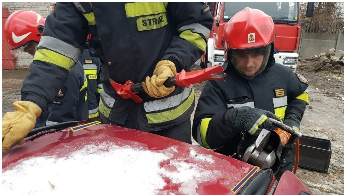
Rys. 286. Przekucie wzmocnienia poprzecznego po obu stronach dachu przy pomocy nożyc hydraulicznych. Konieczne rozpoznanie w tych miejscach
