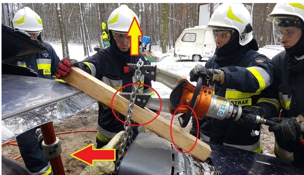
Rys. 214. Bezpieczny sposób podnoszenia kolumny kierownicy przy pomocy deski kantówki, łańcuchów i rozpieracza. Siła ciągnąca musi być skierowana idealnie w pionie. Na desce spoczywają końcówki rozpieracza, a nie uchwyt. W razie usunięcia słupka C, zastępujemy go cylindrem rozpierającym
