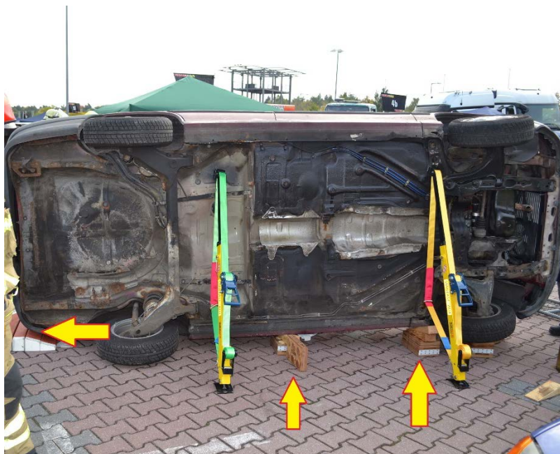
Rys. 293. Podpory mechaniczne szybkiej stabilizacji wykorzystane tylko od strony podwozia. Od strony nadwozia wykorzystano klinowanie. Strzałkami zaznaczono dodatkowe wypełnienie między autem, a podłożem. Szczególną uwagę należy zwrócić na gorące elementy układu wydechowego
