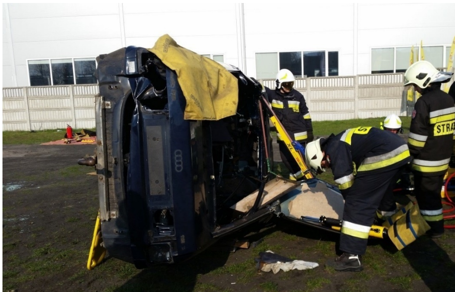
Rys. 297. Pełne odgięcie dachu auta w pozycji na boku
