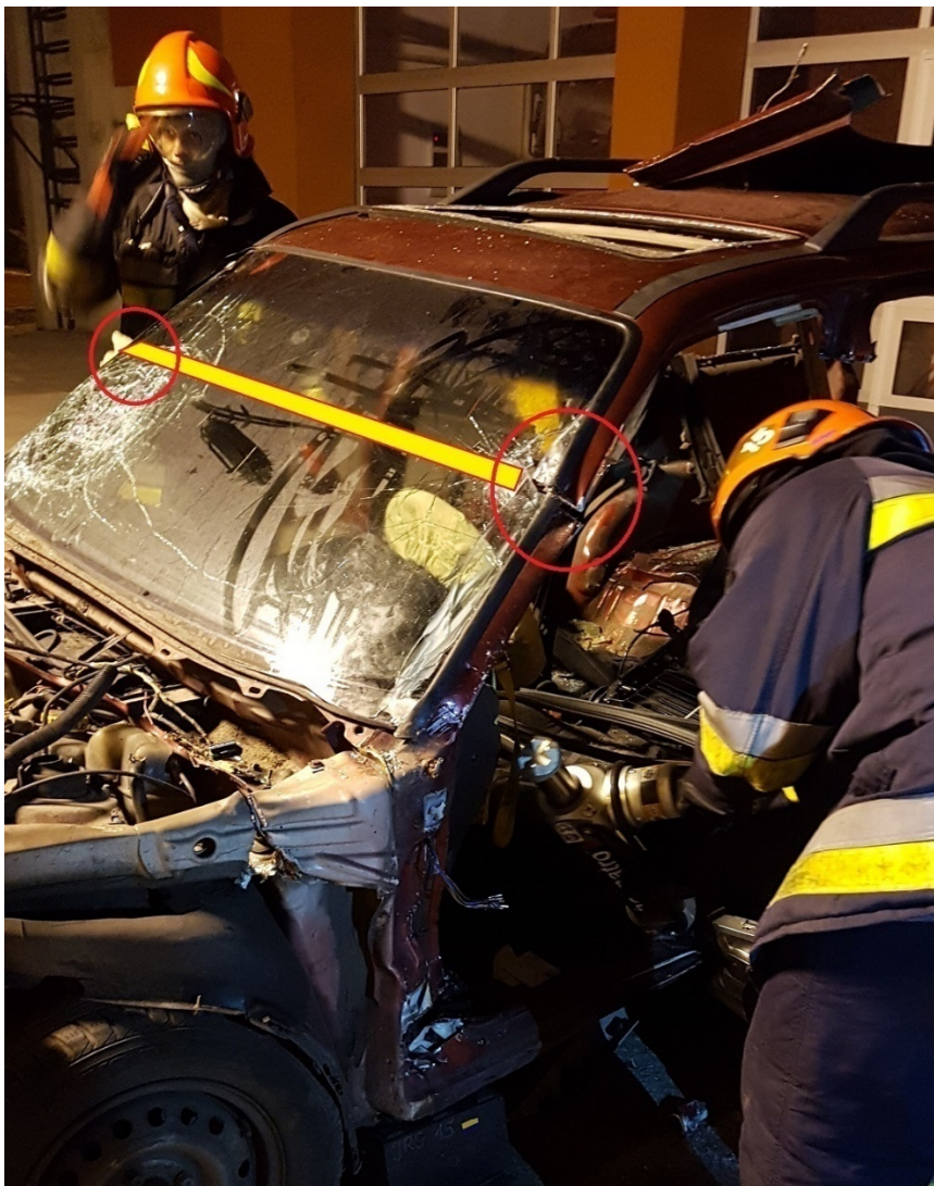
Rys. 184. Jedno cięcie odprężające szyby przedniej wykonane na wysokości przecięcia słupka A
