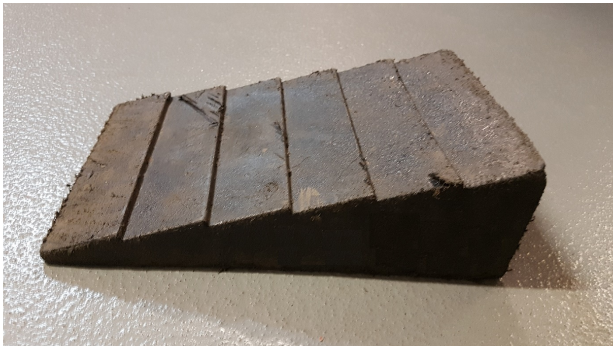
Rys. 154. Klin stroną płaską osadzamy na powierzchniach twardych (asfalt, beton)
