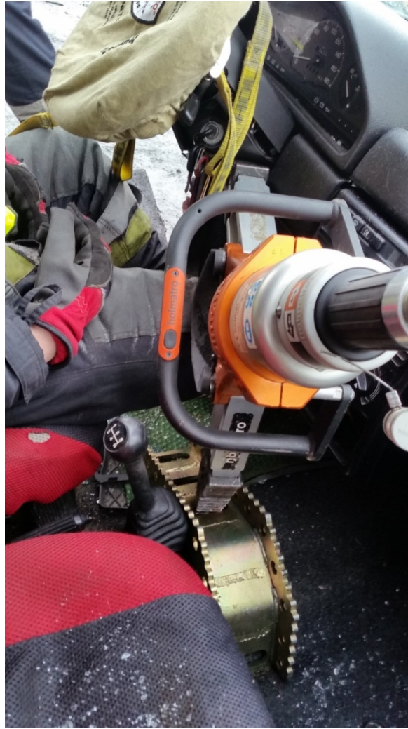
Rys. 199. Podniesienie kolumny kierownicy od strony pasażera poprzez wyparcie o odwrócony wspornik progowy. To zyskanie kilku dodatkowych centymetrów przy krótszych ramionach rozpieraczy oraz uniknięcia ryzyka zaingerowania w sterownik systemu SRS
