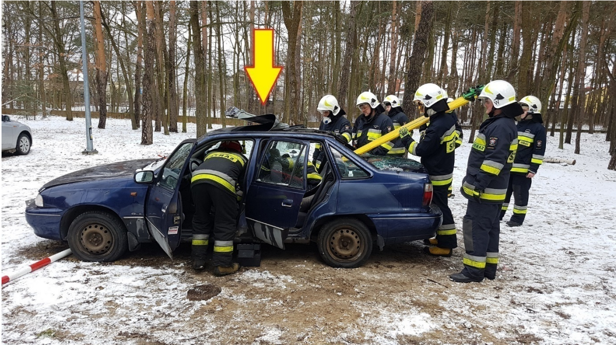
Rys. 289. Widoczne odgięcie dachu ku przodowi i wstawienie noszy typu deska pod odpowiednim kątem UWAGA: W przypadku posiadania przez zespół ratowniczy osłon na ostre krawędzie, należy je bezwzględnie stosować!!!
