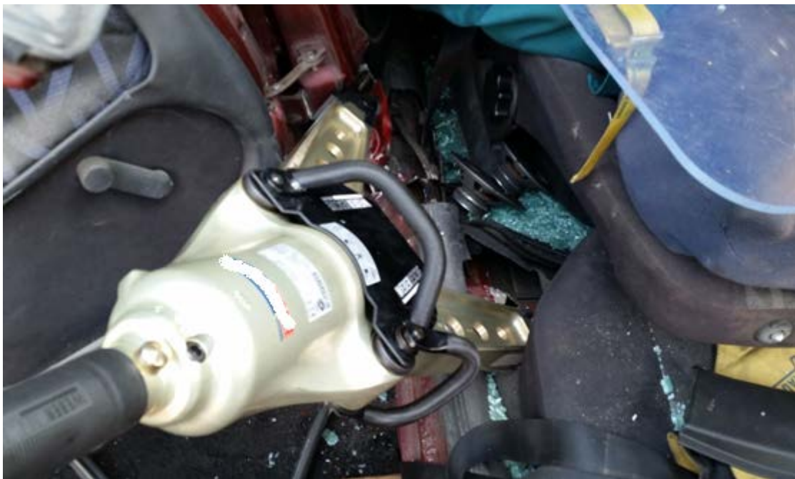
Rys. 255. Wyrwanie słupka C od progu przy pomocy rozpieracza
