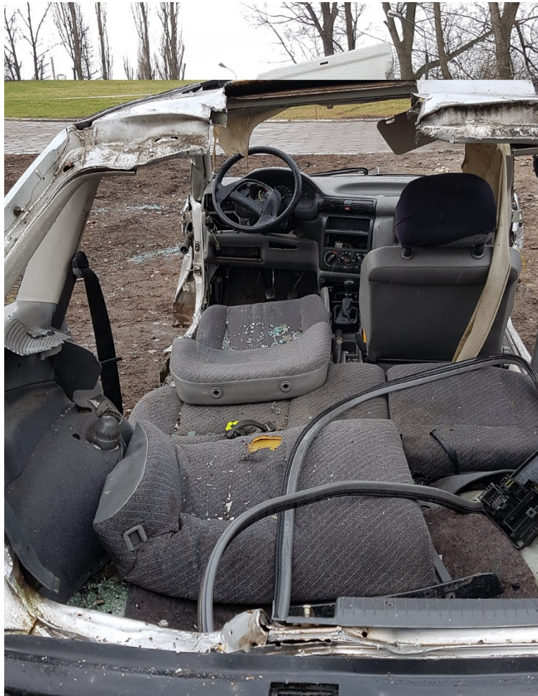
Rys. 280. Jakość dostępu do osoby poszkodowanej w jej osi kręgosłupa po wykonaniu techniki tunelowania
