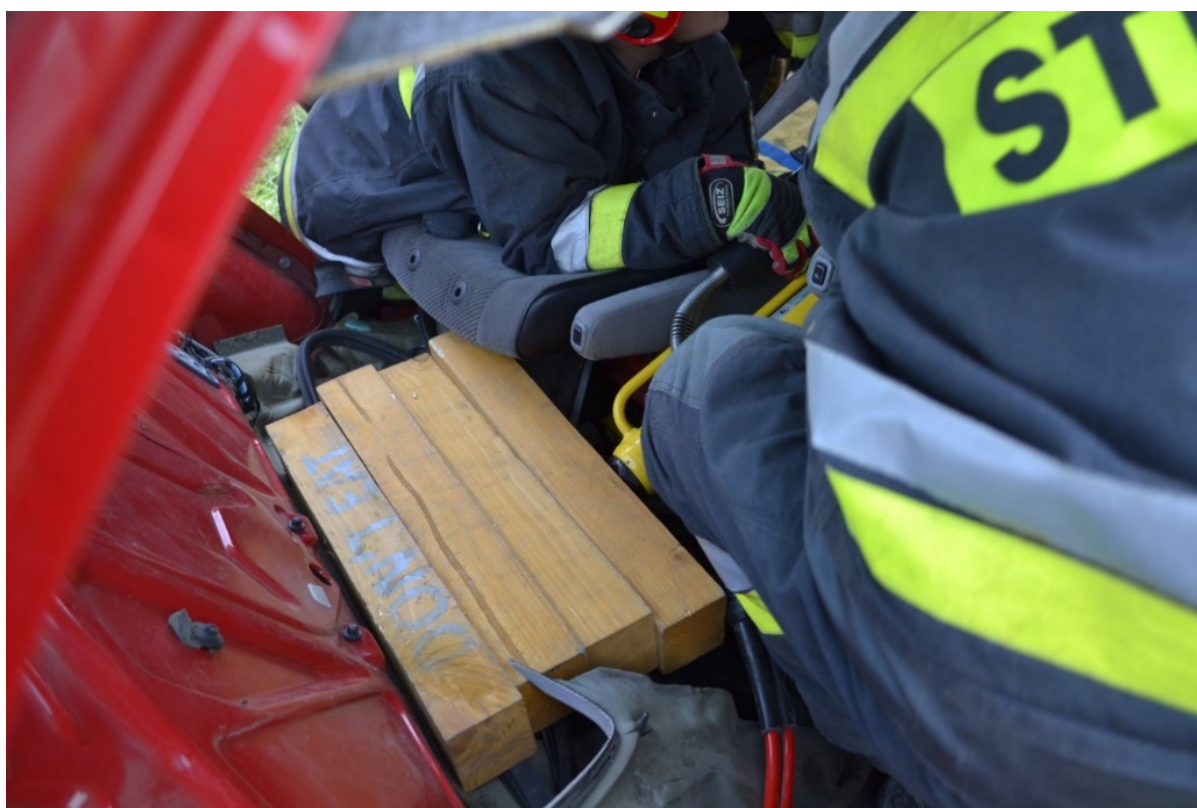
Rys. 205. Wyparcie cylindra rozpierającego między siedzeniami, osadzonego na podbudowie z drewna
