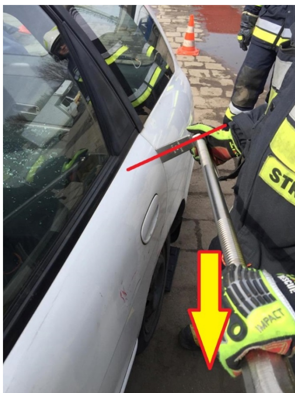
Rys. 245 A, B. Powiększanie szczeliny przez obrót narzędzia
