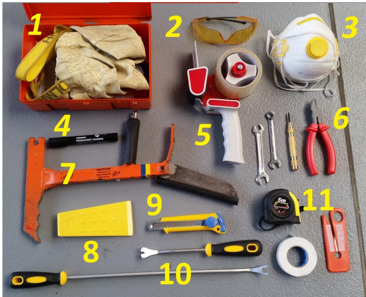
1 – Osłona na kierownicę. 2 – Okulary ochronne. 3 – Maski pyłowe. 4 – Marker. 5 – Oklejarka. 6 – Klucze płasko-oczkowe, zbijak, cęgi boczne. 7 – Piła do szyb. 8 – Klin z tworzywa. 9 – Nóż. 10 – Chwytniki tapicerskie. 11 – Nóż do pasów, taśma izolacyjna, taśma miernicza
