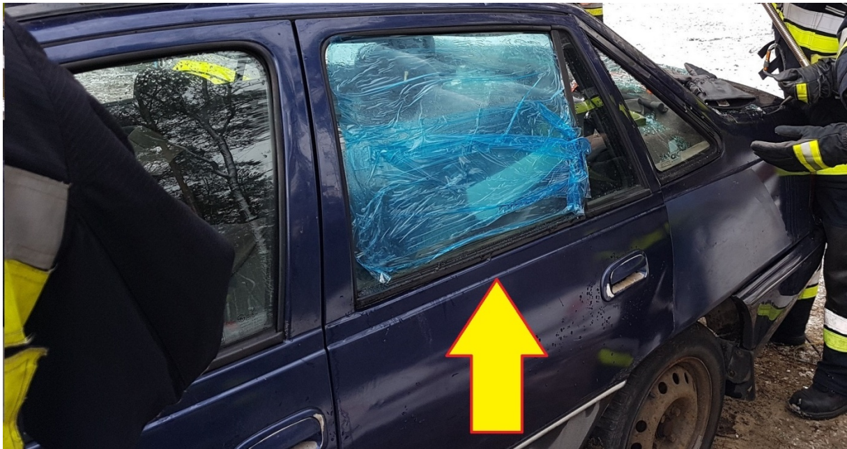
Rys. 190. Oklejenie szyby przylegającą folią
