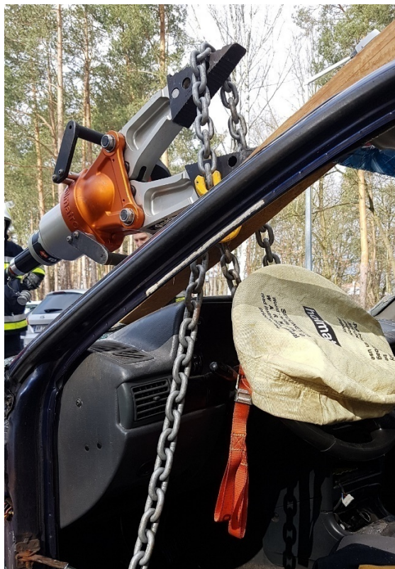
Rys. 215. Bezpieczny sposób podnoszenia kolumny kierownicy przy pomocy deski kantówki, łańcuchów i rozpieracza. Siła ciągnąca musi być skierowana idealnie w pionie
