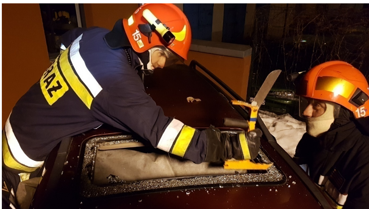
Rys. 192. Całe szkło z szyberdachu opada na płachtę, którą następnie usuwa się z pojazdu
