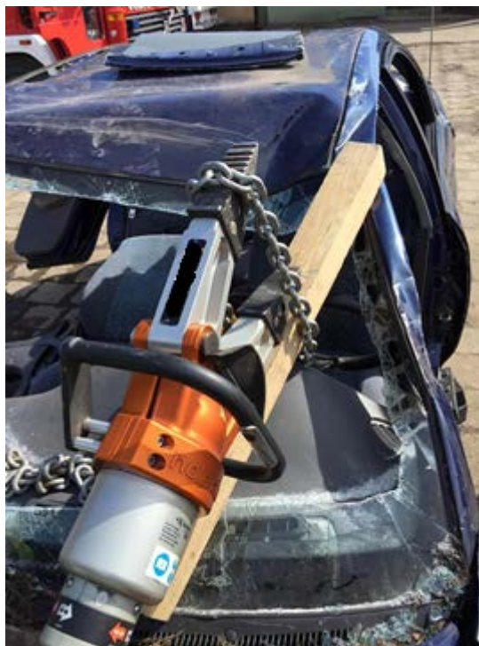
Rys. 216. Przesunięcie deski kantówki na łączenie dachu ze słupkiem A w przypadku niewzmocnionych konstrukcji. Zachowana zasada podnoszenia kolumny kierownicy w pionie
