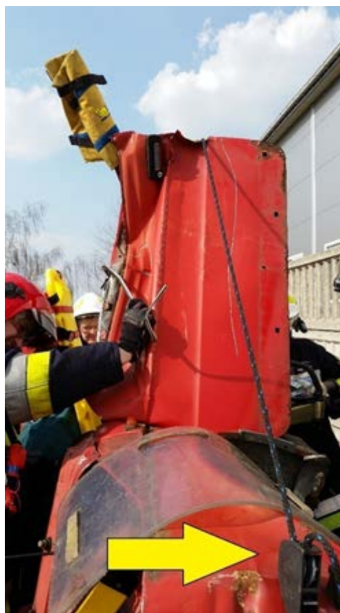
Rys. 301. Trudne operowanie narzędziami hydraulicznymi przy dostępie od góry. Nosze typu deska zastosowano jedynie do wstępnej stabilizacji kręgosłupa osoby poszkodowanej, a nie celem ewakuacji do góry
