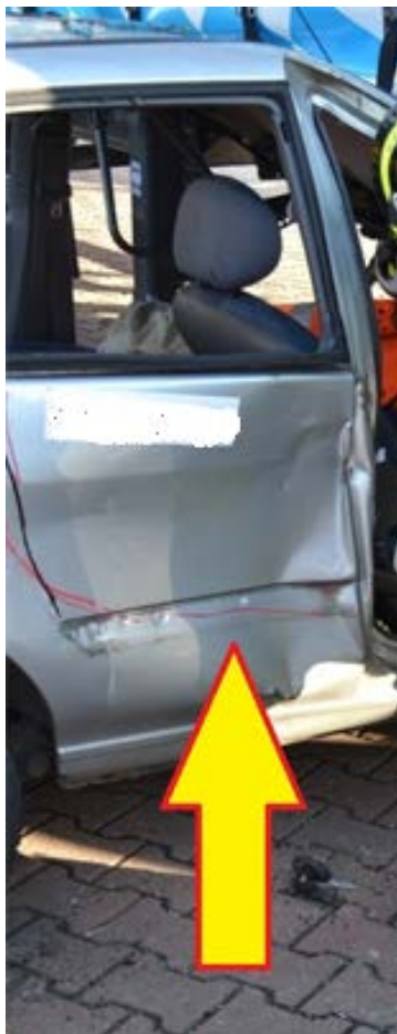
Rys. 271. Metoda „trzecich drzwi”. Cięcie wykonywane piłą szablą
