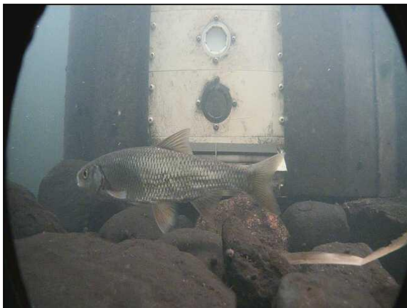
Ryc. 27. Na zdjęciu jelec - to typowy przedstawiciel ryb obligatoryjnie rzecznych, przechodzący między płytami skanera przepławki w łobzie, w tle widoczne otwory wyposażone w kamery (udostępnione przez Escort Sp. z o. o.)
