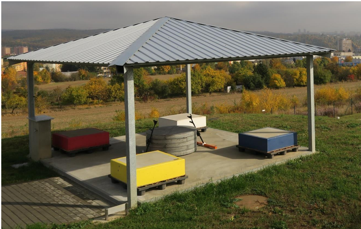
Figura 8.3 Transportowalne wzorce kalibracyjne K, U, Th i BG do kalibracji ręcznych spektrometrów gamma (zdjęcie pochodzi ze strony www.gfinstruments.cz ).
