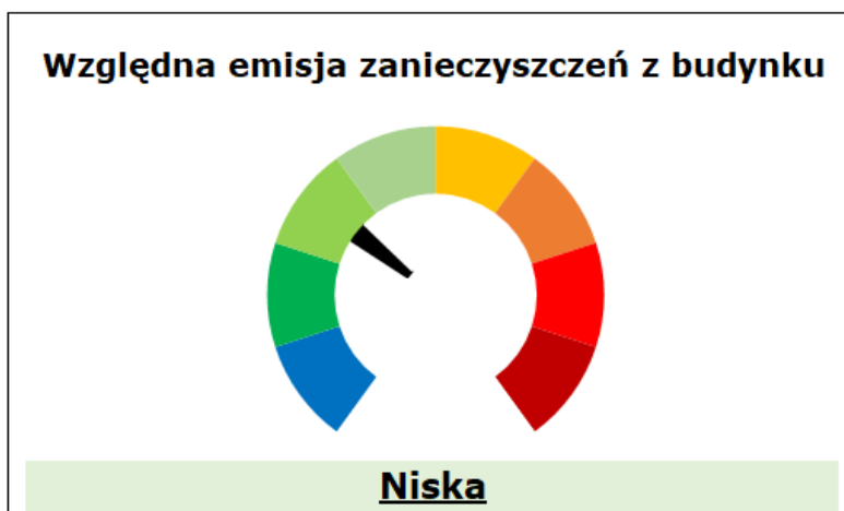
Rysunek 42. Przykładowy sposób prezentacji oceny zintegrowanego wskaźnika względnej emisji na świadectwie charakterystyki energetycznym
