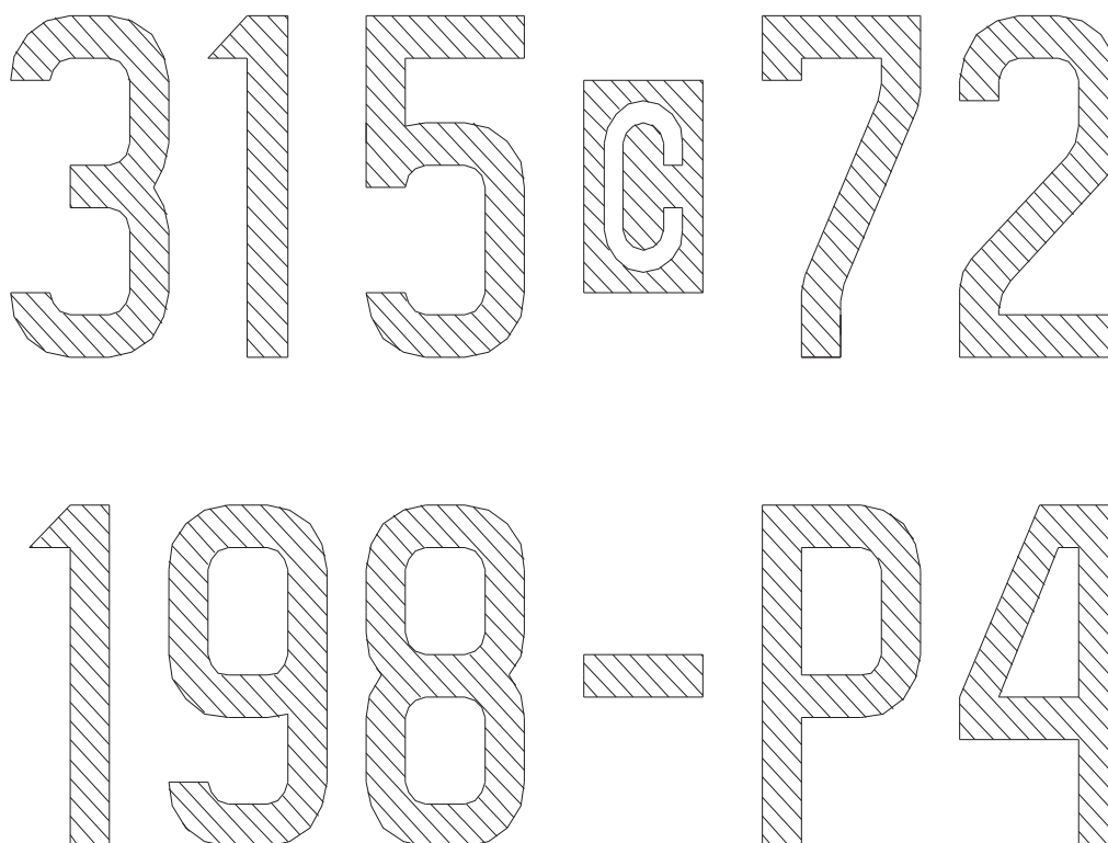
Rysunek nr 2. Wygląd numeru operacyjnego (samochód) i numeru na sprzęcie (przyczepa)
