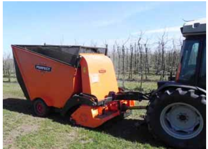
Fot. 2.: Odkurzacz do liści (Firma PERFECT) używany do usuwania opadłych liści z pasów drzew jesienią (Fot.: B. Benduhn, luty 2014)
