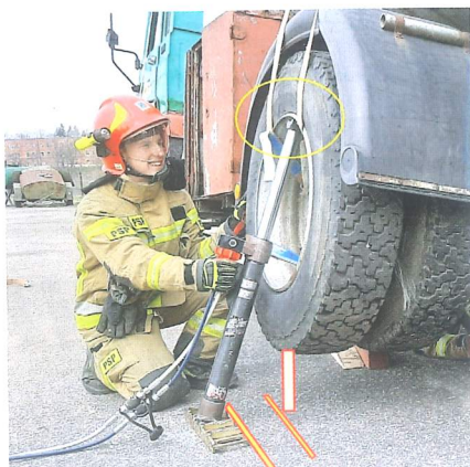
Optymalne i bezpieczne ustawienia cylindra rozpierającego: wspornik 10 cm od brzegu opony, głowica górna cylindra w całości wsparta o powierzchnię felgi, za rantem fot. Rafał Podlasiński
