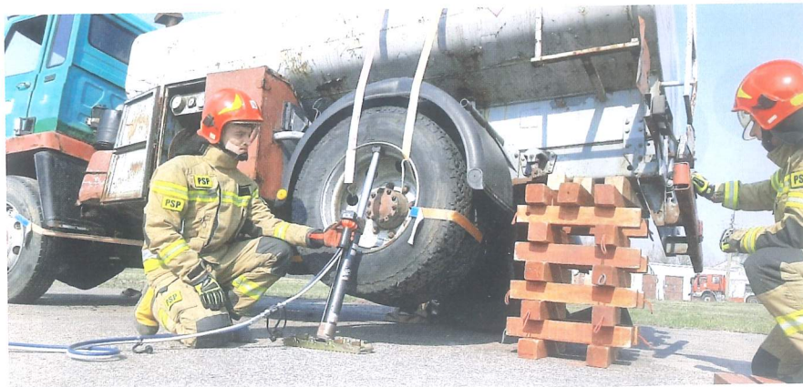
Podnoszenie koła za felgę wklęsłą z jednoczesną stabilizacją wspomagającą pod ramą pojazdu – duża przestrzeń pod oboma kołami bliźniaczymi i pod osią pojazdu fot. Rafał Podlasiński
