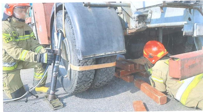
Podnoszenie koła za felgę wklęsłą z jednoczesną stabilizacją wspomagającą pod osią (w miarę możliwości jak najbliższej podnoszonego koła) fot. Rafał Podlasiński
