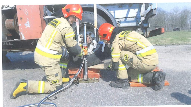
Ciąg dalszy podnoszenia koła za felgę wklęsłą z jednoczesną stabilizacją wspomagającą pod zewnętrznym kołem bliźniaczym – duża przestrzeń pod wewnętrznym kołem bliźniaczym pojazdu oraz osią fot. Rafał Podlasiński
