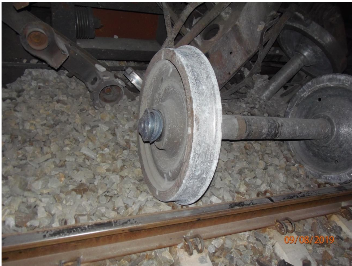
Zdjęcie 3 -Uszkodzony zestaw kołowy nr 5249978 wagonu nr 31 51 5496 893-9 po zdarzeniu (fot. PKBWK)
